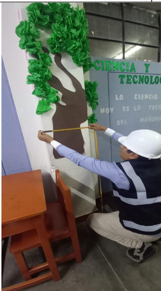
Fotografía 6 Vista interna del aula, procedemos a recopilar datos, realizando la medición del portico con ayuda de un flexometro, tanto de columnas, vigas y muros.
