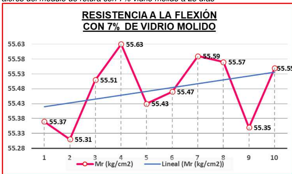
Figura 9 Valores del módulo de rotura con 7% vidrio molido a 28 días
