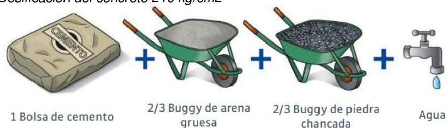
Figura 1 Dosificación del concreto 210 kg/cm 2
