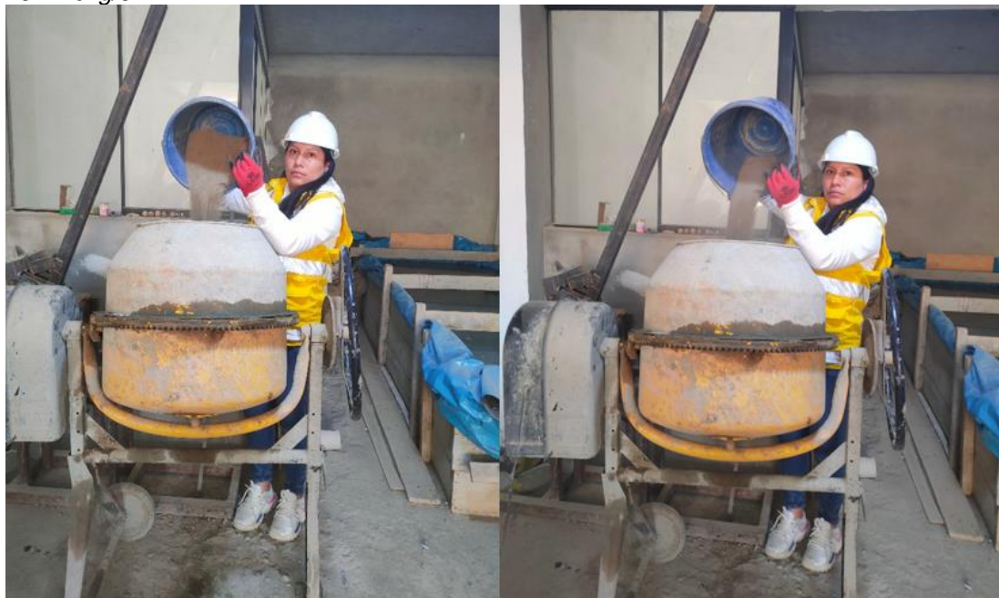
Figura 26 Adición del agregado fino al trompo para la elaboración de la mezcla de concreto f'c=210\text{kg/cm}^2
