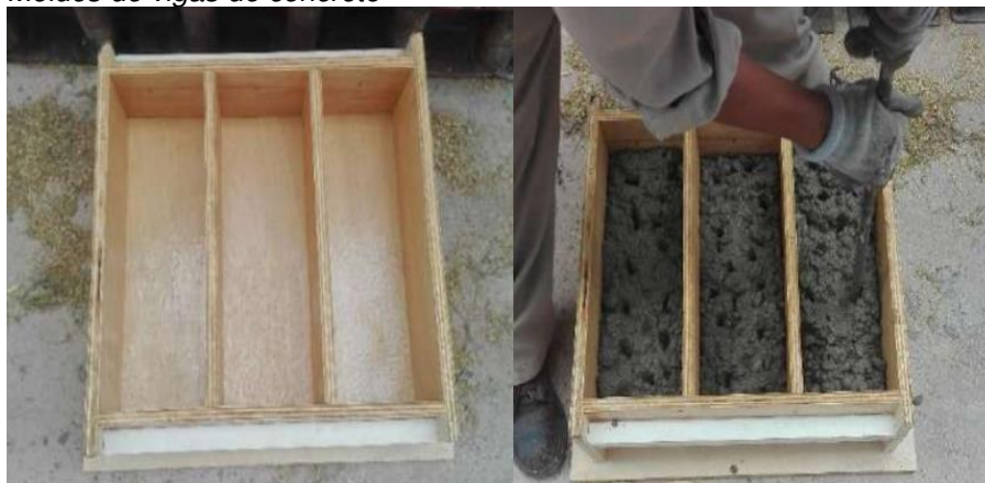
Figura 4 Moldes de vigas de concreto
