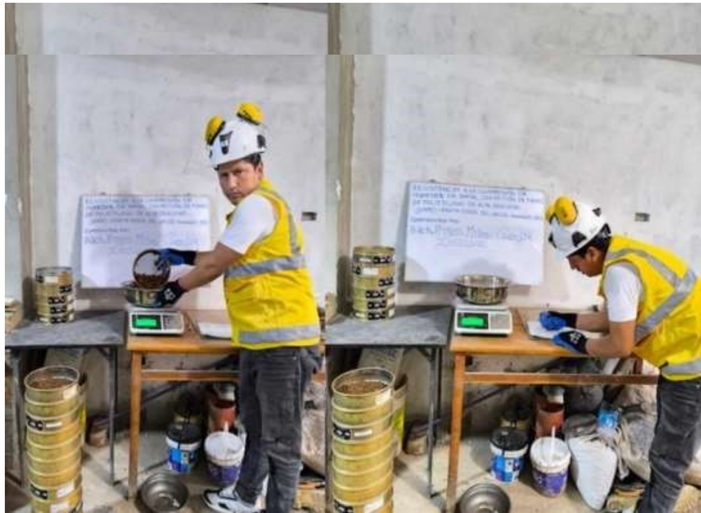
Figura 9 Selección y pesaje de tierra que se quedó retenido en el tamiz grueso
