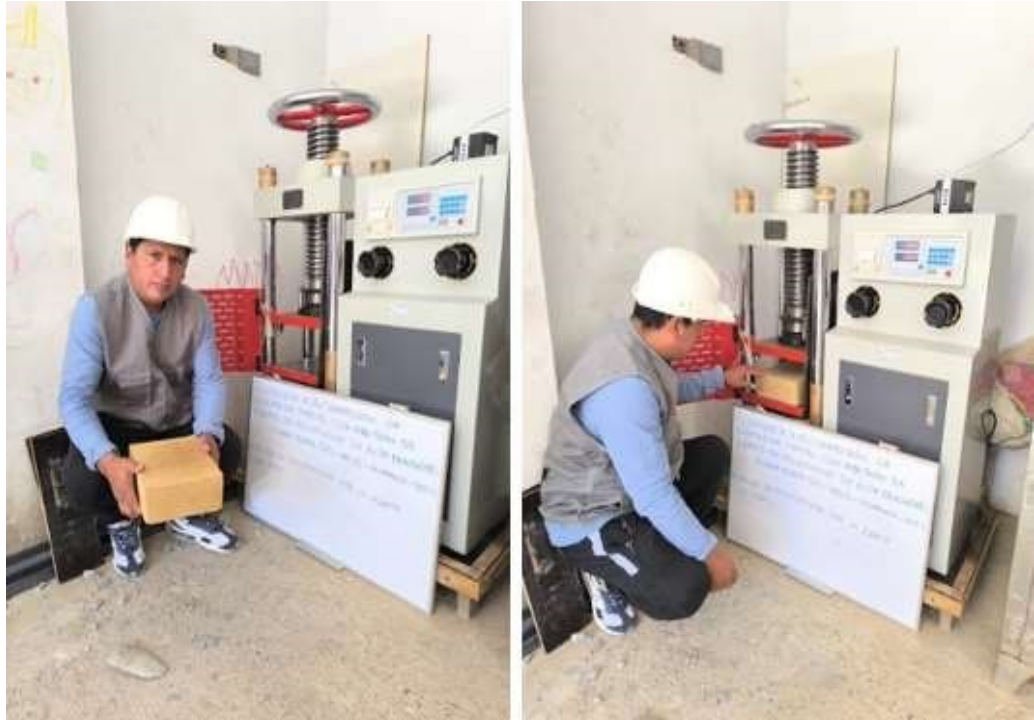
Figura 42 Muestra de muretes de tapial por el lado más débil
