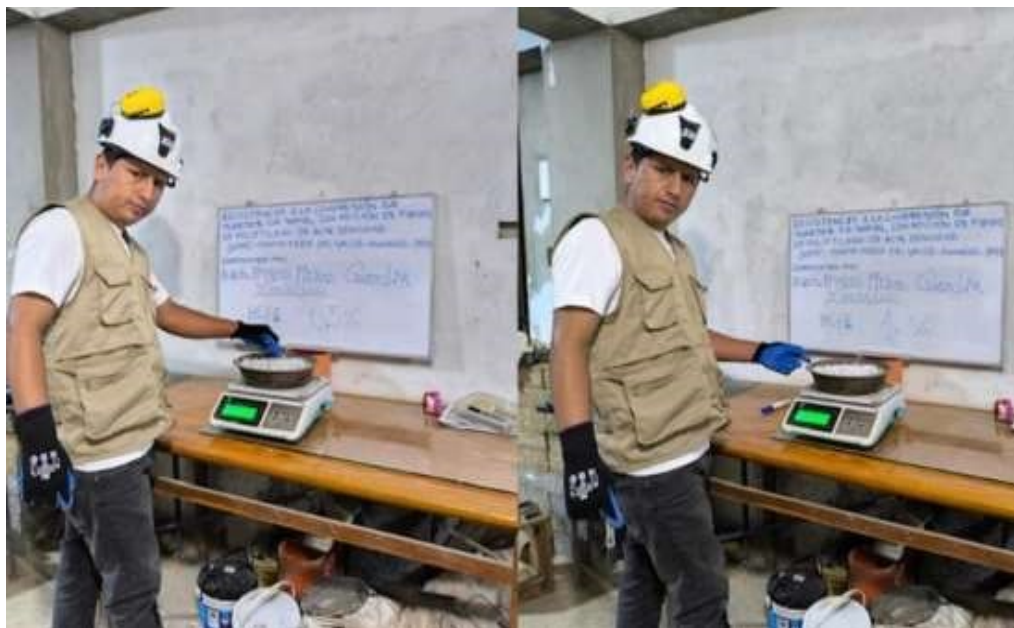
Figura 25 Pesaje del polietileno de alta densidad en un 0.5% y 1% respecto al peso seco de la muestra
