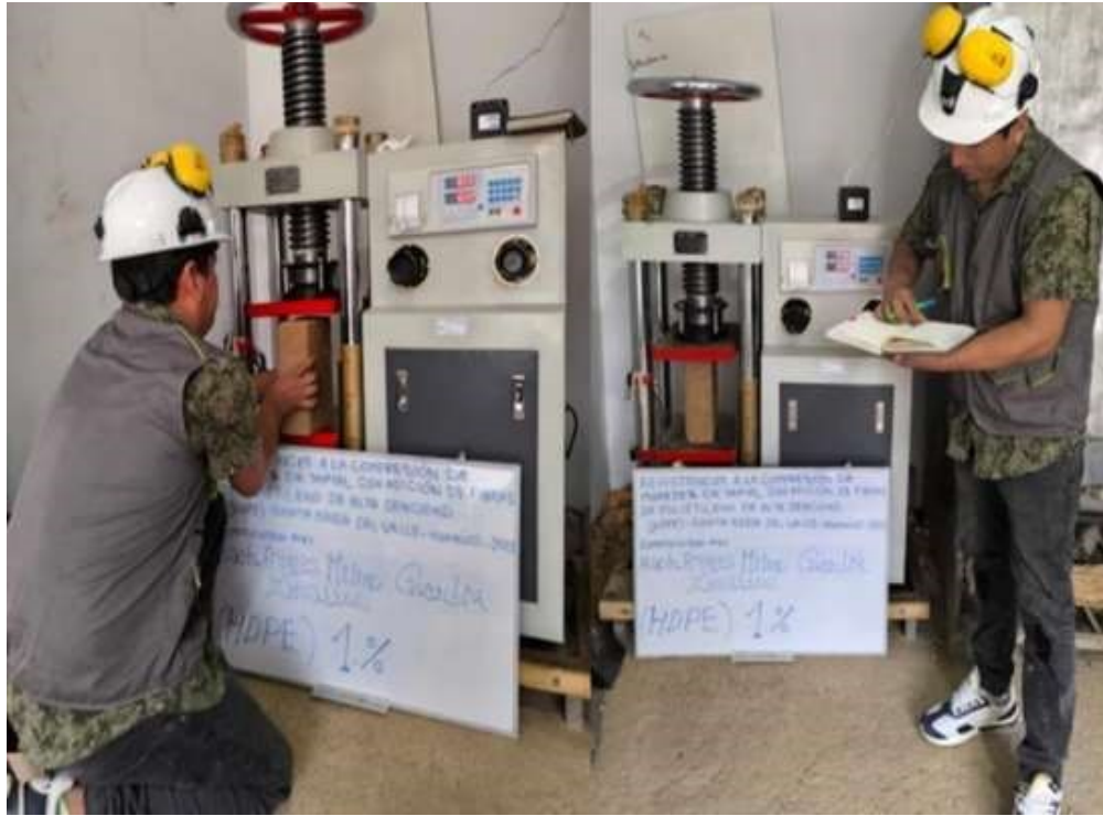
Figura 38 Ensayo de compresión sobre muretes de tapial con 1% de PEAD
