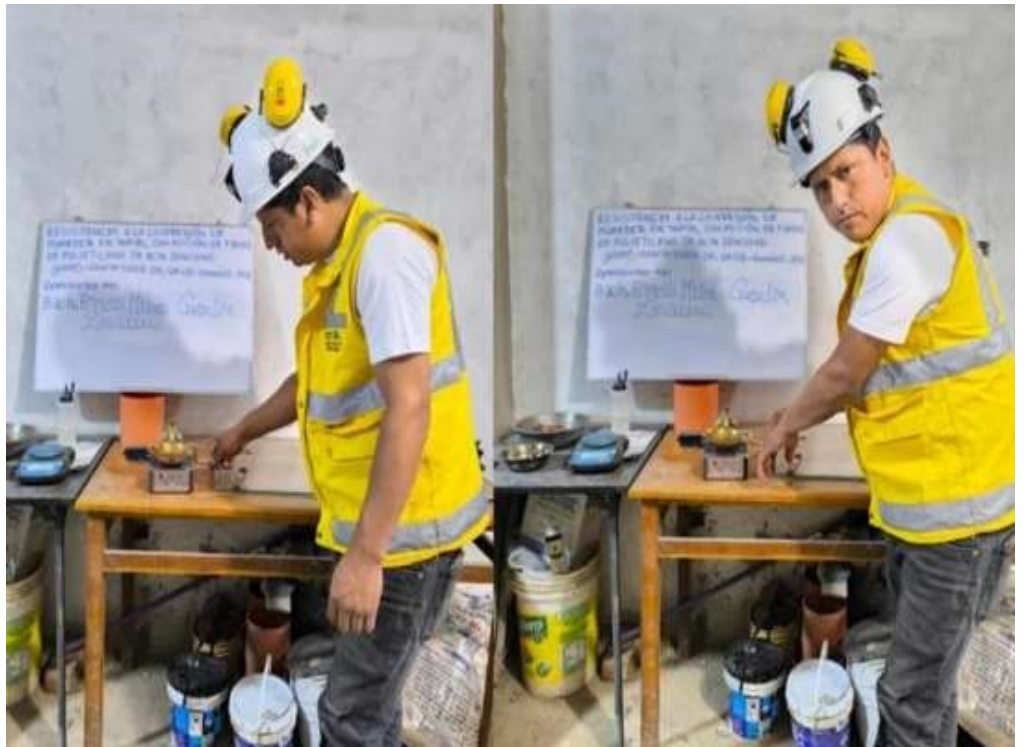
Figura 18 Se realiza los golpes en la copa Casagrande
