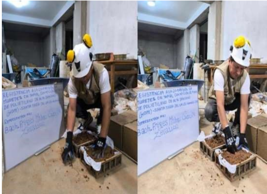
Figura 30 Elaboración de los muretes de tapial con medidas de 9 x 20 x 27 cm
