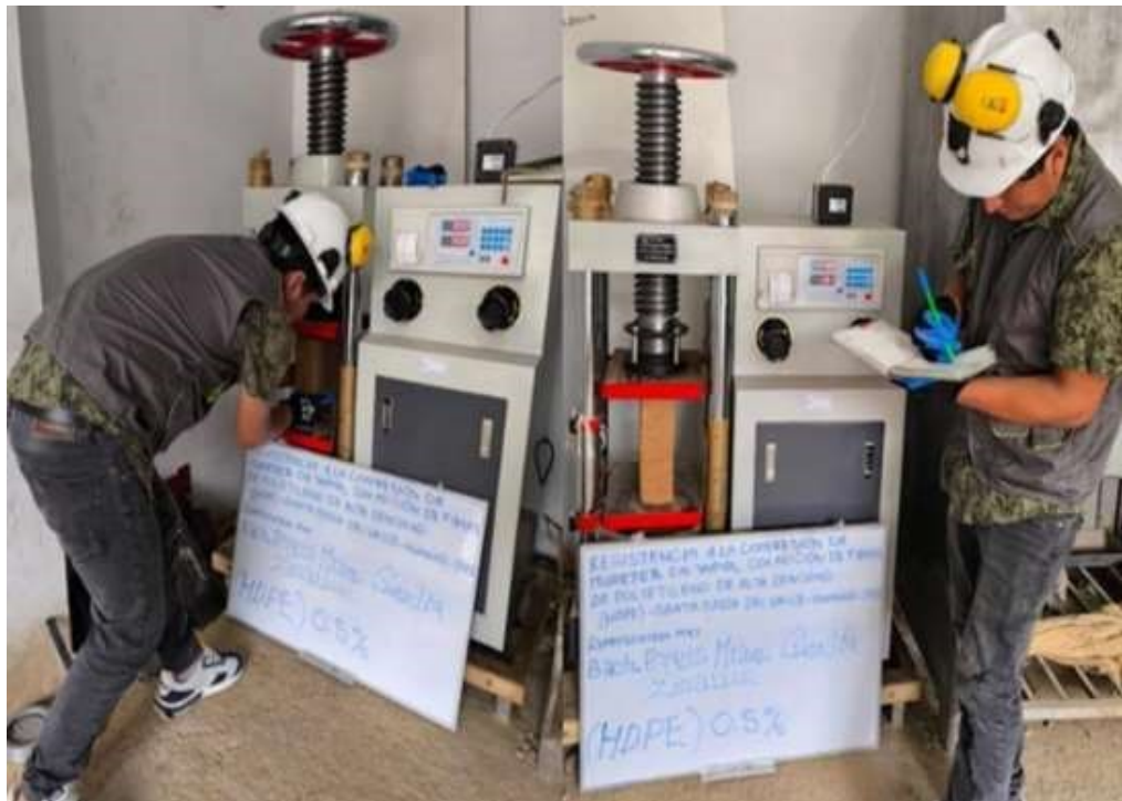
Figura 36 Ensayo de compresión sobre muretes de tapial con 0.5% de PEAD
