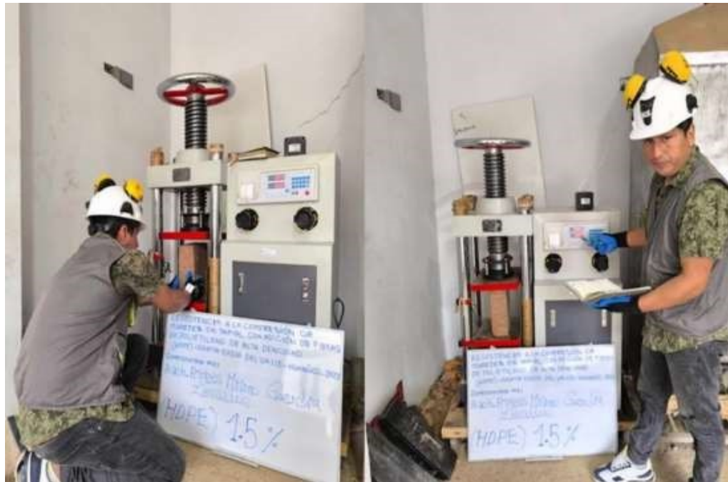
Figura 40 Ensayo de compresión de los muretes de tapial con 1.5% de PEAD
