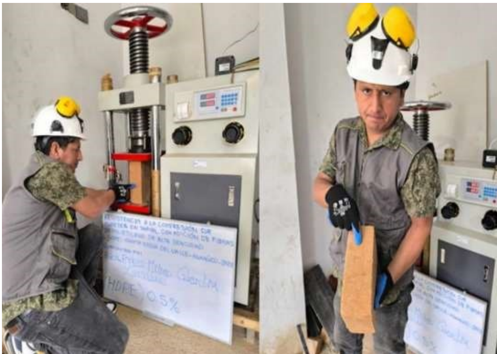
Figura 37 Rotura de los muretes de tapial con 0.5% de PEAD
