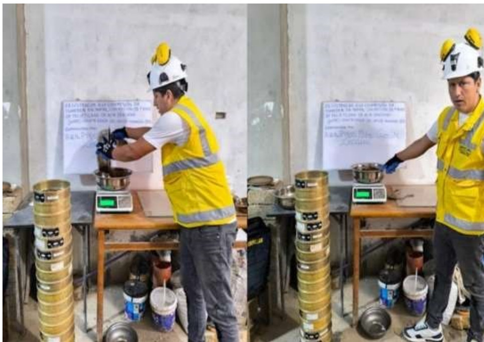
Figura 6 Pesaje de la tierra para realizar la granulometría
