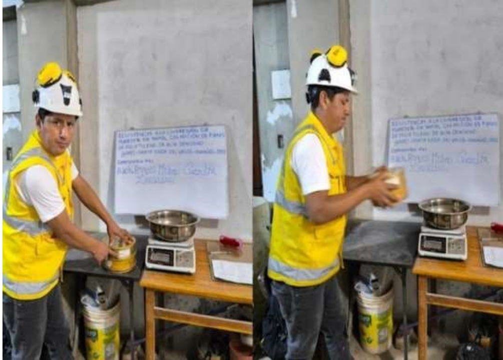
Figura 13 Se realiza el vibrado del tamiz N° 40
