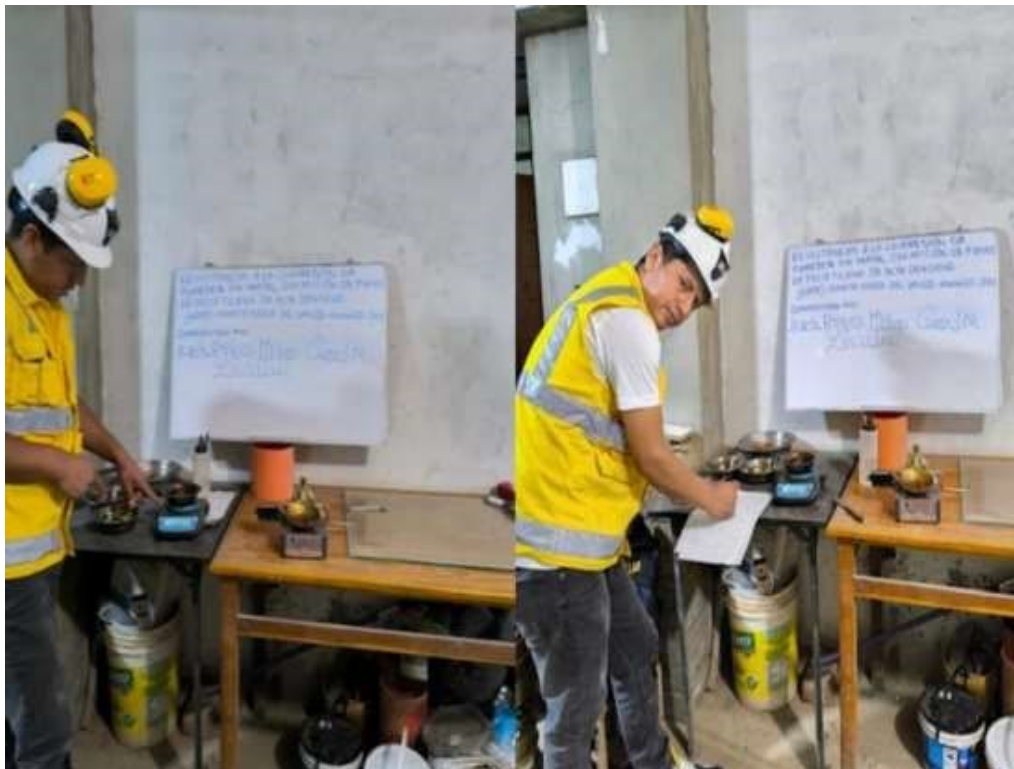
Figura 20 Se realiza el pesaje de la muestra de suelo
