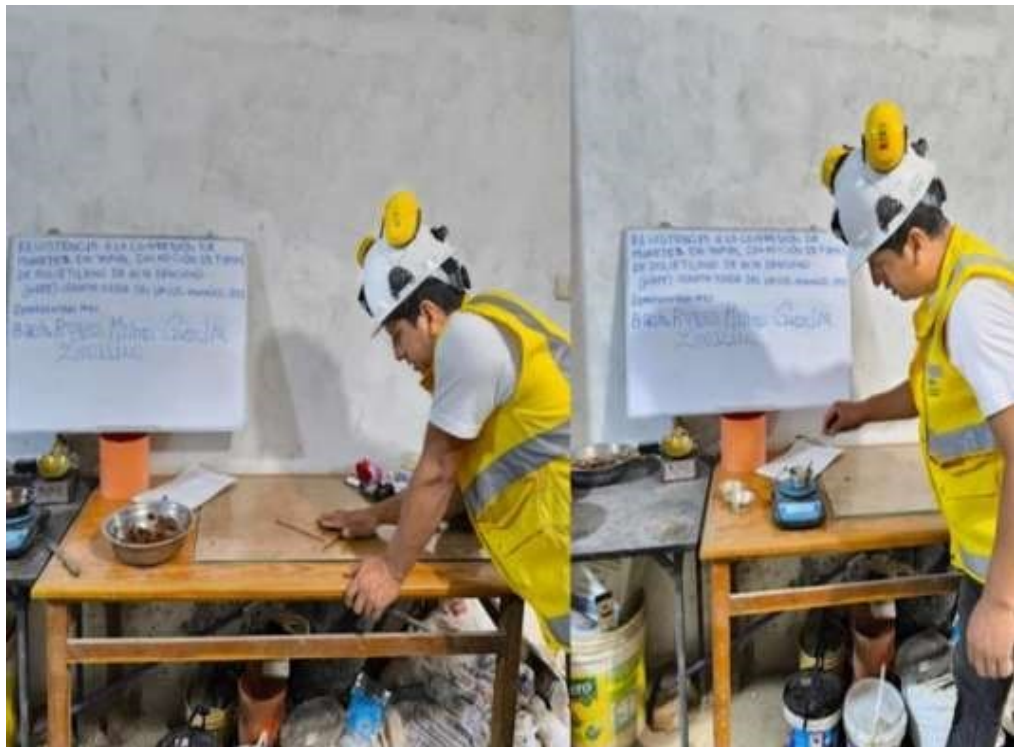
Figura 21 Ensayo de límite plástico del suelo
