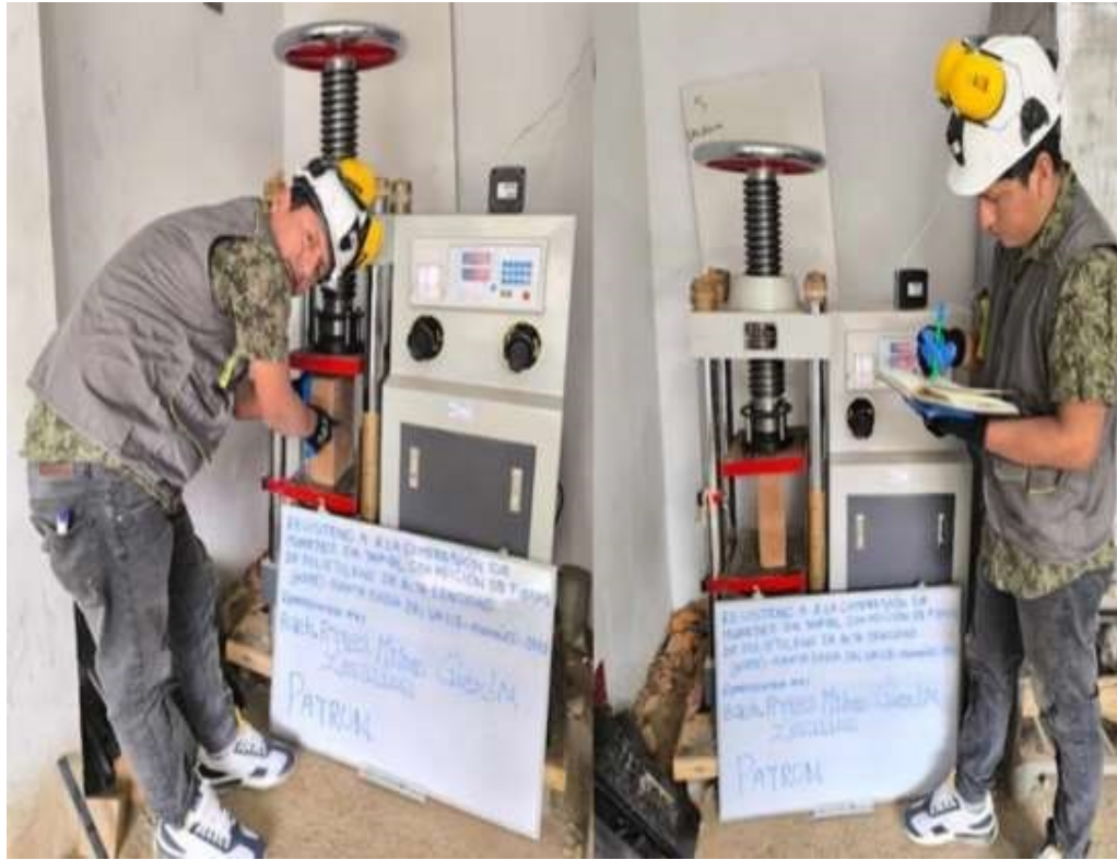
Figura 34 Ensayo de compresión sobre muretes de tapial (Patrón)
