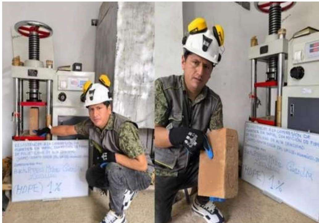
Figura 39 Rotura de los muretes de tapial con 1% de PEAD
