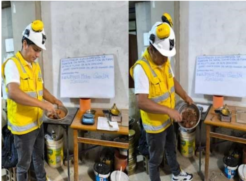
Figura 15 Preparación de la muestra de suelo para el ensayo de Casagrande
