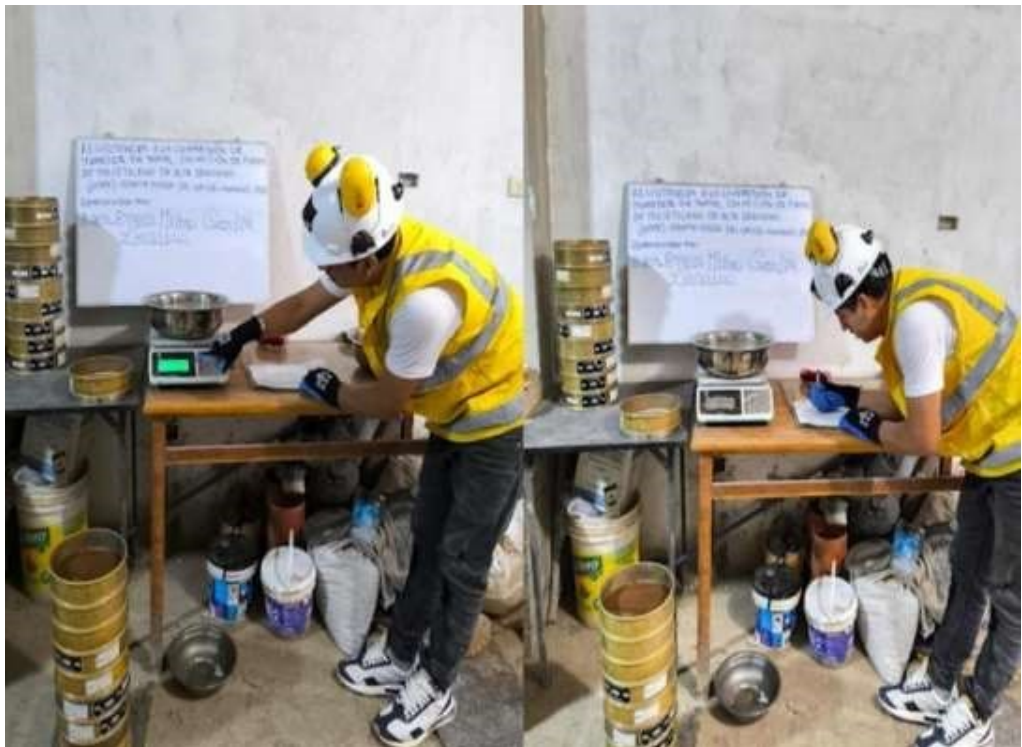
Figura 12 Se realiza los apuntes de peso de tierra retenido en los tamices
