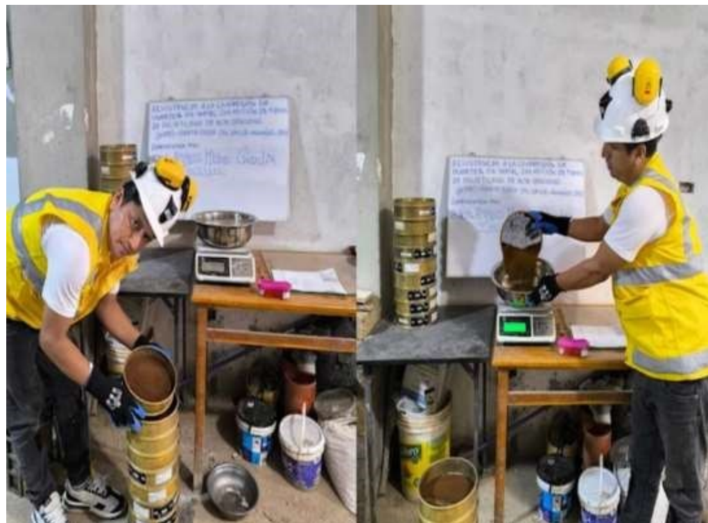
Figura 10 Selección y pesaje de tierra que se quedó retenido en el tamiz
