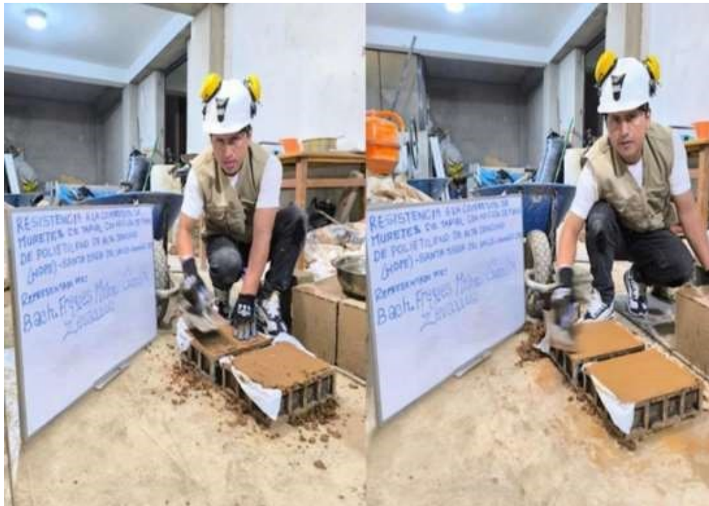
Figura 31 Enrazado de los muretes de tapial
