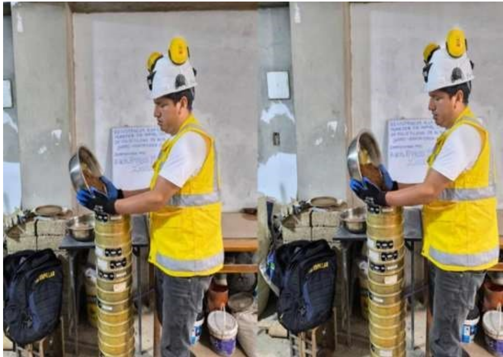
Figura 7 Se realiza el echado de la tierra a los tamices
