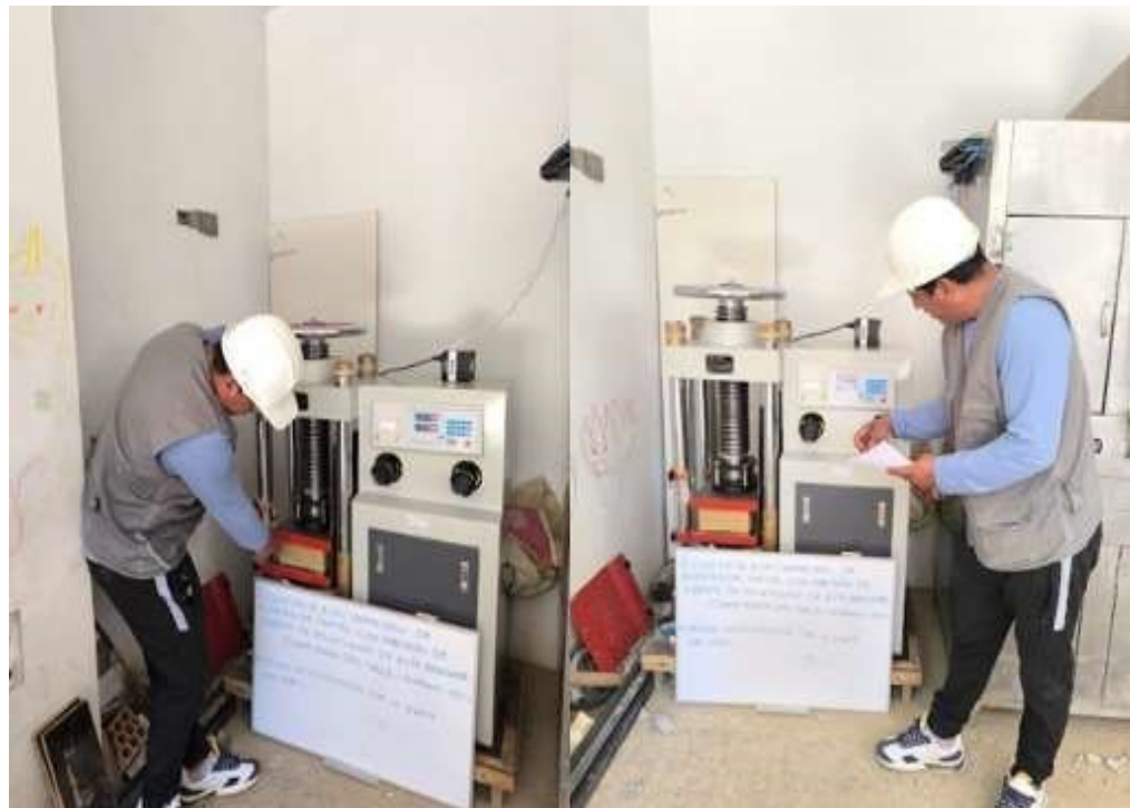
Figura 43 Colocación de las muestras de muretes de tapial en la máquina de ensayo
