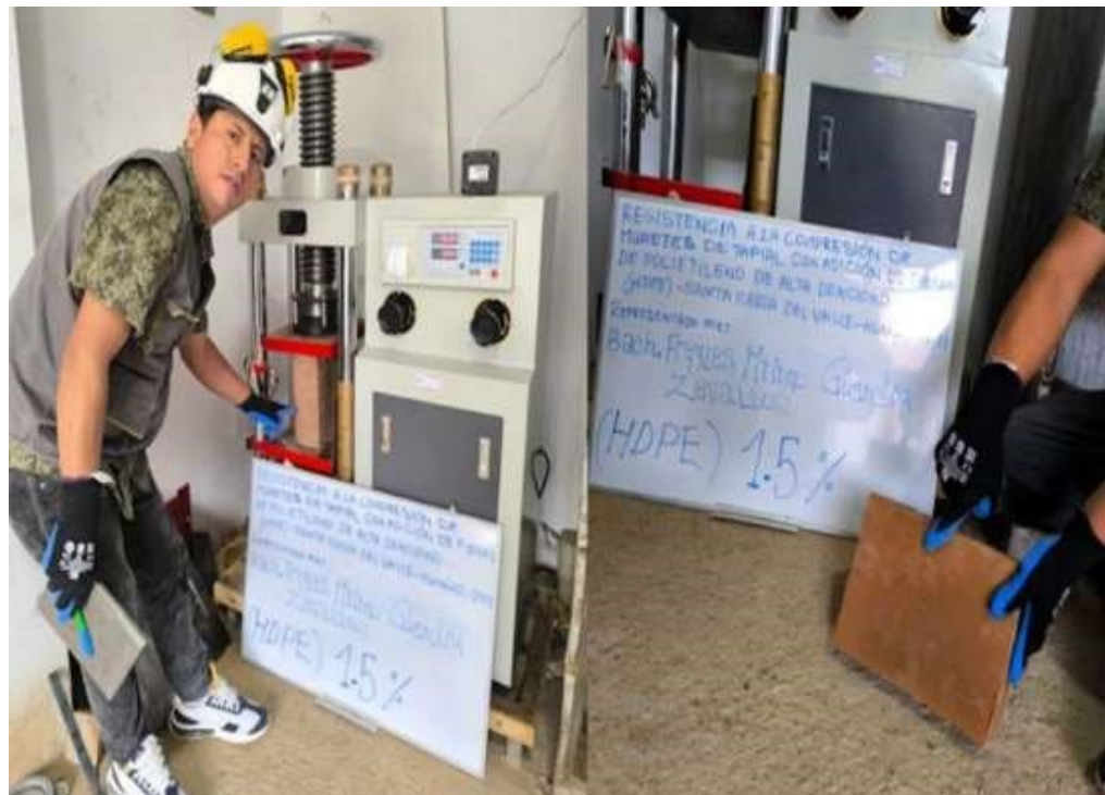
Figura 41 Rotura de los muretes de tapial con 1.5% de PEAD
