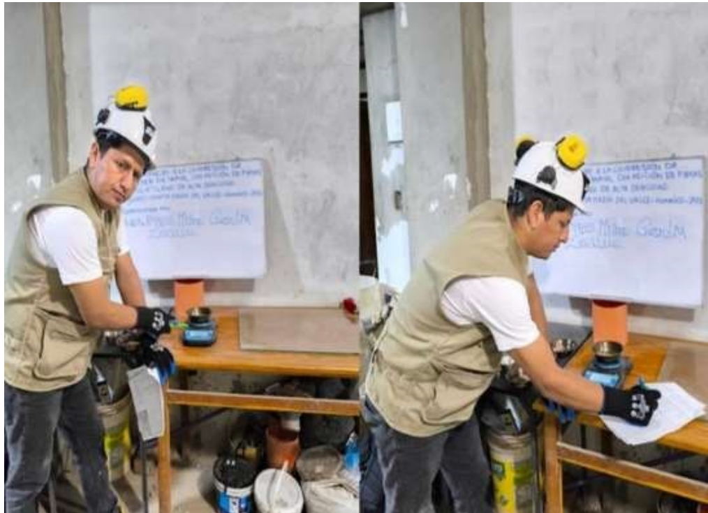
Figura 23 Pesaje de las muestras secas para determinar su límite plástico
