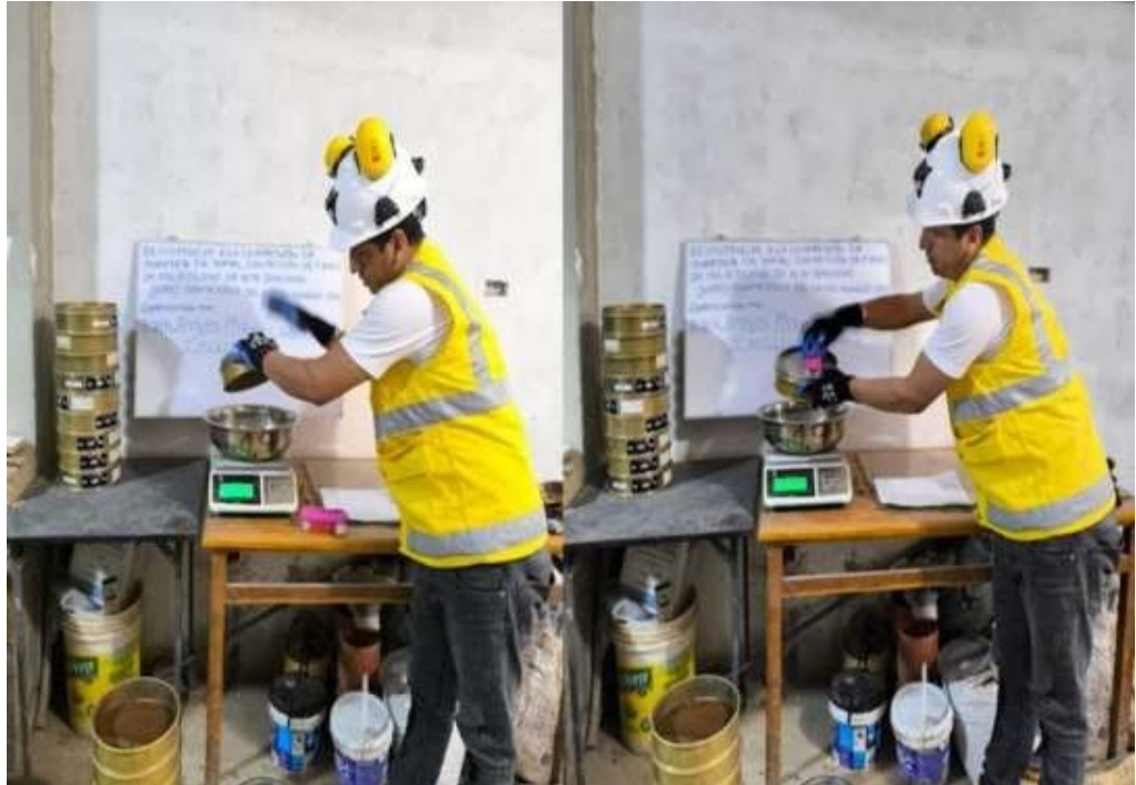
Figura 11 Se realiza el lavado del tamiz
