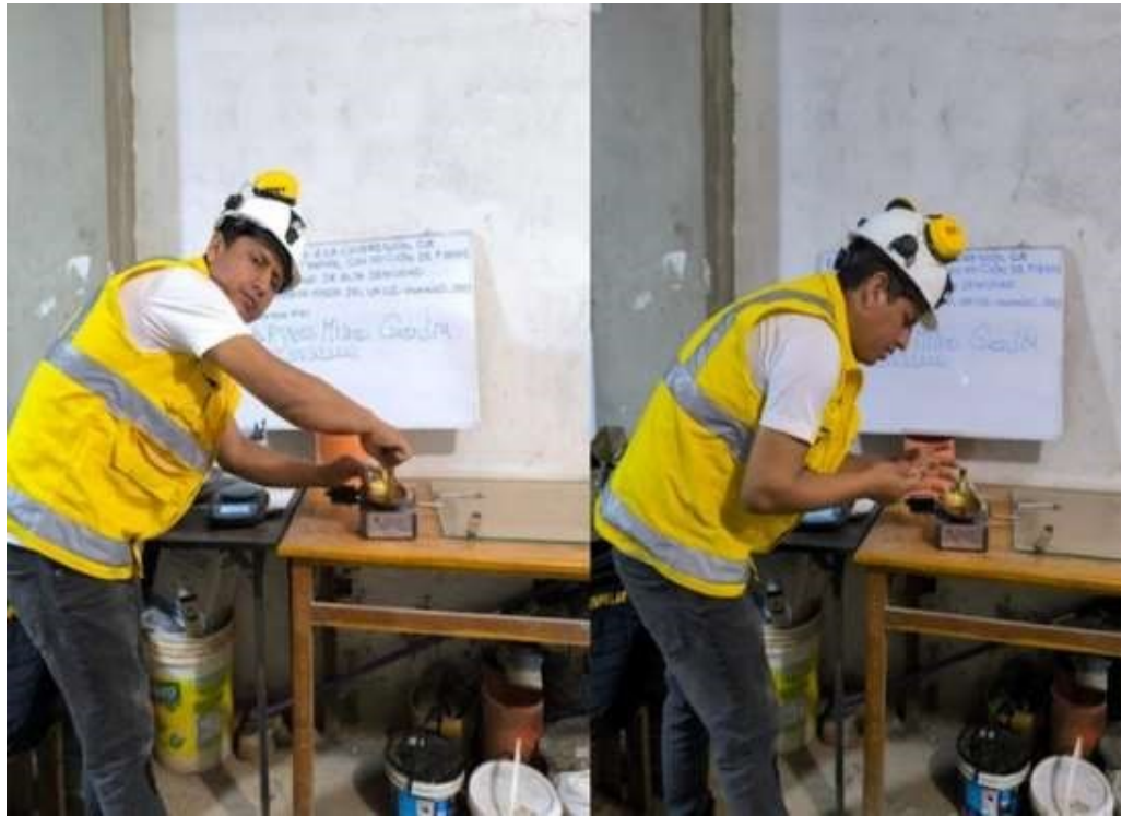
Figura 17 Trazo de hendidura con el acanalador de bronce
