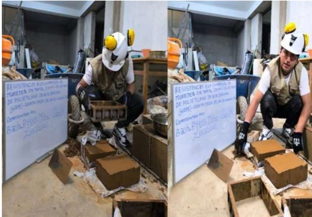
Figura 32 Desmoldeo de las muestras de muretes de tapial
