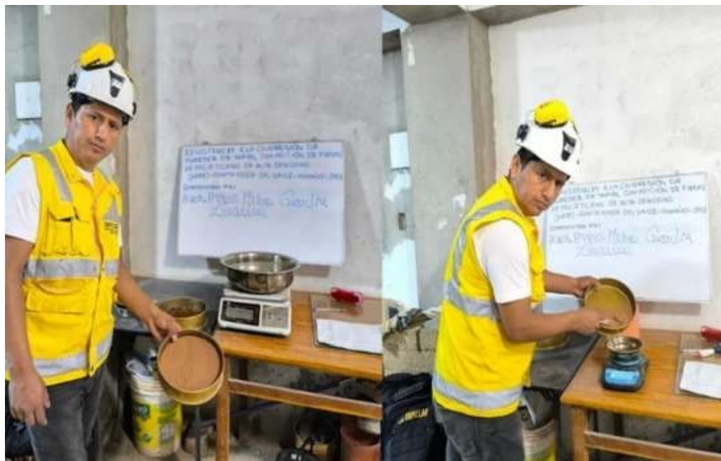
Figura 14 Pesaje de tierra obtenida en la cazoleta
