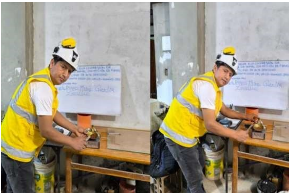
Figura 16 Llenado de muestra a la cuchara de Casagrande
