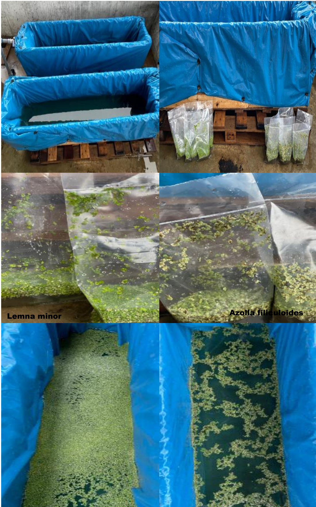
Vista fotográfica N°2, de la colocación de plantas acuáticas para la remediación.
