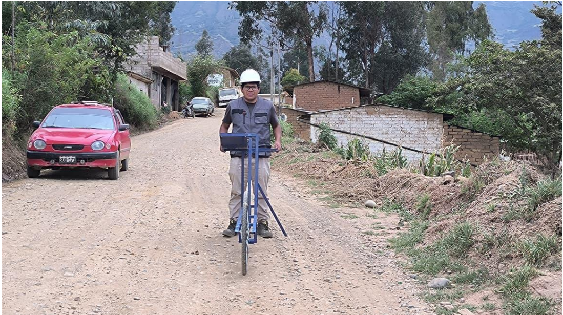
Tesista con el rugosímetro de la Rueda de Merlín registrando valores para la verificación de los valores del IRI
