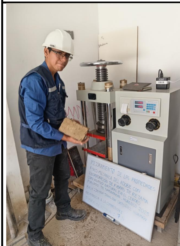
Iniciando el análisis de compresión del adobe con 7% de incorporación de retama.
