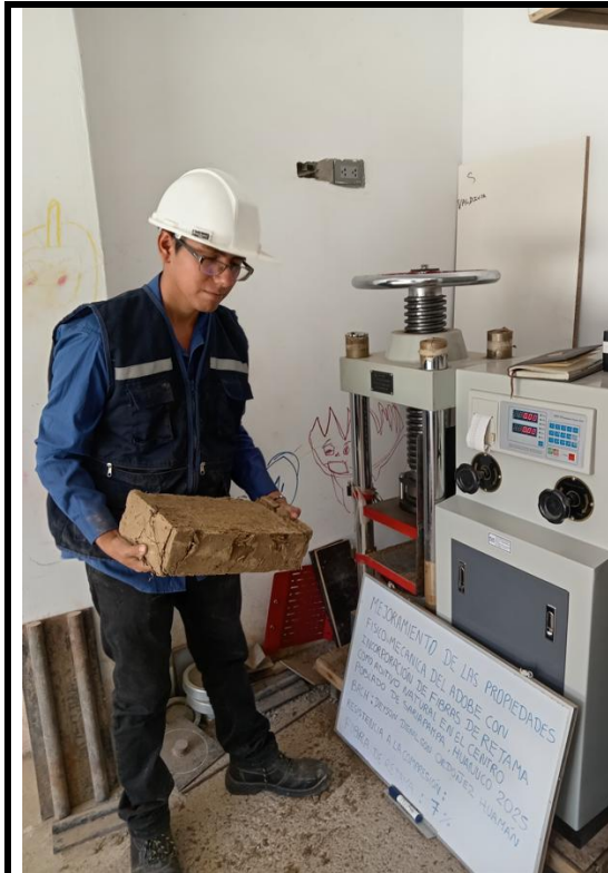
Se muestra como quedo después de la compresión el adobe con 7% de incorporación de fibra de retama.
