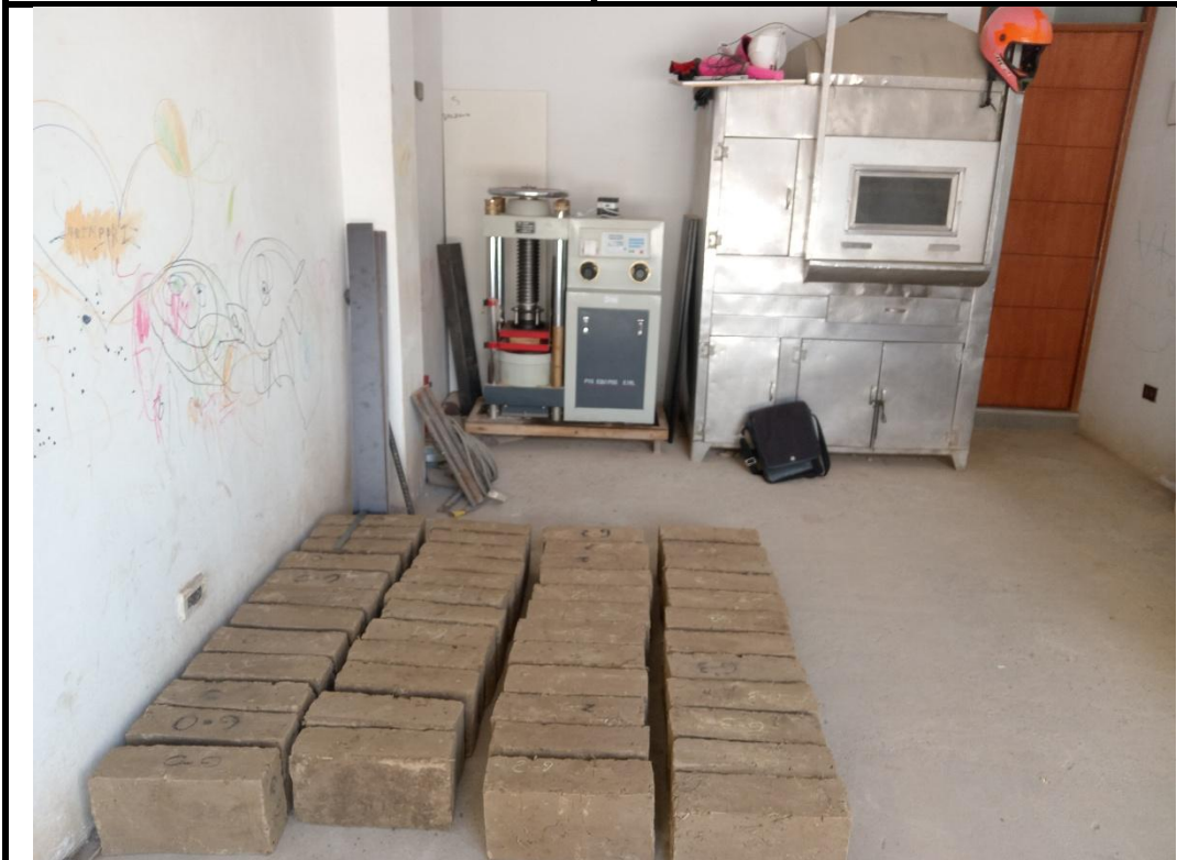
Adobes mejorados y sin mejorar en el Laboratorio de suelos MONTAÑA.
