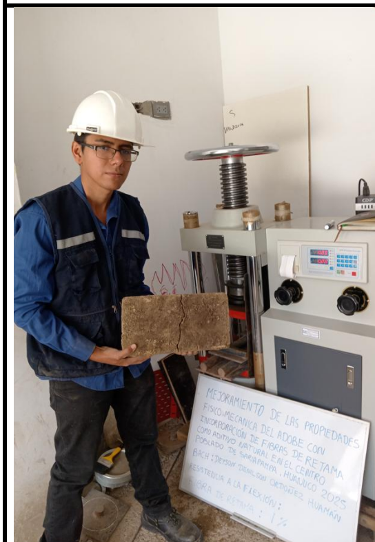
Se muestra como quedó después del análisis a la flexión del adobe con 1% de incorporación de fibra de retama.
