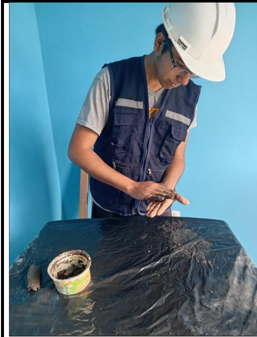
Se realizó la prueba de la presencia de arcilla
