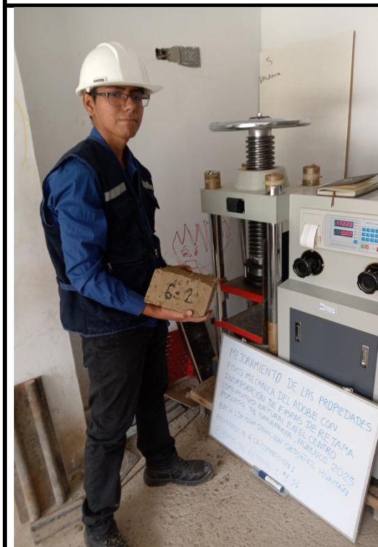
Iniciando de compresión del adobe con 4% de incorporación de retama.
