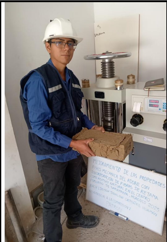
Se muestra el adobe después de la compresión.
