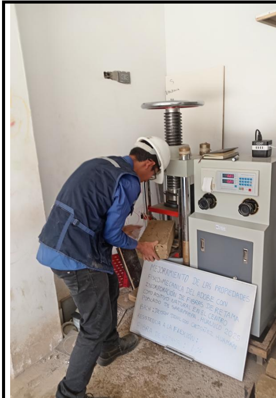
Iniciando análisis de flexión del adobe con 1% de incorporación de fibra de retama.
