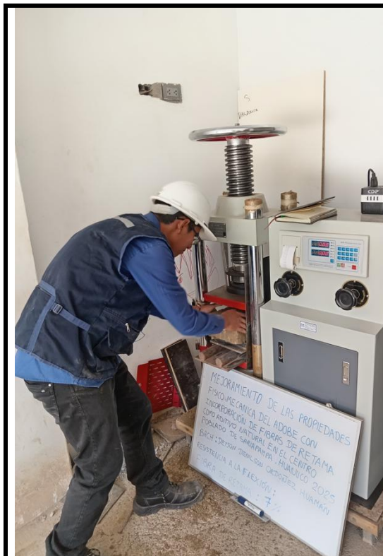
retirando el adobe con 7 % de incorporación de fibra de retama de la prensa.
