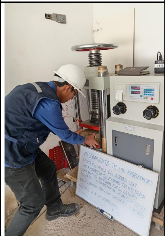
Colocando el adobe con 4% de incorporación de retama en la prensa.
