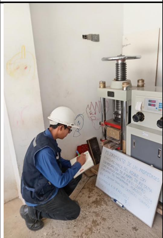
Tomando anotaciones de la prensa durante el análisis de flexión del adobe con 7% de incorporación de fibra de retama.
