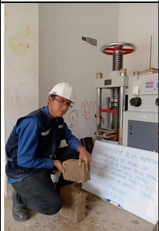
Se muestra como quedo después del análisis a la flexión del adobe sin mejorar o patrón.
