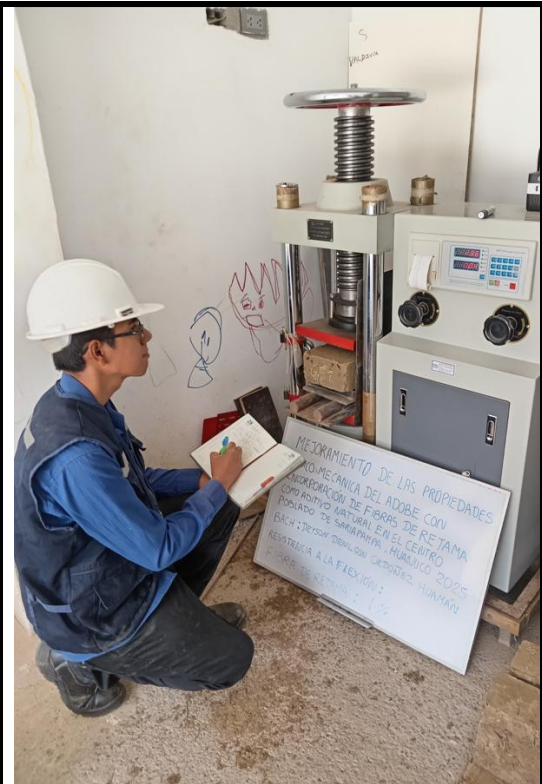
Tomando anotaciones de la prensa durante el análisis de flexión del adobe con 1% de incorporación de fibra de retama.
