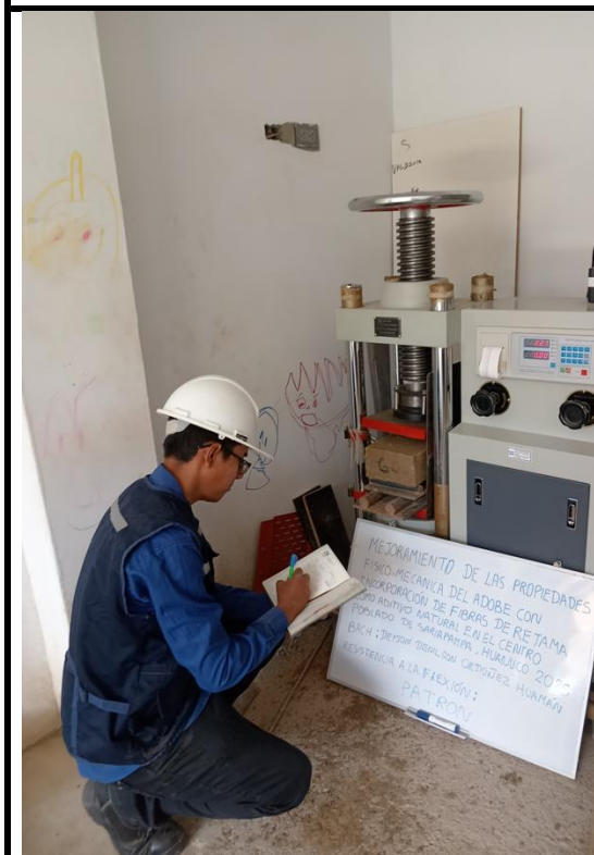
Tomando anotaciones de la prensa durante el análisis de flexión del adobe sin mejorar o patrón.
