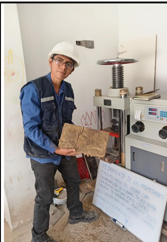
Se muestra como quedo después de la flexión el adobe con 7 % de incorporación de fibra de retama.
