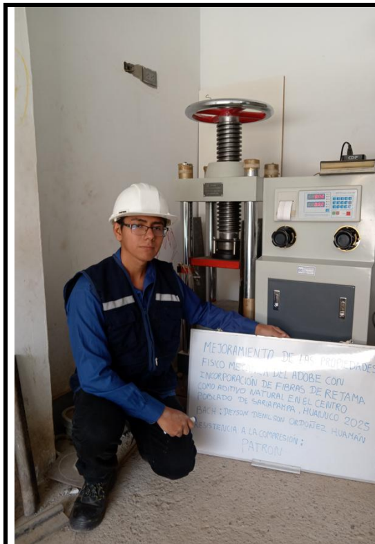
Inicio de prueba de compresión del adobe sin mejorar o tradicional de la zona.
