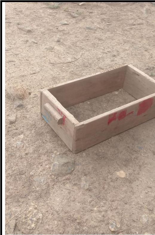
Molde que se empleó para la fabricación de los adobes
