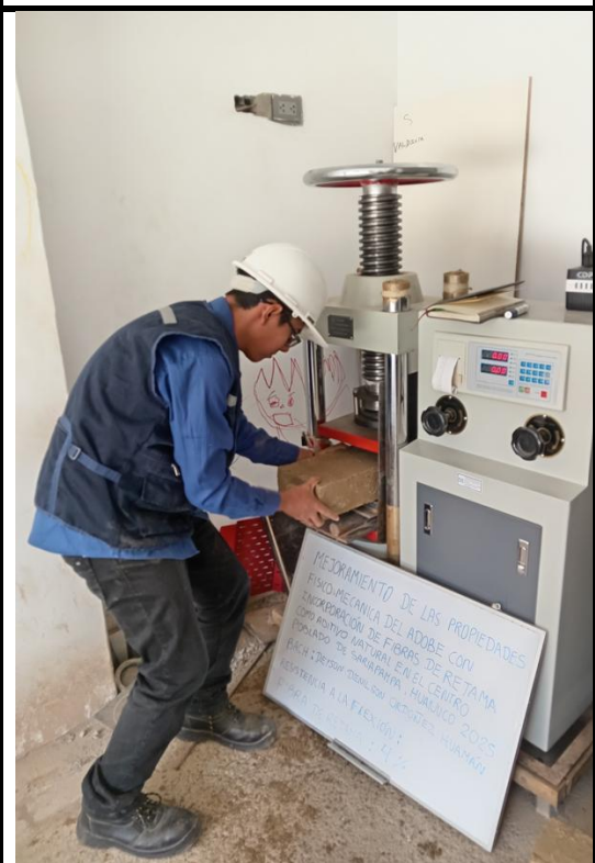
Iniciando análisis de flexión del adobe con 4% de incorporación de fibra de retama.
