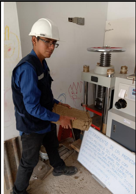
Se muestra como quedo después de la compresión el adobe con 1 % de incorporación de fibra de retama.
