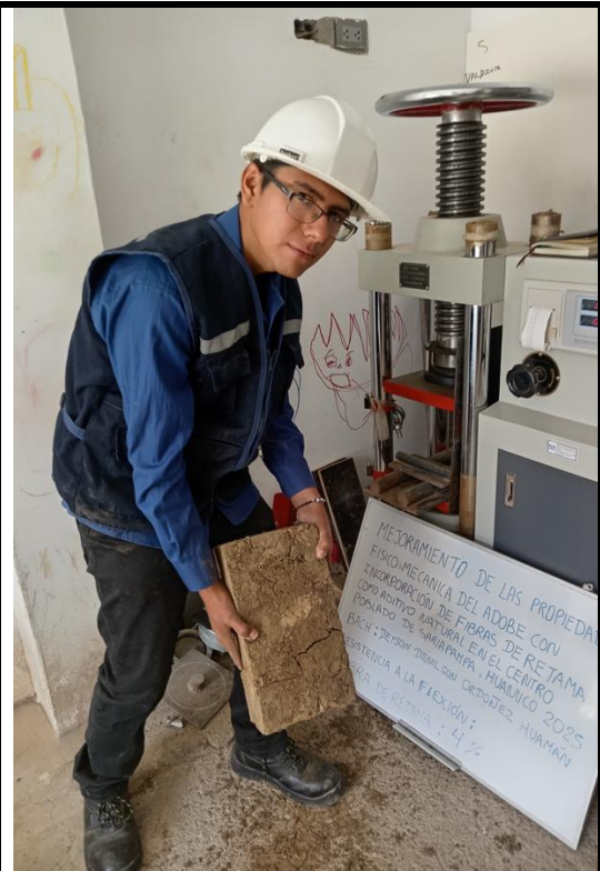
Se muestra como quedo después del análisis a la flexión del adobe con 4% de incorporación de fibra de retama.
