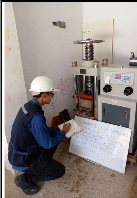
Tomando anotaciones de la prensa durante el análisis de flexión del adobe con 4% de incorporación de fibra de retama.
