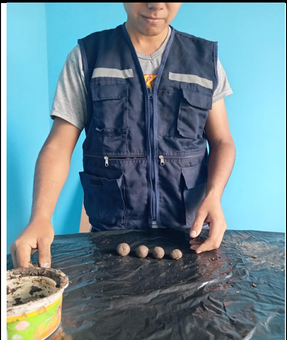
Se realizó las bolitas de tierra para la prueba de la presencia de arcilla
