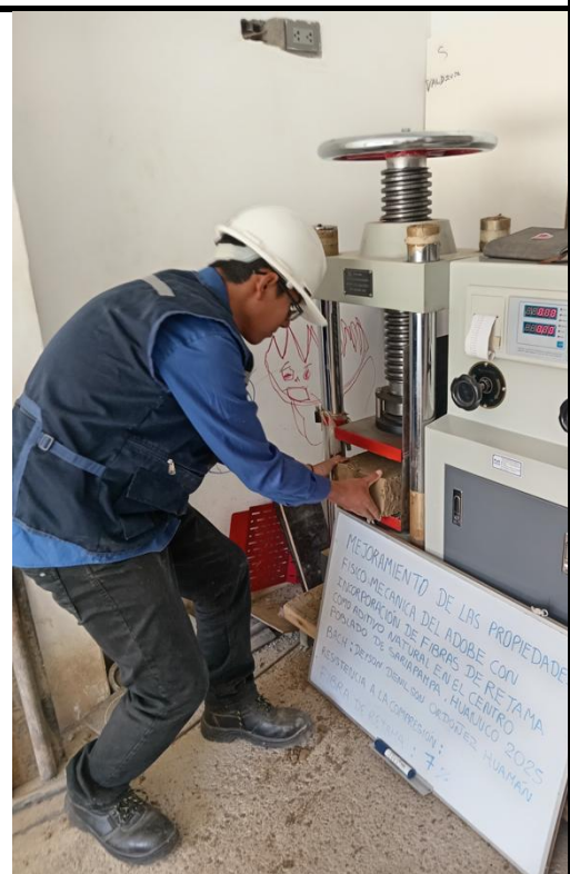
Iniciando la compresión del adobe con 7% de incorporación de retama.
