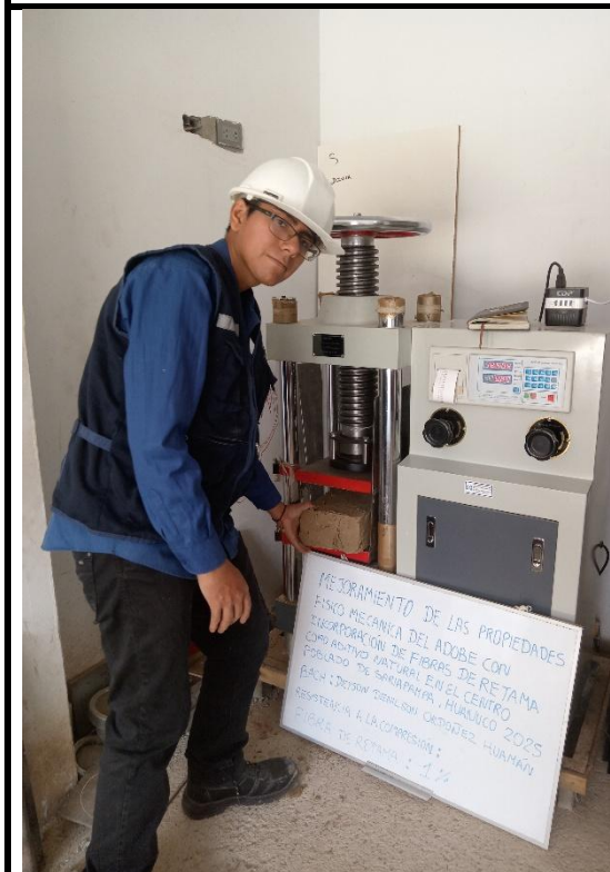
Iniciando de compresión del adobe con 1% de incorporación de fibra de retama.
