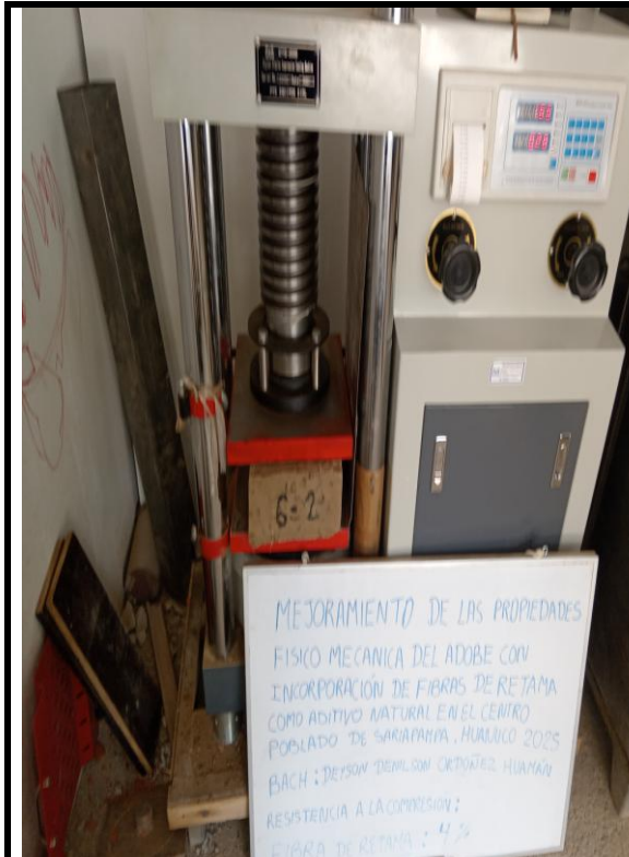
Iniciando la compresión del adobe con 4% de incorporación de retama.
