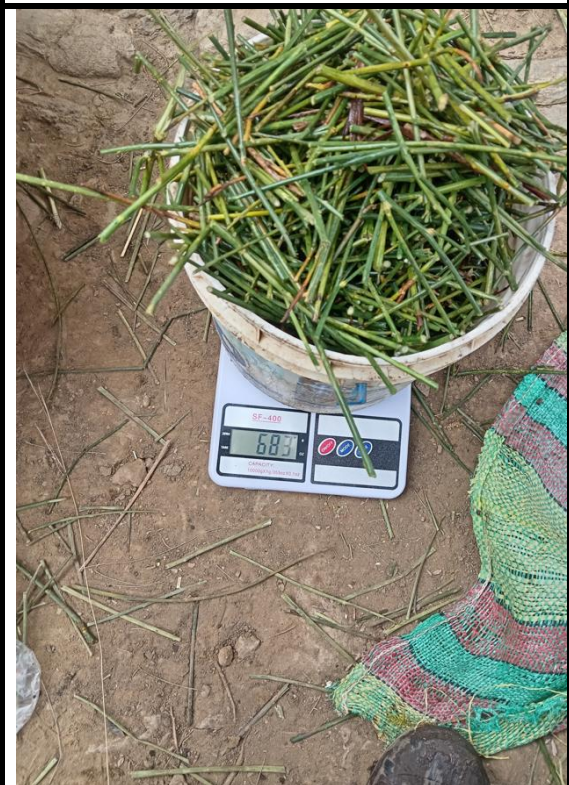
Pesaje de la fibra de retama para la incorporación.
