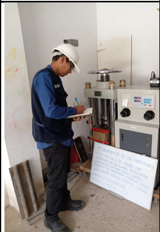
Tomando anotaciones de la prensa del adobe con 1% de incorporación de fibra de retama.
