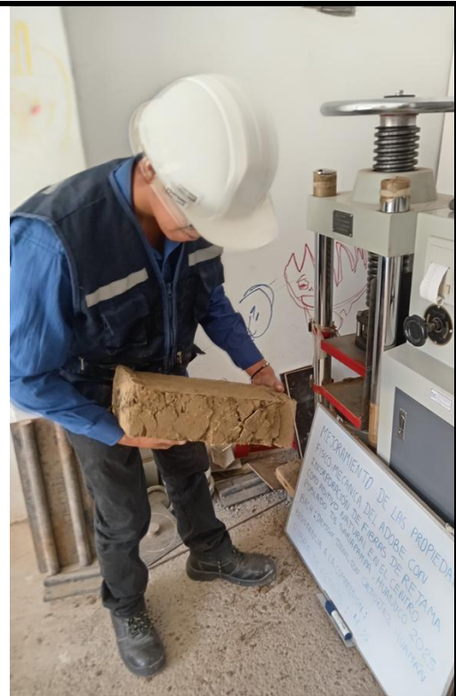
Se muestra como quedo después de la compresión el adobe con 4% de incorporación de fibra de retama.
