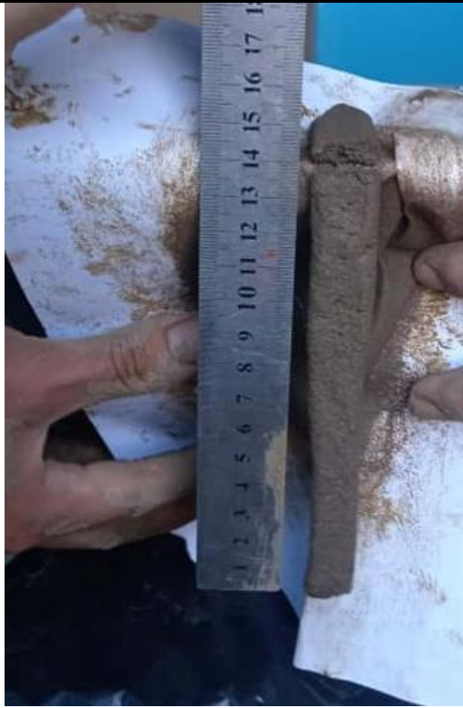
Se confirmó la presencia de arcilla adecuada en la tierra.
