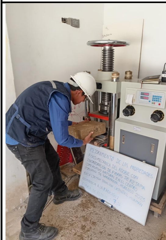
Iniciando el análisis de flexión del adobe con 7% de incorporación de retama.
