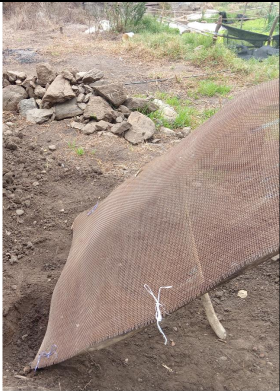
Malla N°6 que se usó para separar las piedras grandes de la tierra.
