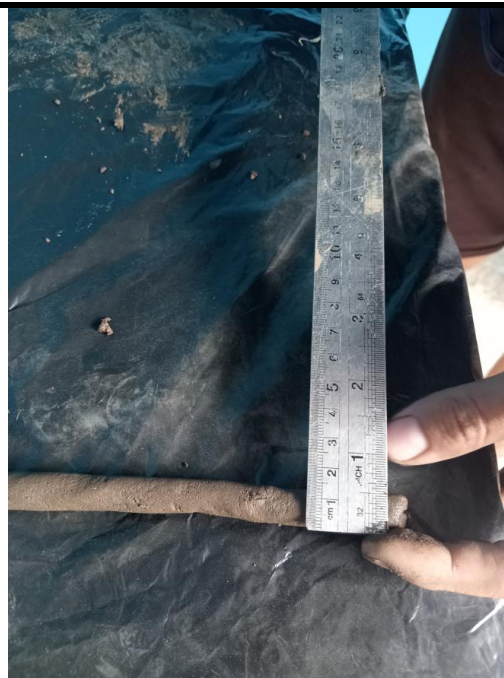
Se realizó la prueba de la cinta de barro.
