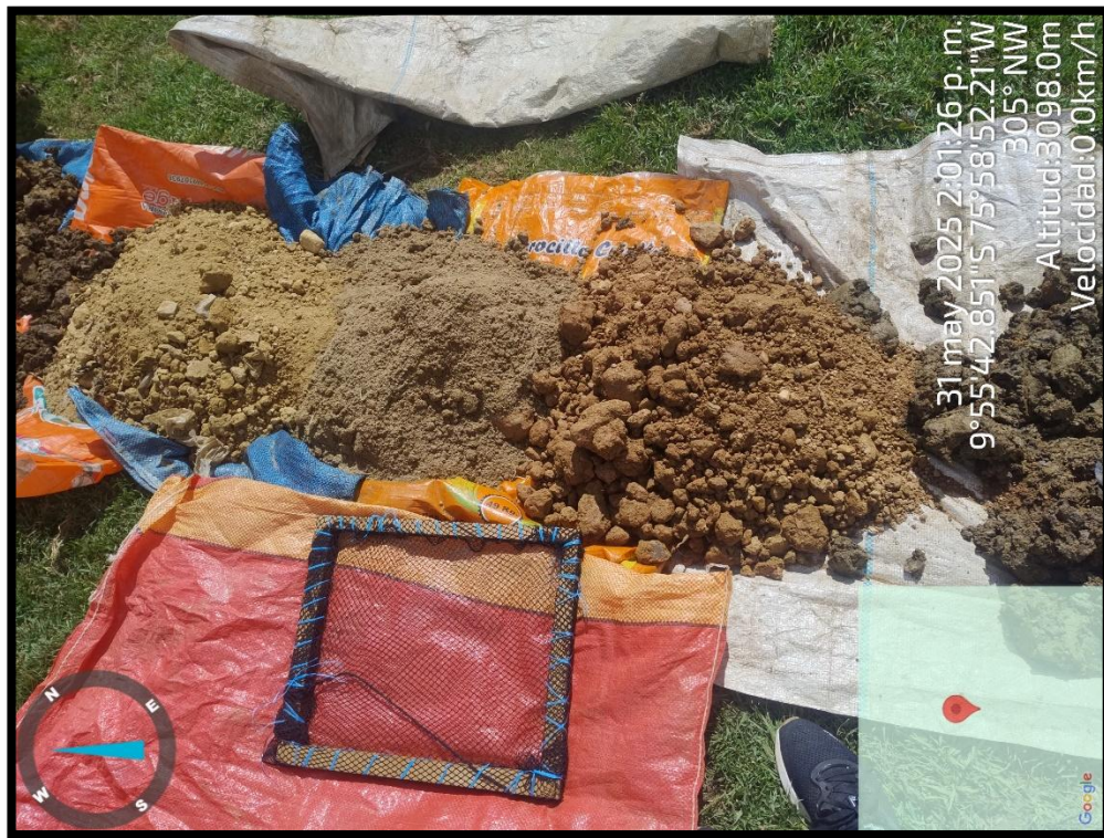
Fotografía : Se realiza el tamizado de la muestra de suelo, con la finalidad de separar los restos de residuos sólidos.
