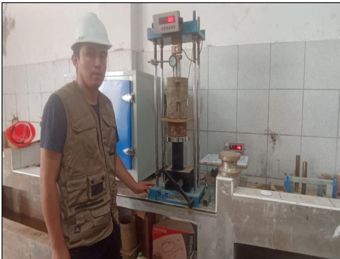
Registro visual del ensayo CBR, como parte de los trabajos de estudio de Suelos en el laboratorio Geo Estructuras.
