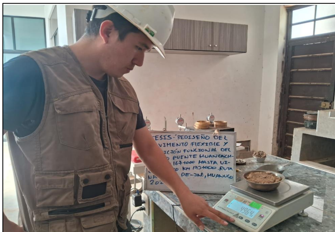
Figura 131. Registro visual del ensayo de Contenido de Humedad, como parte de los trabajos de estudio de Suelos en el laboratorio Geo Estructuras.
