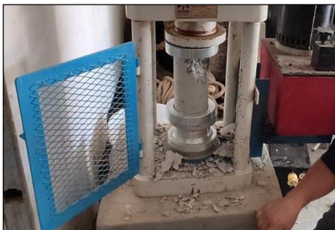
Vista de las pruebas de compresión del concreto.
