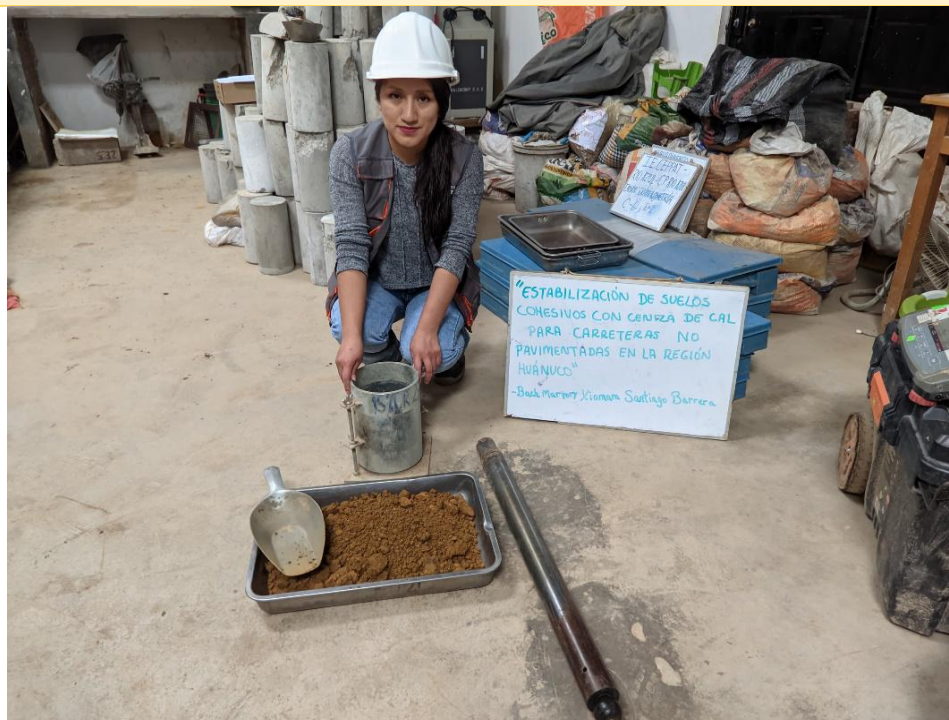
IMAGEN 10: ENSAYO DE PROCTOR MODIFICADO – INICIAMOS EL PROCESO DE COMPACTACIÓN
