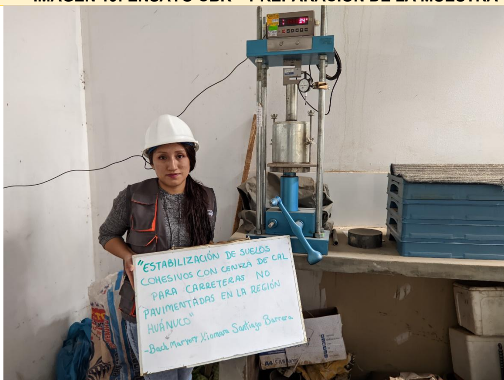
IMAGEN 20: ENSAYO CBR – COLOCAMOS LA MUESTRA EN LA MAQUINA PARA ENSAYOS CBR
