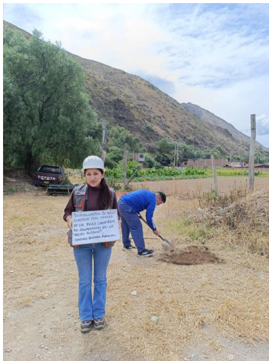
IMAGEN 01: APRECIAMOS LA EXTRACCIÓN DE MUESTRA DE SUELO DE LA CALICATA N°01
