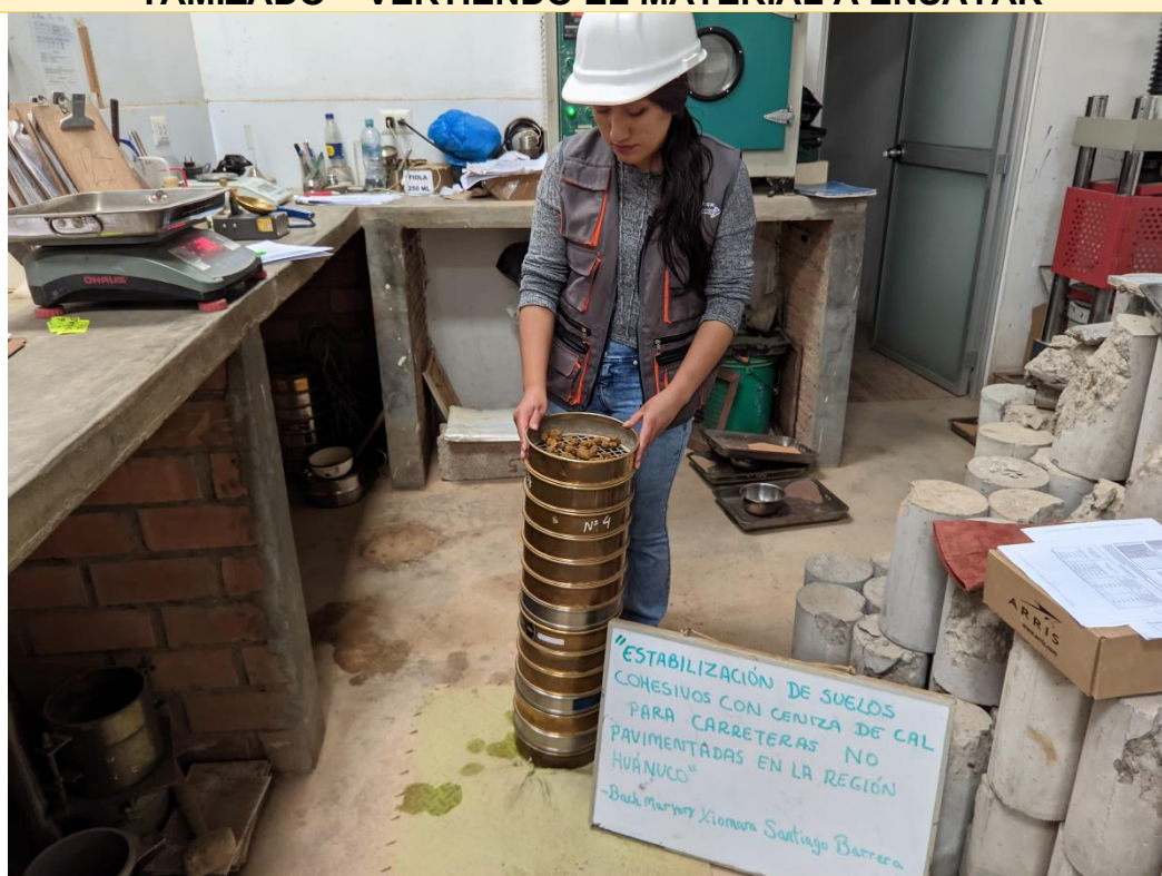
IMAGEN 06: SE PROCEDE AL ENSAYO GRANULOMÉTRICO POR TAMIZADO
