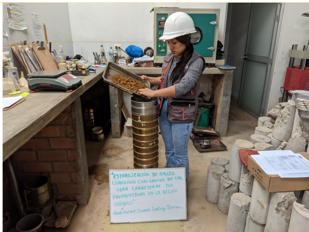
IMAGEN 05: SE PROCEDE AL ENSAYO GRANULOMETRICO POR TAMIZADO – VERTIENDO EL MATERIAL A ENSAYAR
