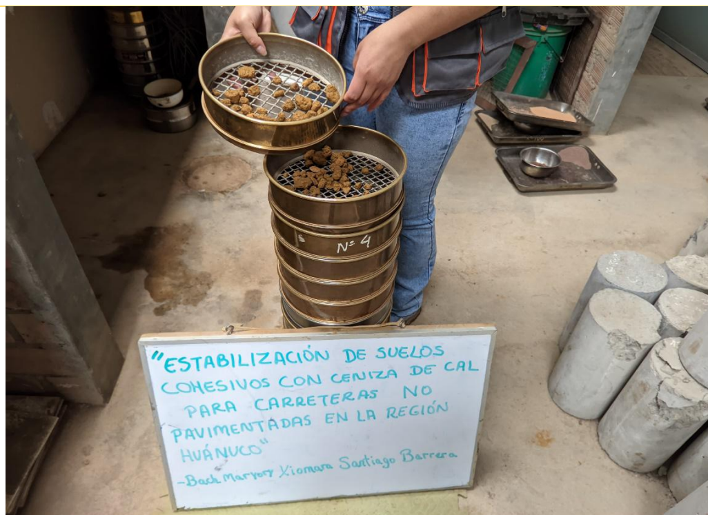
IMAGEN 07: SE PROCEDE AL ENSAYO GRANULOMÉTRICO POR TAMIZADO – RETIRO DE CADA TAMIZ
