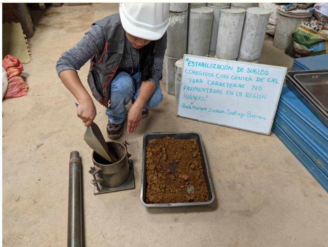
IMAGEN 11: ENSAYO DE PROCTOR MODIFICADO – LLENADO DEL CILINDRO
