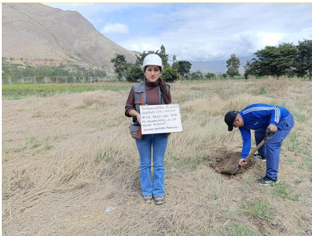
IMAGEN 03: APRECIAMOS LA EXTRACCIÓN DE MUESTRA DE SUELO DE LA CALICATA N°03
