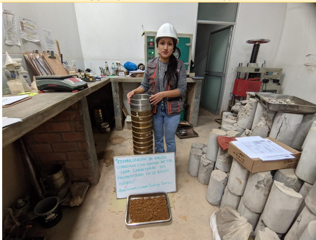
IMAGEN 04: SE PROCEDE AL ENSAYO GRANULOMÉTRICO POR TAMIZADO – ORDENANDO LOS TAMIZES
