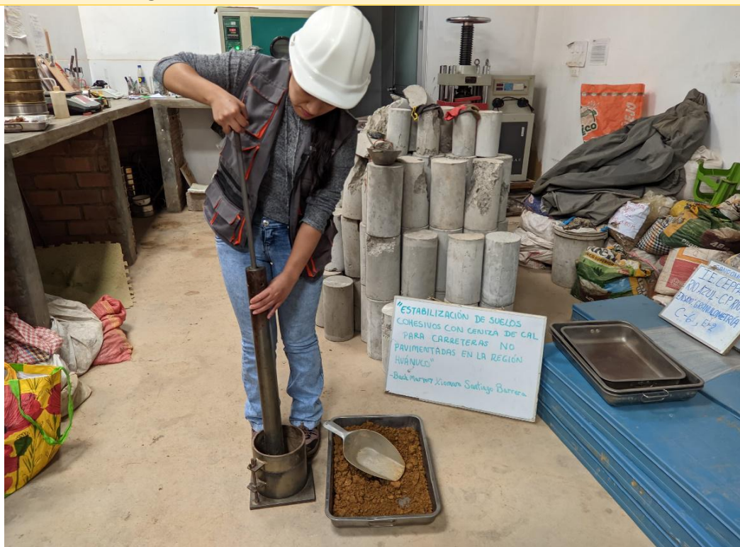
IMAGEN 12: ENSAYO DE PROCTOR MODIFICADO – APLICACIÓN DE GOLPES PARA EL COMPACTADO DEL MATERIAL EN EL CILINDRO
