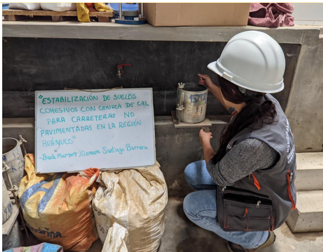
IMAGEN 19: ENSAYO CBR – PREPARACIÓN DE LA MUESTRA
