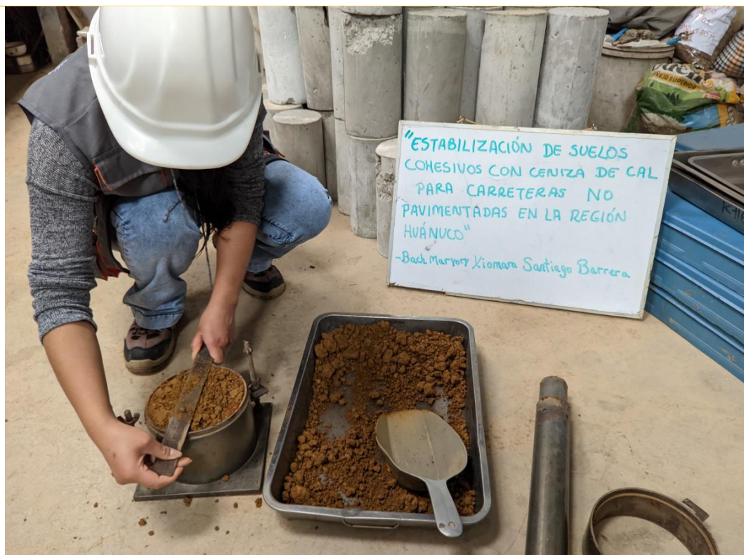
IMAGEN 13: ENSAYO DE PROCTOR MODIFICADO – PREPARAMOS EL CILINDRO PARA REALIZAR EL PESADO
