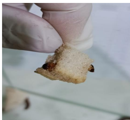
Fotografía 81: Comparación visual entre fragmentos de poliuretano biodegradado y remanentes del material original.
