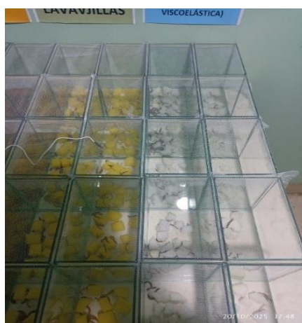
Fotografía 31: Distribución de los residuos de poliuretano y sustratos en los módulos experimentales durante el periodo de evaluación.
