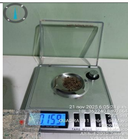
Fotografía 59: Verificación del peso de excretas larvarias mediante balanza digital durante el procedimiento experimental.
