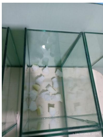
Fotografía 25: Colocación del residuo de poliuretano tipo almohada viscoelástica en el módulo experimental.
