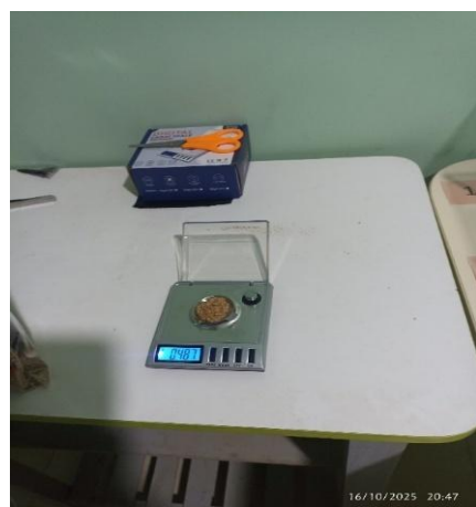
Fotografía 16: Pesaje del residuo de poliuretano previo a su aplicación en los módulos experimentales.
