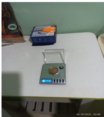
Fotografía 17: Registro del peso del residuo de poliuretano mediante balanza digital.
