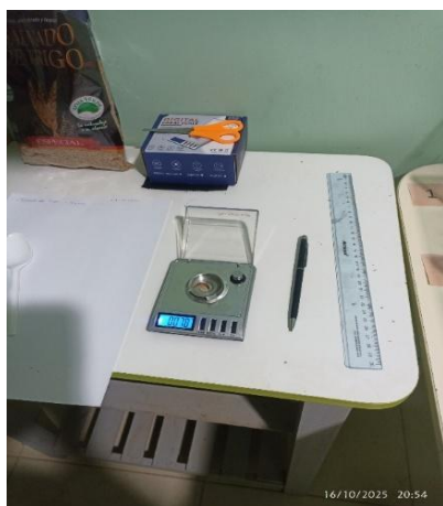
Fotografía 19: Preparación del equipo de medición y disposición de instrumentos para el pesaje del material experimental.
