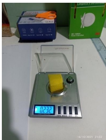
Fotografía 27: Pesaje del residuo de poliuretano tipo espuma previo a su distribución en los módulos experimentales.
