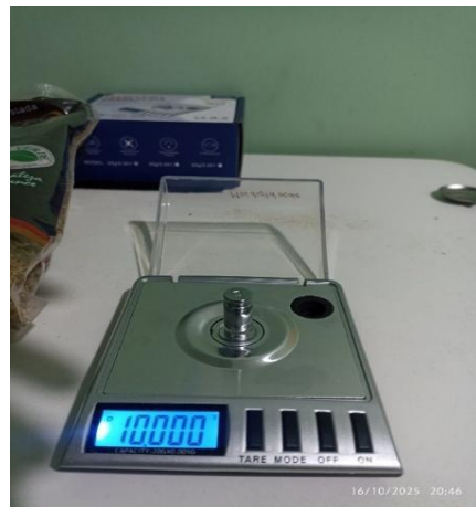
Fotografía 14: Lectura y verificación del peso en la balanza digital.
