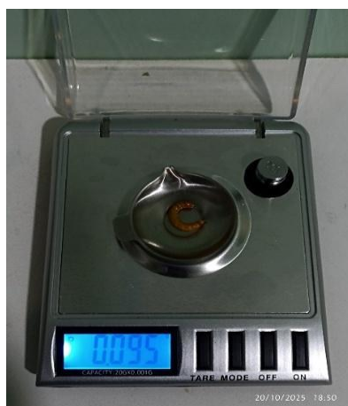
Fotografía 39: Pesaje individual de larva de Tenebrio molitor en balanza digital de precisión.
