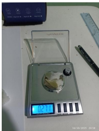
Fotografía 23: Pesaje de fragmentos de residuo de poliuretano utilizando balanza digital.
