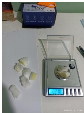
Fotografía 24: Registro del peso de los fragmentos de residuo de poliuretano previo a su aplicación en los módulos experimentales.
