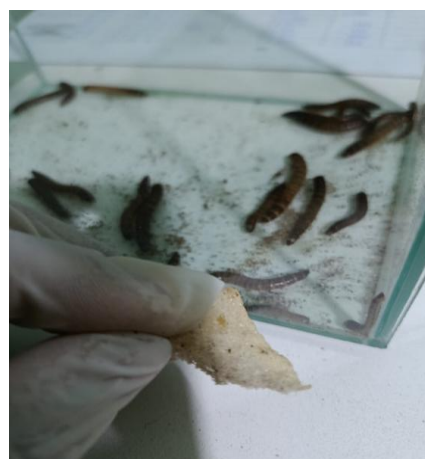
Fotografía 79: Inspección manual de fragmento de poliuretano con presencia de porosidad producto del consumo larvario.
