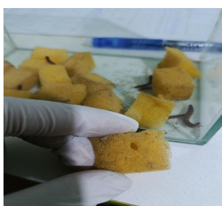
Fotografía 83: Observación comparativa de fragmento de poliuretano con cavidades internas visibles, atribuibles al proceso de consumo larvario durante el periodo experimental.
