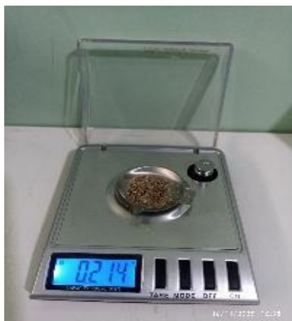
Fotografía 64: Pesaje final de excretas larvarias en balanza digital de precisión para la determinación de la eficiencia biodegradativa.
