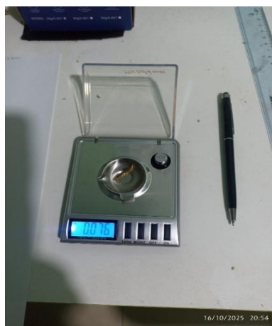
Fotografía 20: Verificación del funcionamiento y calibración de la balanza digital previo al pesaje.
