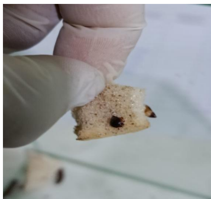
Fotografía 80: Detalle de fragmento de poliuretano con degradación visible y residuos biológicos adheridos.
