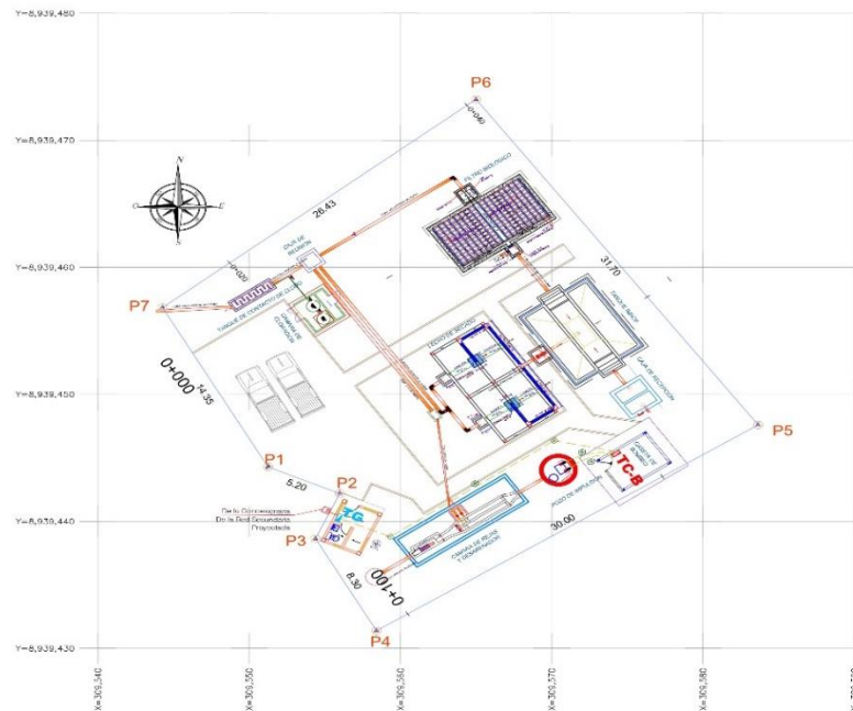
PLANTA DISTRIBUCIÓN DEL PTAR ESC. 1:200
