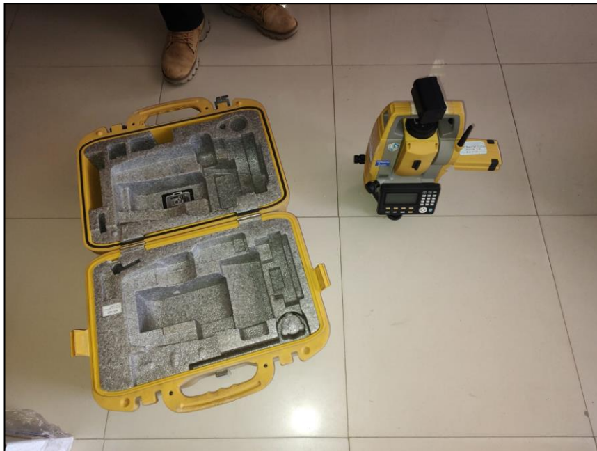
FOTOGRAFÍA N° 01 Equipo topográfico; estación total.
