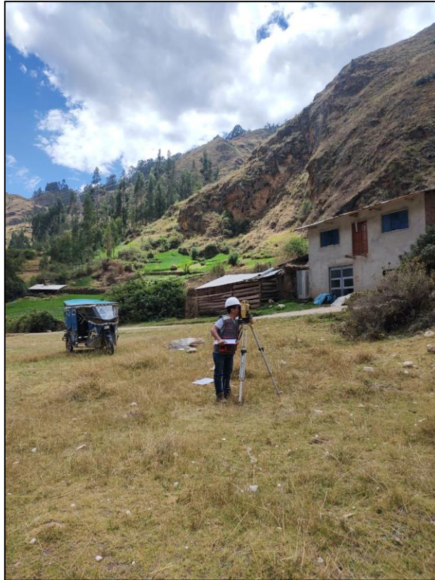
FOTOGRAFÍA N°05: Levantamiento topográfico desde la estación N° 02.
