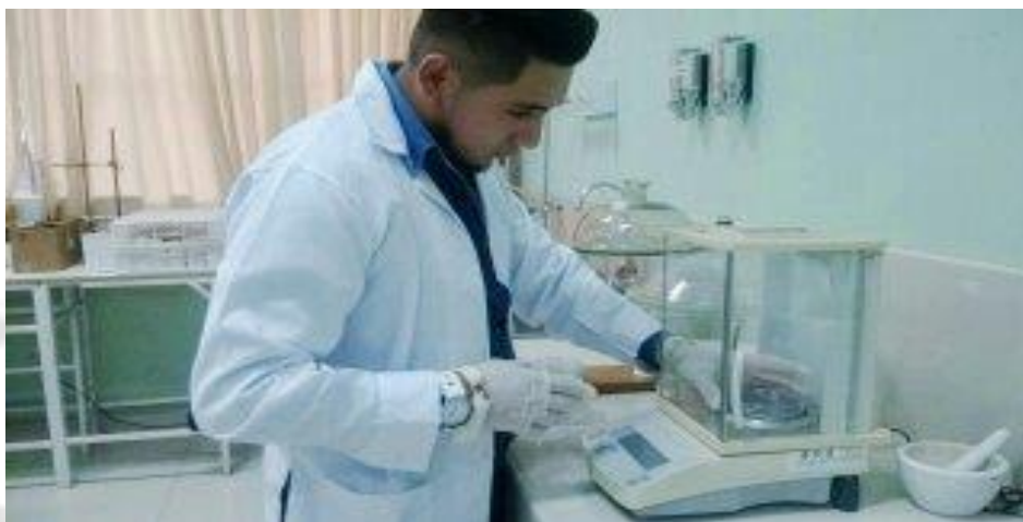
IMAGEN 02: PESANDO LAS PLACAS DEBIDAMENTE CODIFICADAS ANTES DEL MUESTREO
