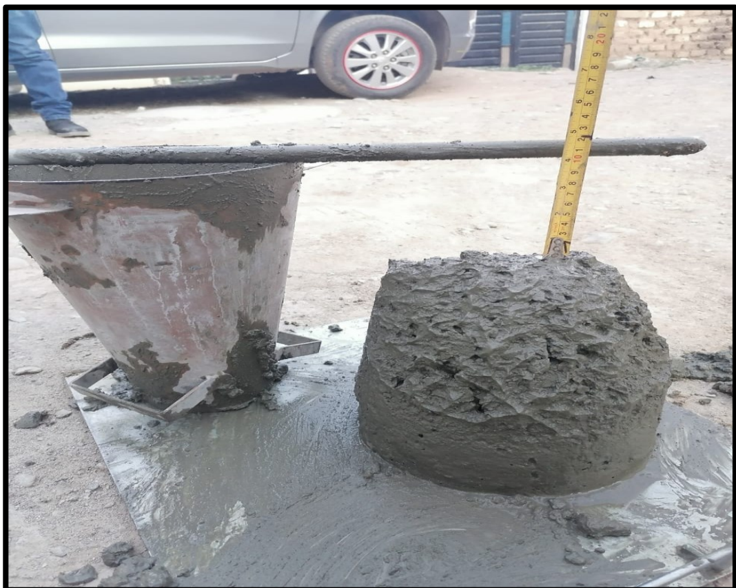
Ensayo del slump, cono de Abrams.
