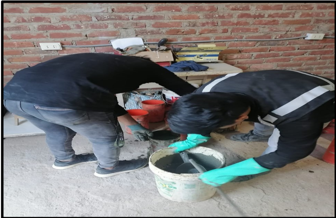
Realizando el vertido de concreto a los moldes de ensayo.
