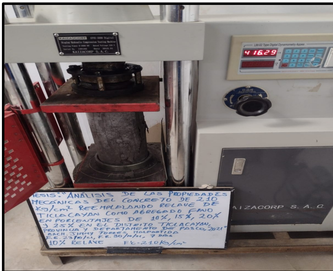
Concreto con 10% de relave minero.
