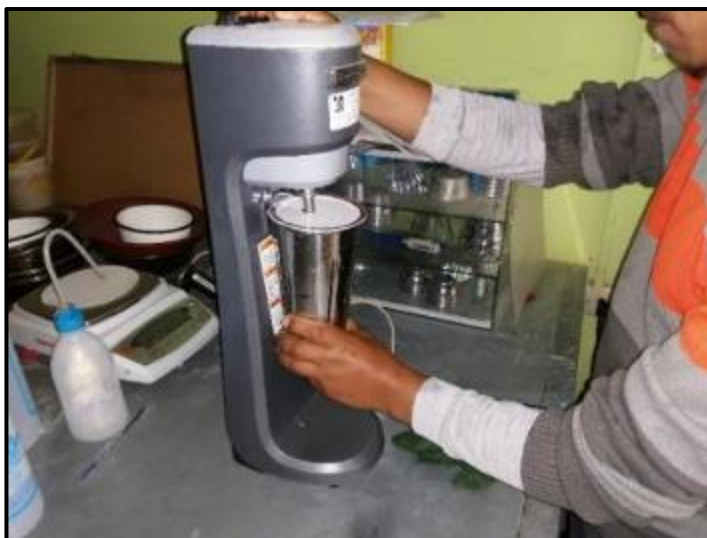
Figura 23 Aparato agitador, mecánico o neumático, con su vaso
