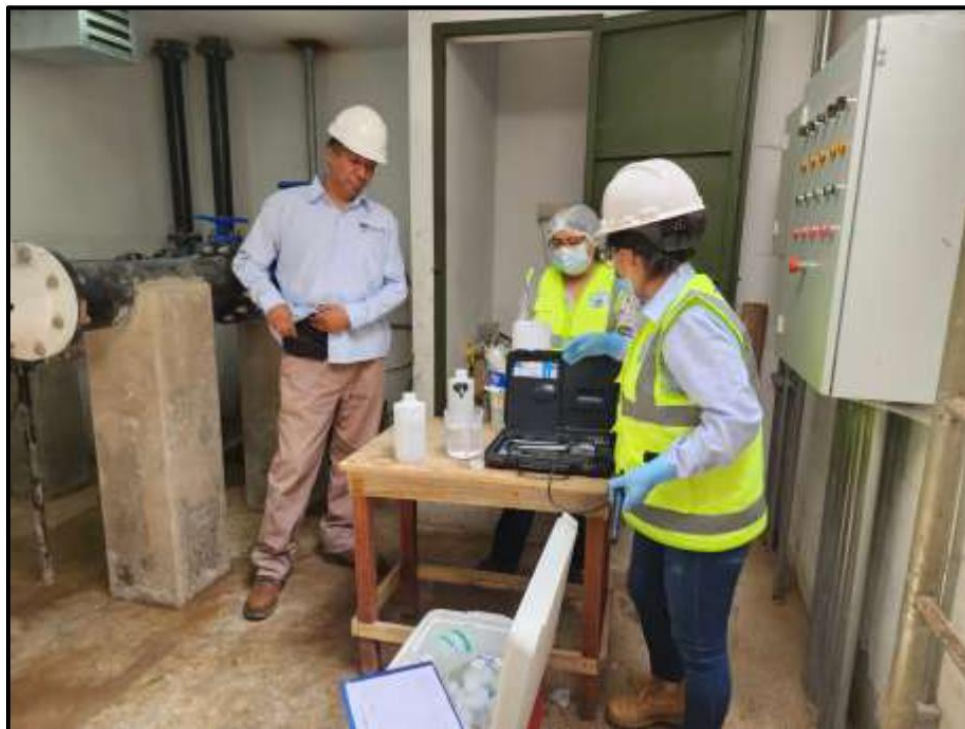
Figura 11 Proceso de medición de los parámetros insitu en el PP-02
