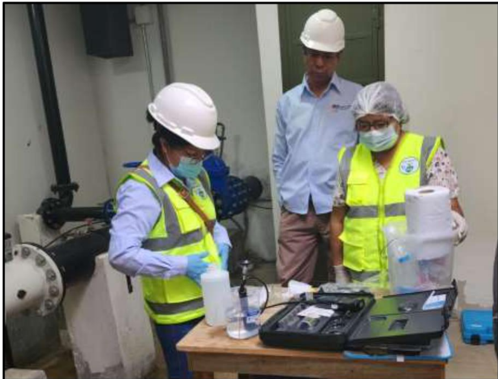
Figura 5 Procedimiento de medición de los parámetros insitu en el PP-01
