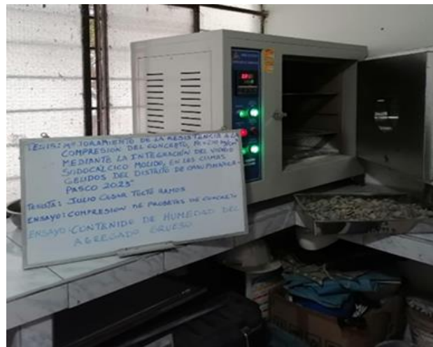
Fotografía 49: Se saca la muestra del horno y se procede a pesar, la diferencia del peso húmedo y el peso seco, determina el contenido de humedad.
