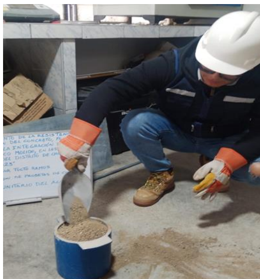
Fotografía 21: Se lleno el recipiente hasta colmar totalmente el molde.
