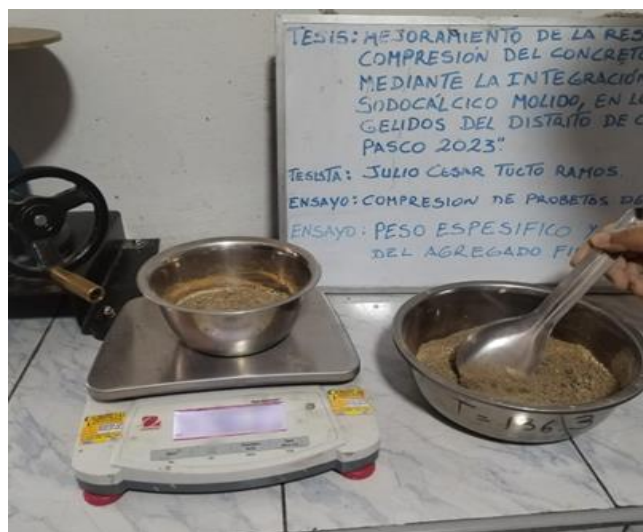
Fotografía 35: Para realizar los ensayos para el peso específico y absorción de agregados finos tomamos la muestra del cuarteo realizado y lo pesamos, lo cual nos basamos a la norma ASTM C128
