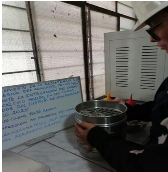
Fotografía 51: Se realizó un zarandeo por un breve tiempo hasta que todo el material pase a través de las mallas inferiores.
