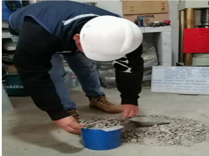
Fotografía 57: Al llenar el recipiente se enraza eliminando el material excedente.
