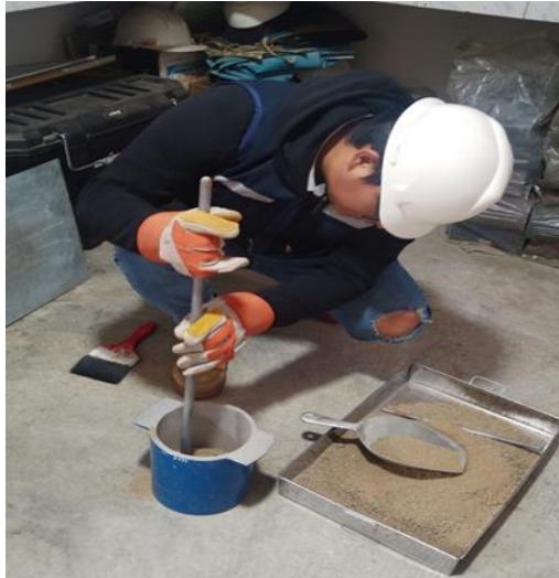
Fotografía 27: una vez llenado el primer tercio se procedió a chucear con una varilla lisa de 5/8" por 25 veces de manera helicoidal y haciendo presión.
