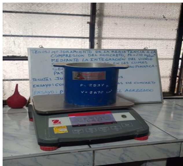
Fotografía 19: Se procedió también a realizar los ensayos de Peso unitario suelto y Peso Unitario compactado, el cual nos basamos a la norma ASTM C29 (Standard Test Method for Bulk Density (Unit Weight) and Voids in Aggregate), iniciamos pesando el recipiente para luego restar los valores cuando lo llenamos con el material.
