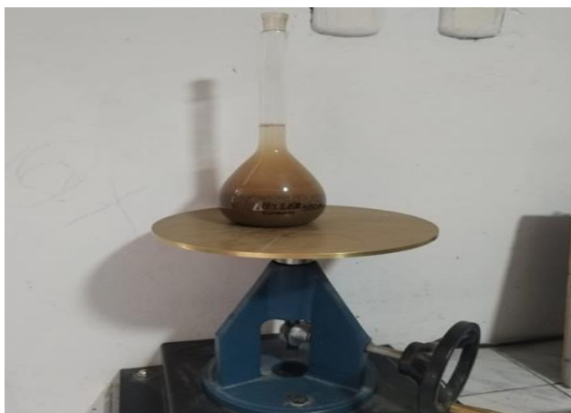
Fotografía 45: Para pesarlo se deja reposar hasta que el nivel del agua alcance a la línea calibrada. Finalmente se extrae toda el agua se lleva al horno y por 24 horas y se toma el peso de la muestra.
