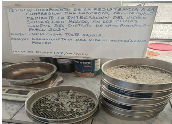
Fotografía 3: Se realizó el proceso de tamizado con un peso seco de 685 gr.
