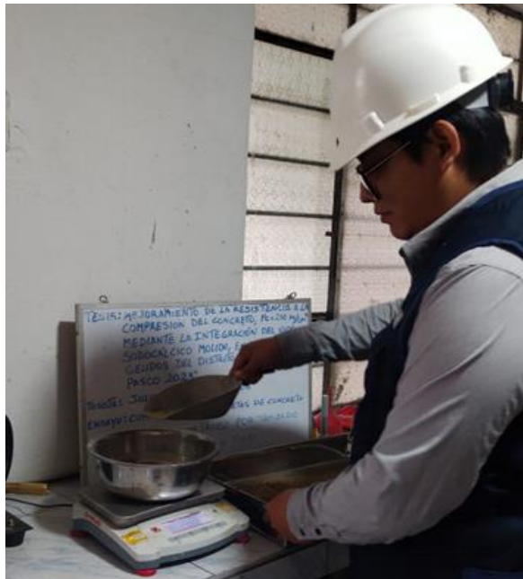
Fotografía 8: La muestra seleccionada se introdujo en una pequeña bandeja de aluminio para que pueda ser pesada en la balanza.
