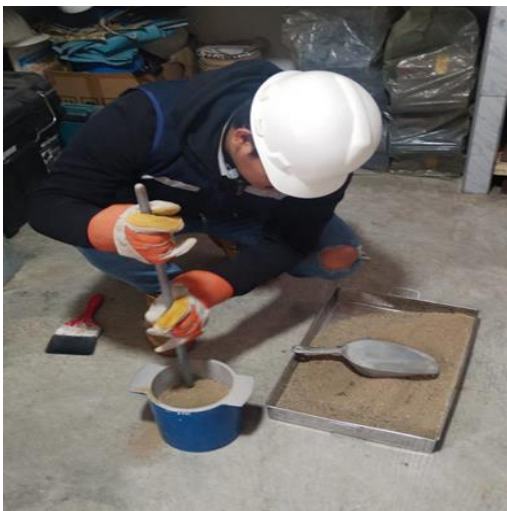
Fotografía 29: Se lleno hasta los 2/3 del recipiente y nuevamente se realizo el chuceo para compactar el material.
