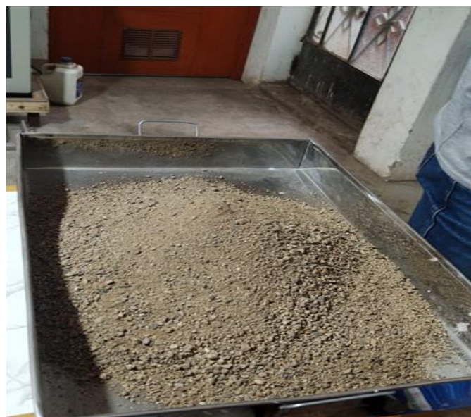
Fotografía 5: Se procedió a realizar los ensayos granulométricos, peso específico, peso unitario y absorción del agregado fino, para el cual se sacó una muestra del agregado extraído de la cantera Sacra Familia – Pasco.
