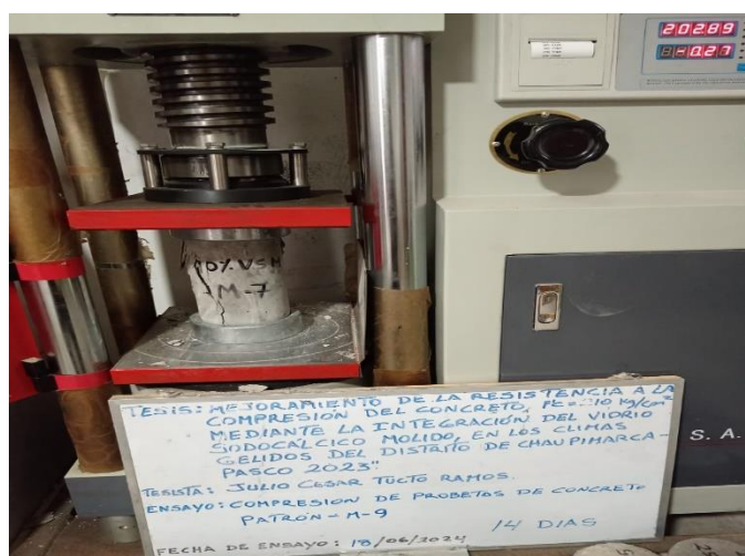
Fotografía 87: En la fotografía se observa que se realizó la rotura de las probetas tipo patrón a los 14 días de edad con el 10% de vidrio sodocálcico molido en reemplazo del agregado fino.
