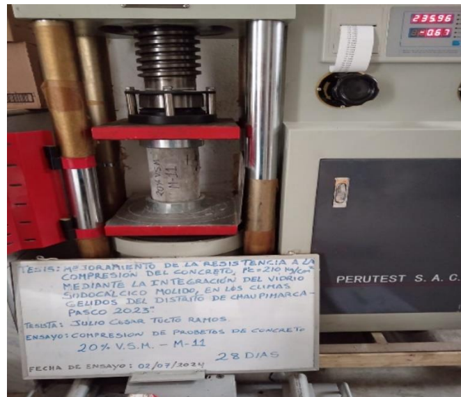
Fotografía 94: En la fotografía se observa que se realizó la rotura de las probetas tipo patrón a los 28 días de edad con el 20% de vidrio sodocálcico molido en reemplazo del agregado fino
