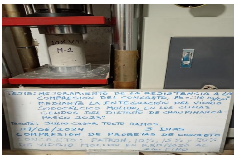
Fotografía 77: En la fotografía se observa que se realizó la rotura de las probetas tipo patrón a los 3 días de edad con el 10% de vidrio sodocálcico molido en reemplazo del agregado fino.
