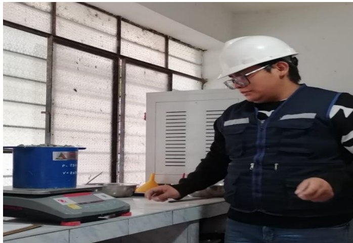
Fotografía 58: Se llevo el recipiente totalmente lleno a la balanza para determinar su peso unitario compactado.
