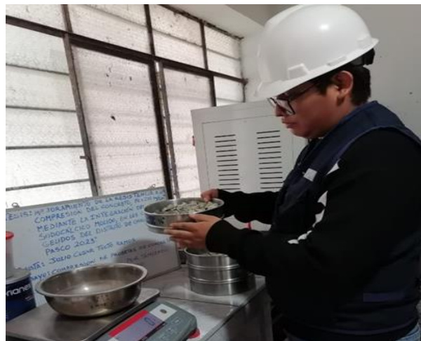
Fotografía 52: Se procedió a pesar lo retenido en cada tamiz.
