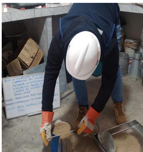
Fotografía 22: El material excedente que desborda el recipiente lo enrazamos con una varilla y se limpió los bordes con una brocha pequeña.
