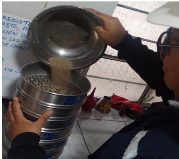
Fotografía 13: Seguidamente se procedió a pasar el material a través de los tamices.
