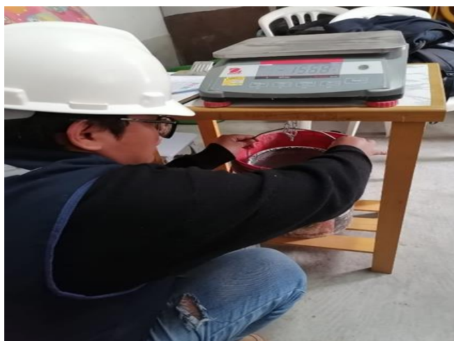
Fotografía 64: Seguidamente se procedió a calcular el peso sumergido en agua de la muestra saturada, colocándola en una canastilla metálica y sumergiéndola en agua a una Temperatura entre 21° y 25°C. Luego retirarla se lleva nuevamente al horno por 24 horas, se retira dejándolo enfriar y se pesa nuevamente.
