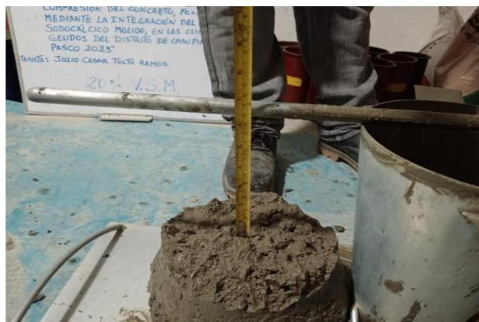
Fotografía 70: Se realizo su prueba de SLUMP para la mezcla con el 20% de vidrio sodocálcico molido en reemplazo del agregado fino.
