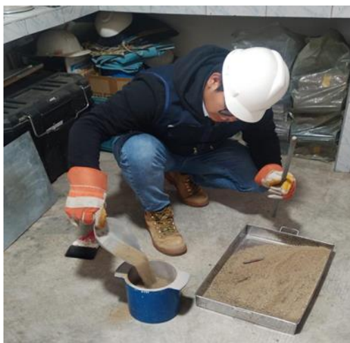
Fotografía 30: Por último, se procedió a llenar lo restante hasta completar el recipiente.
