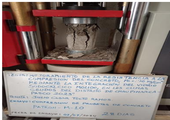
Fotografía 91: En la fotografía se observa que se realizó la rotura de las probetas tipo patrón a los 28 días de edad.
