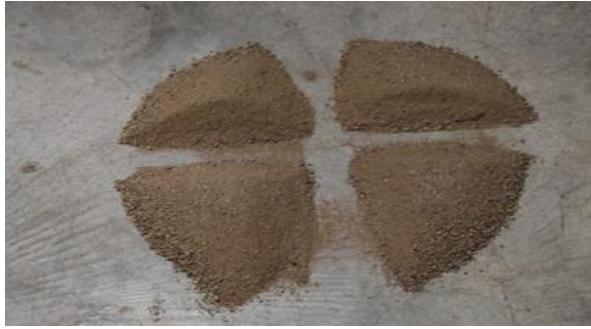
Fotografía 6: Para los ensayos granulométricos se procedió a realizar el cuarteo de la muestra.
