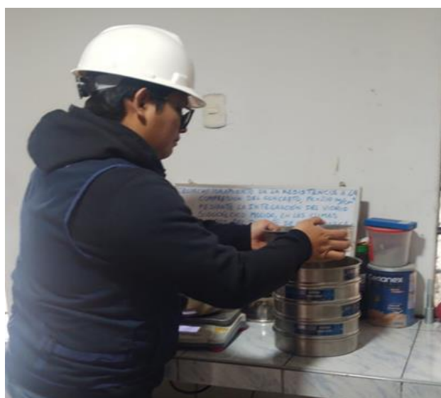
Fotografía 14: Para ayudar a que material pase a través de los tamices se hizo un zarandeo a los tamices.
