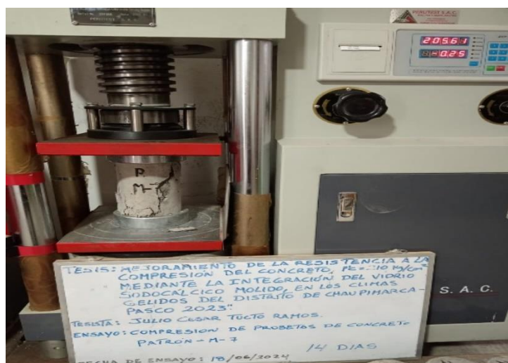
Fotografía 86: En la fotografía se observa que se realizó la rotura de las probetas tipo patrón a los 14 días de edad.
