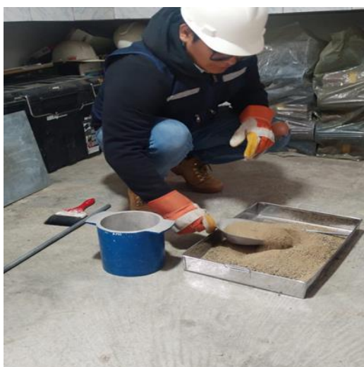
Fotografía 25: Con la otra parte del cuarteo llenamos nuevamente el recipiente, pero para esta vez obtener el Peso Unitario Compactado.
