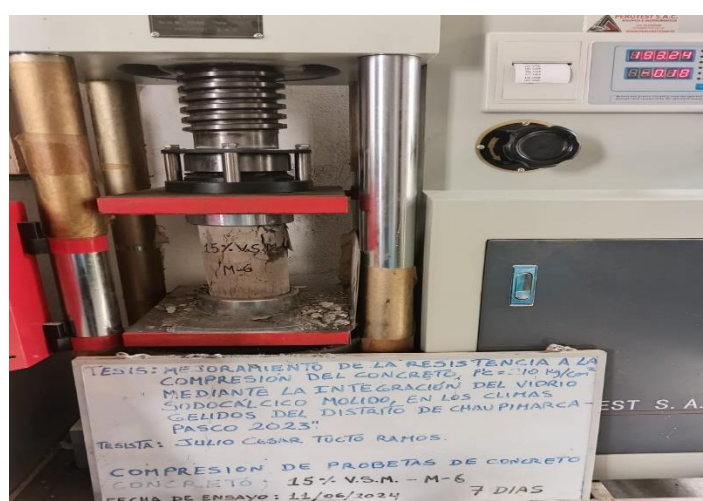
Fotografía 83: En la fotografía se observa que se realizó la rotura de las probetas tipo patrón a los 7 días de edad con el 15% de vidrio sodocálcico molido en reemplazo del agregado fino
