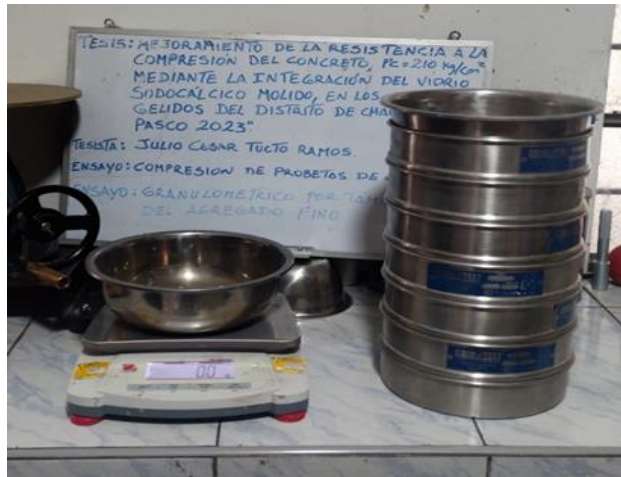
Fotografía 12: Una vez sacado del horno se procedió a pesar para determinar su peso en seco y el % de contenido de humedad de la muestra de agregado fino.
