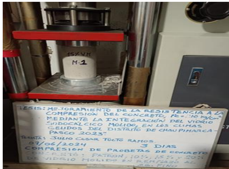
Fotografía 78: En la fotografía se observa que se realizó la rotura de las probetas tipo patrón a los 3 días de edad con el 15% de vidrio sodocálcico molido en reemplazo del agregado fino
