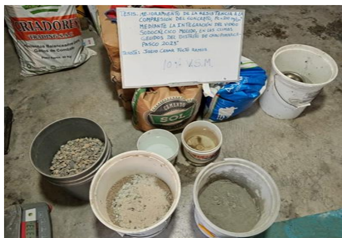
Fotografía 65: El procedimiento de preparación de mezcla, vertido y curado de probetas se realizó en el distrito de Chaupimarca – Pasco. Se inicia realizando la mezcla para el tipo patrón, luego de 10%, 15% y 20% de vidrio sodocálico molido en reemplazo
