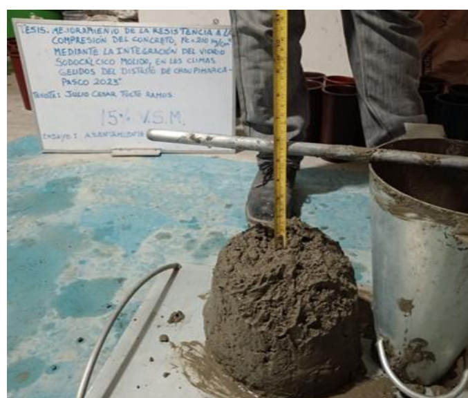
Fotografía 68: Se realizó su prueba de SLUMP para la mezcla con el 15% de vidrio sodocálcico molido en reemplazo del agregado fino.
