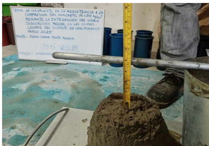
Fotografía 66: Se realizó su prueba de SLUMP para la mezcla con el 10% de vidrio sodocálcico molido en reemplazo del agregado fino.
