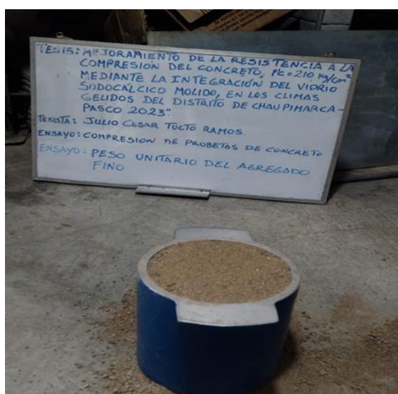
Fotografía 23: Se observa como quedo el recipiente lleno completamente y limpio el borde listo para llevarlo a pesar en la balanza.
