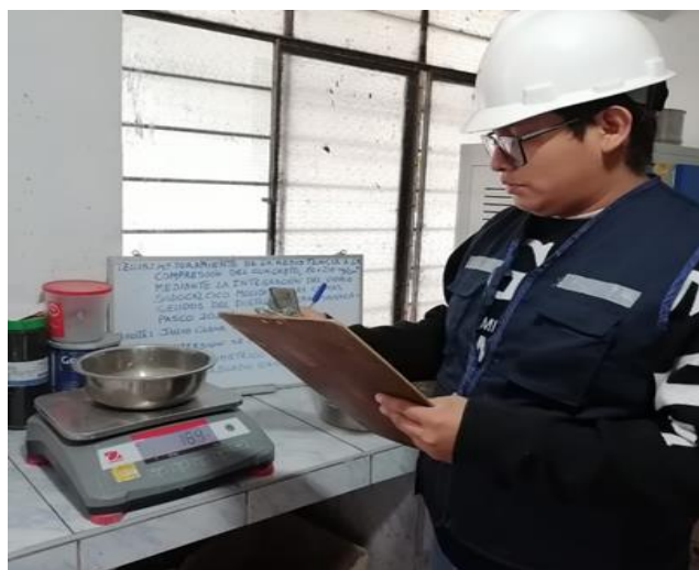
Fotografía 53: Se tomó nota del peso de lo retenido en cada uno de los tamices.
