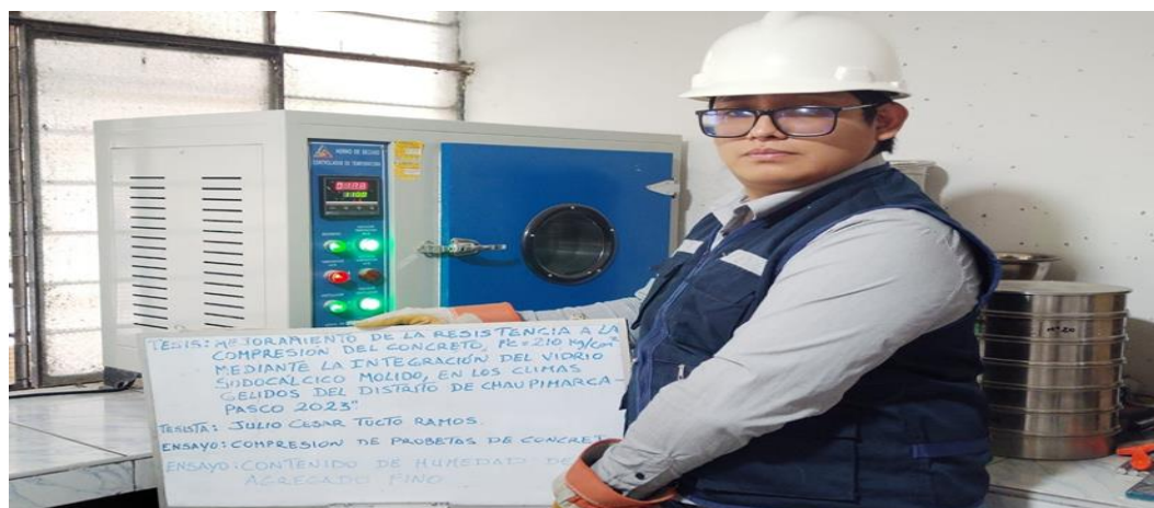
Fotografía 11: Se dejó en el horno por 24 horas a una temperatura de 110^\circ\text{C} \pm 5^\circ\text{C} de acuerdo a lo que indica la Normal ASTM D2216.
