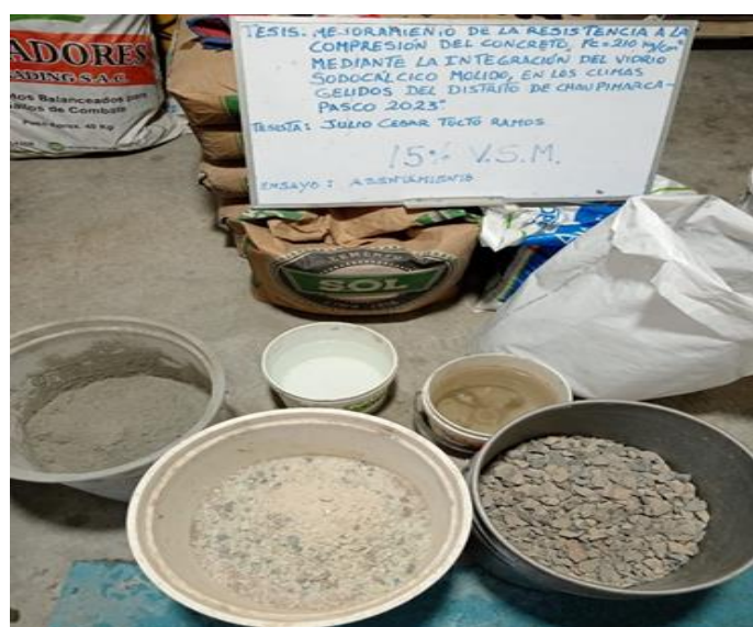
Fotografía 67: Se realizó la mezcla con adición del 15% de vidrio en reemplazo del agregado fino.
