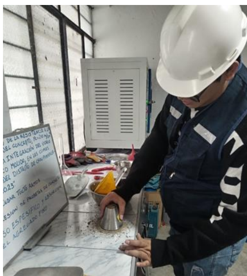
Fotografía 38: Una vez apisonado se retira cuidadosamente el molde para verificar que cumpla con las 3S.
