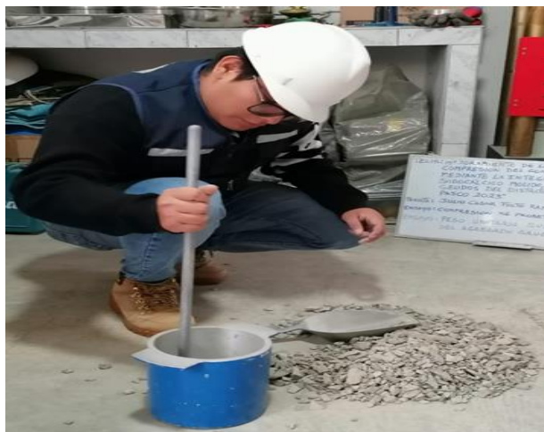
Fotografía 56: Para el Peso unitario compactado se realizó en 3 capas, chuceando cada capa con 25 golpes.
