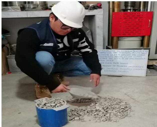
Fotografía 55: Se lleno todo el recipiente con apoyo de la pala y dejándolo caer a una altura de 5cm, para luego enrazarlo y quede sin exceso de material, y así finalmente llevarlo a pesar en la balanza.
