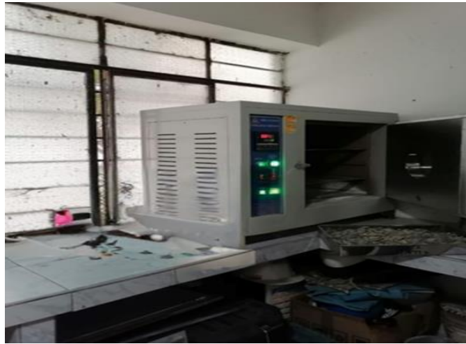
Fotografía 61: Se lavo la muestra y se eliminó todas las impurezas para luego llevarlo al horno por 24 horas.
