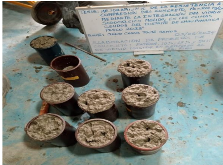
Fotografía 72: Se utilizó probetas de 4"x8" para todas las muestras, el vertido se realiza en 3 capas, se llena la primera capa y se chucea con una varilla lisa de 5/8" dejando un espacio de 1" entre capa y se golpea unas 10 veces alrededor del molde con un martillo de cabeza de goma de 600 gramos, esto servirá para compactar y liberar las burbujas de aire.
