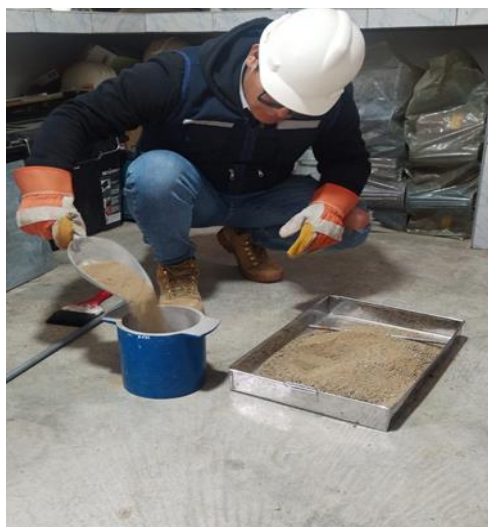
Fotografía 26: Similar al Peso unitario suelto, se procedió a llenar el recipiente echando el material en caída libre pero esta vez en tres partes.
