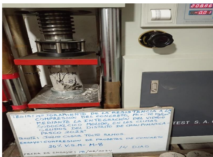
Fotografía 89: En la fotografía se observa que se realizó la rotura de las probetas tipo patrón a los 14 días de edad con el 20% de vidrio sodocálcico molido en reemplazo del agregado fino
