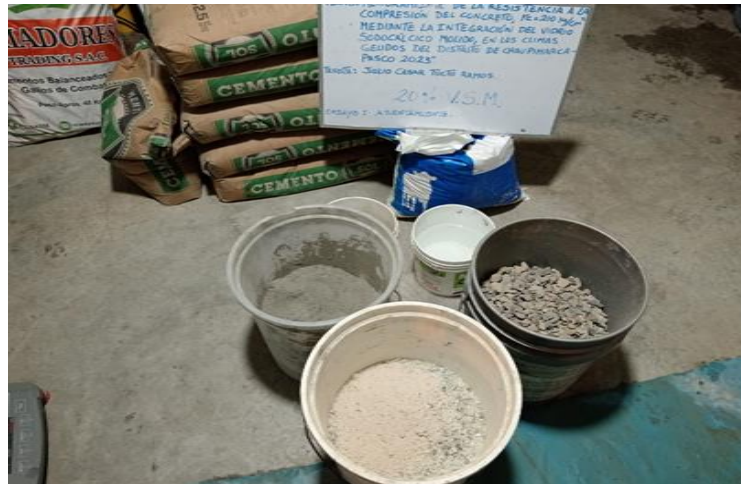
Fotografía 69: Se realizo la mezcla con adición del 20% de vidrio en reemplazo del agregado fino.
