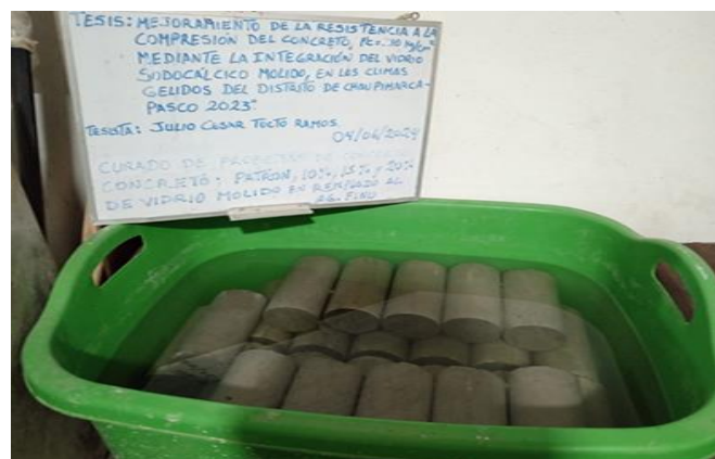
Fotografía 74: Para el curado se utilizó una tina como poza de curado.
