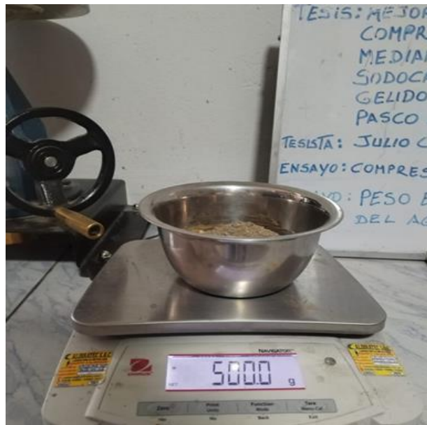
Fotografía 40: Pesamos 500 gr de la muestra para ser llenado en el matraz.
