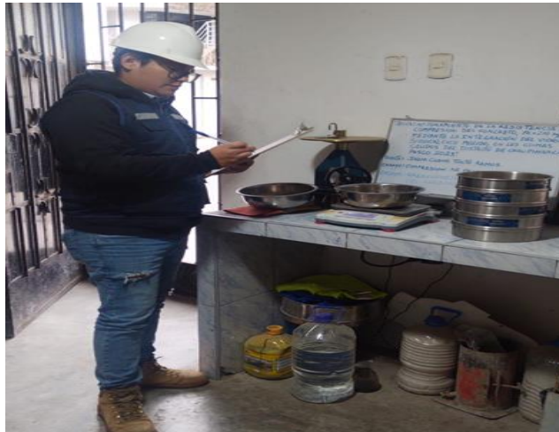
Fotografía 16: Se tomo nota del peso por cada tamiz, en los formatos para luego realizar el análisis granulométrico correspondiente.
