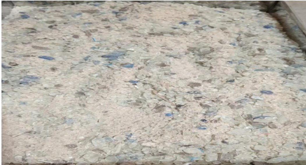
Fotografía 1: Se inicio con la compra del vidrio sodocálcico molido el cual fue obtenido ya en estado triturado en partículas finas de una planta de tratamiento de residuos sólidos.
