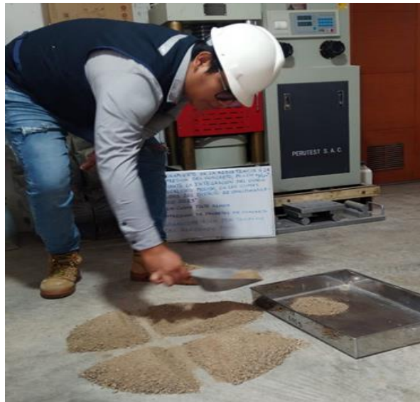
Fotografía 7: Una vez realizado el cuarteo de la muestra se tomó una de las partes para realizar el ensayo granulométrico.
