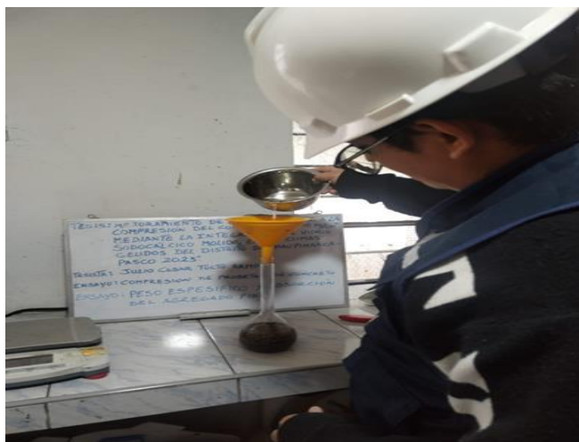
Fotografía 42: Se lleno de agua hasta cubrir el 90% de su capacidad.
