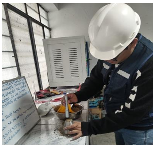
Fotografía 37: Luego fue apisonando 25 veces con ayuda de un pisón, el cual se deja caer a una altura de 5 cm
