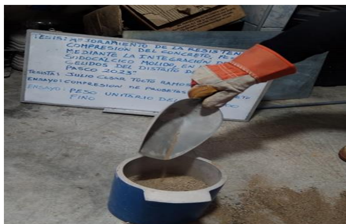
Fotografía 20: Se inicio por el Peso unitario suelto del agregado fino, llenando recipiente con la pala en caída libre a una altura de 5cm.
