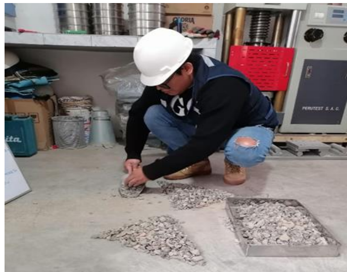
Fotografía 59: Para el peso específico y absorción del agregado grueso, nos basamos a la norma ASTM C127, se realiza el cuarto y se toma las dos partes diagonales.
