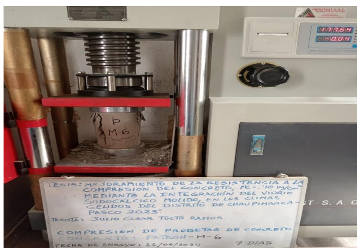
Fotografía 81: En la fotografía se observa que se realizó la rotura de las probetas tipo patrón a los 7 días de edad.
