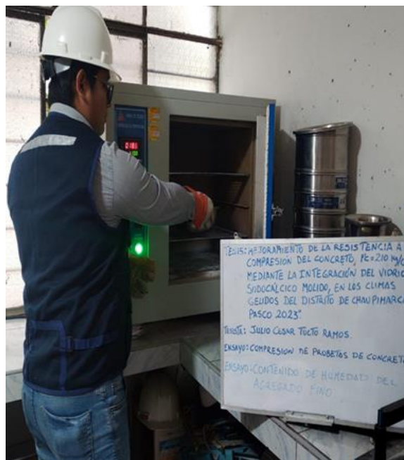
Fotografía 10: En la fotografía se muestra que la muestra se lleva al horno por 24 horas.
