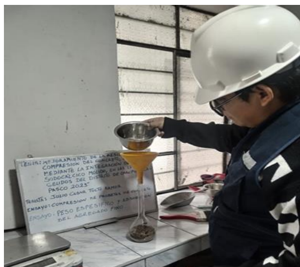
Fotografía 41: Se observa que ya se llenó el material en el matraz y es llenado con agua.
