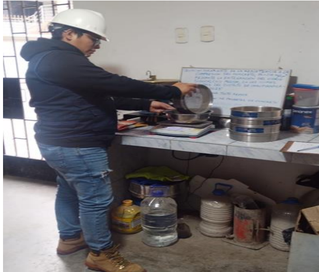
Fotografía 15: Se procedió a pesar el material retenido en los tamices uno por uno.
