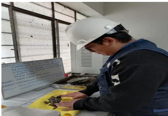
Fotografía 63: Pasado las 24 horas se retiró de la inmersión y se procedió a secar con una franela, hasta eliminar el agua y se toma el peso de la muestra superficialmente seco.
