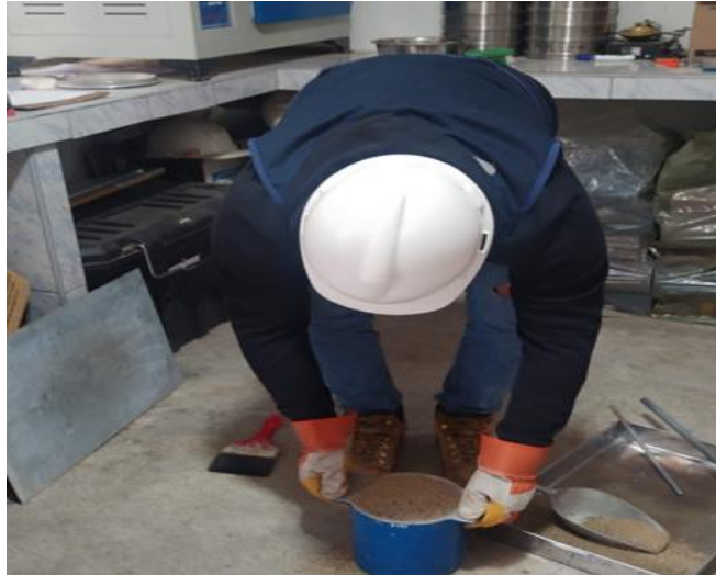
Fotografía 33: En la fotografía se observa el recipiente completamente lleno y al ras, libre de material excedente.
