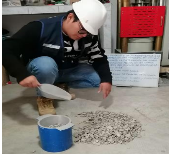
Fotografía 54: Terminando el tamizado se procedió a realizar los ensayos de Peso unitario suelto y compactado para el agregado grueso.
