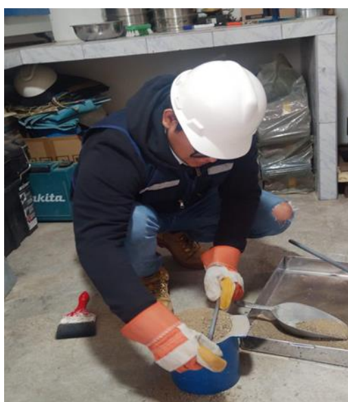
Fotografía 32: Por último, se enraza el recipiente para eliminar el material excedente.
