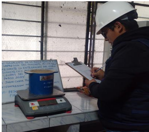
Fotografía 34: Se llevo a la balanza y se tomó nota del peso unitario compactado.
