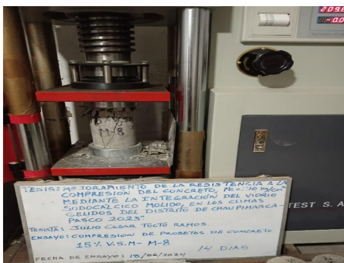
Fotografía 88: En la fotografía se observa que se realizó la rotura de las probetas tipo patrón a los 14 días de edad con el 15% de vidrio sodocálcico molido en reemplazo del agregado fino
