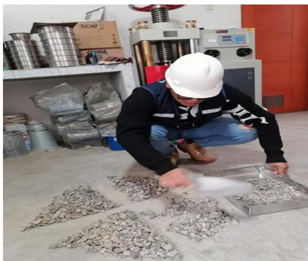
Fotografía 46: Se saca una muestra del agregado grueso y se realiza el cuarteo.
