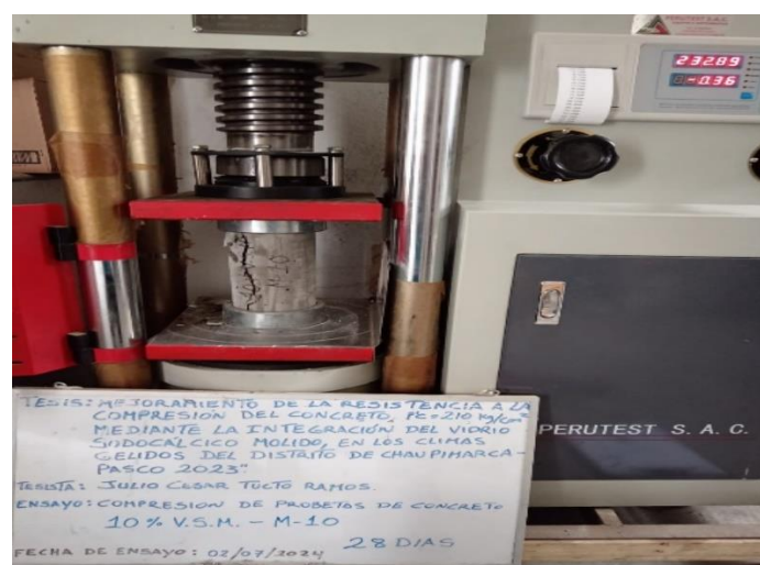
Fotografía 92: En la fotografía se observa que se realizó la rotura de las probetas tipo patrón a los 28 días de edad con el 10% de vidrio sodocálcico molido en reemplazo del agregado fino.
