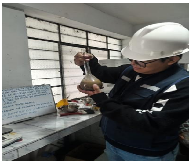
Fotografía 43: Se realizó movimientos giratorios por aproximadamente 30 minutos con la finalidad que expulse las burbujas de aire atrapado.
