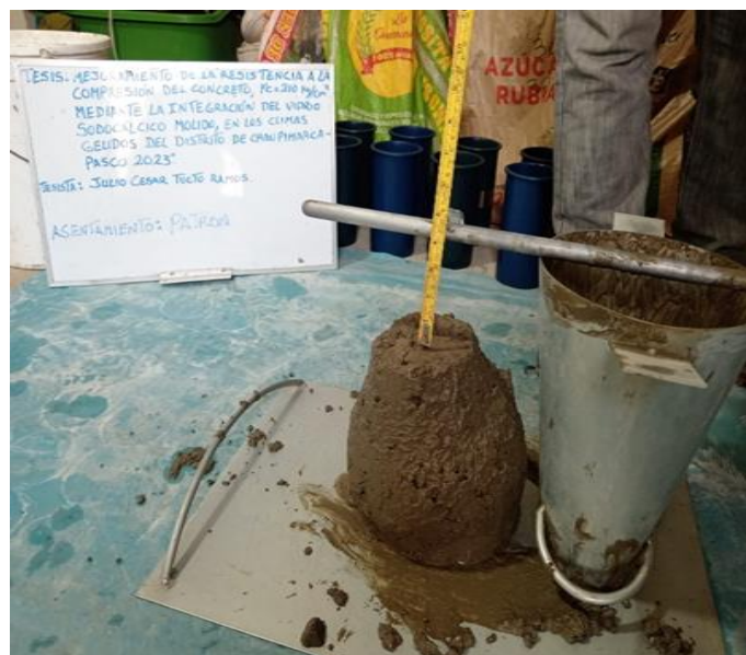
Fotografía 71: Se realizo su prueba de SLUMP para la mezcla tipo patrón.
