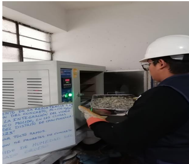
Fotografía 48: Se llevo el agregado al horno para calcular su contenido de humedad, por 24 horas a una temperatura de 110^{\circ}\text{C} \pm 5^{\circ}\text{C} .
