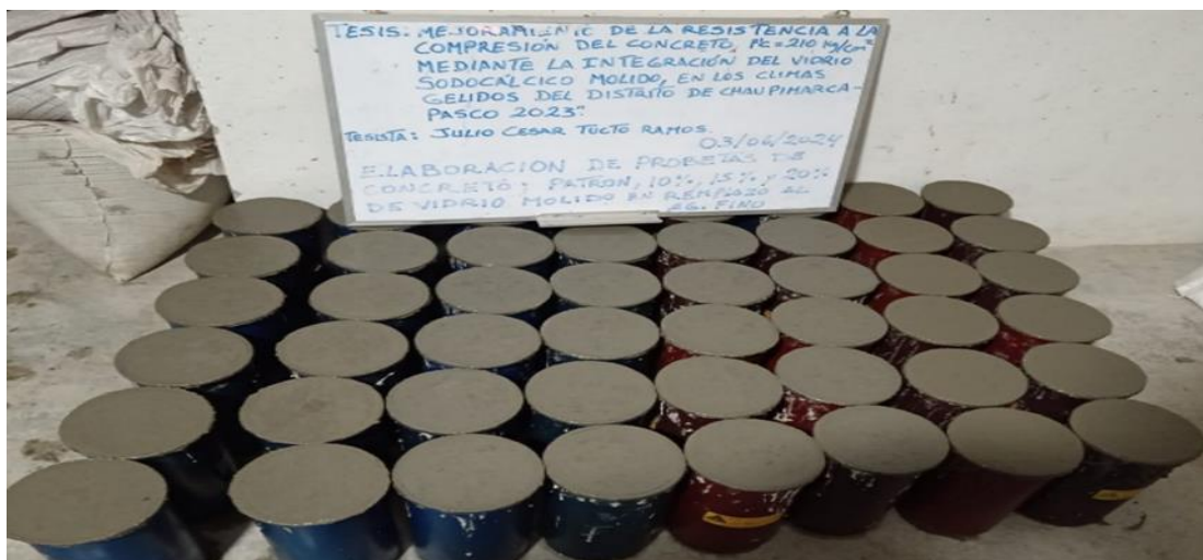
Fotografía 73: Para finalizar se enraza y con la ayuda de una espátula se pasó por la parte superior para obtener una superficie lisa y se rotuló a los costados de los moldes, la Norma utilizada ASTM C31.
