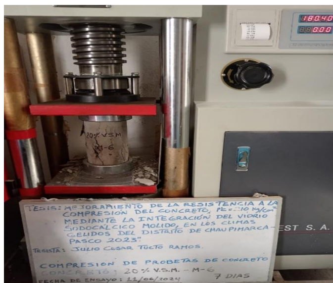
Fotografía 84: En la fotografía se observa que se realizó la rotura de las probetas tipo patrón a los 7 días de edad con el 20% de vidrio sodocálcico molido en reemplazo del agregado fino
