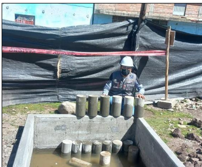
Curado de probetas de concreto
