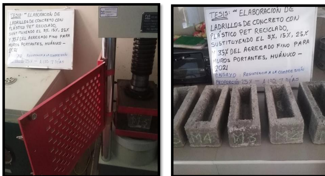
Fotografía 12. Resistencia a la compresión del 25% a los 7 días
