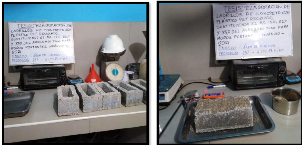
Fotografía 23. Porcentaje de Vacíos de ladrillos con 25% de plástico PET
