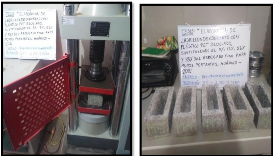
Fotografía 10. Resistencia a la compresión del 5% a los 7 días
