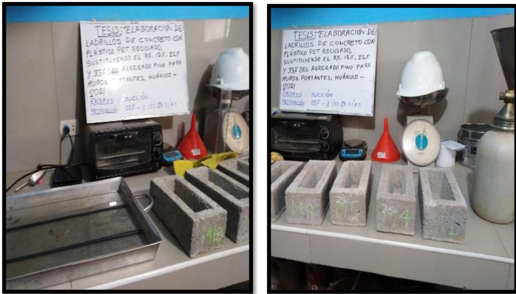
Fotografía 27. Ensayo de succión de ladrillos con 5% de plástico PET
