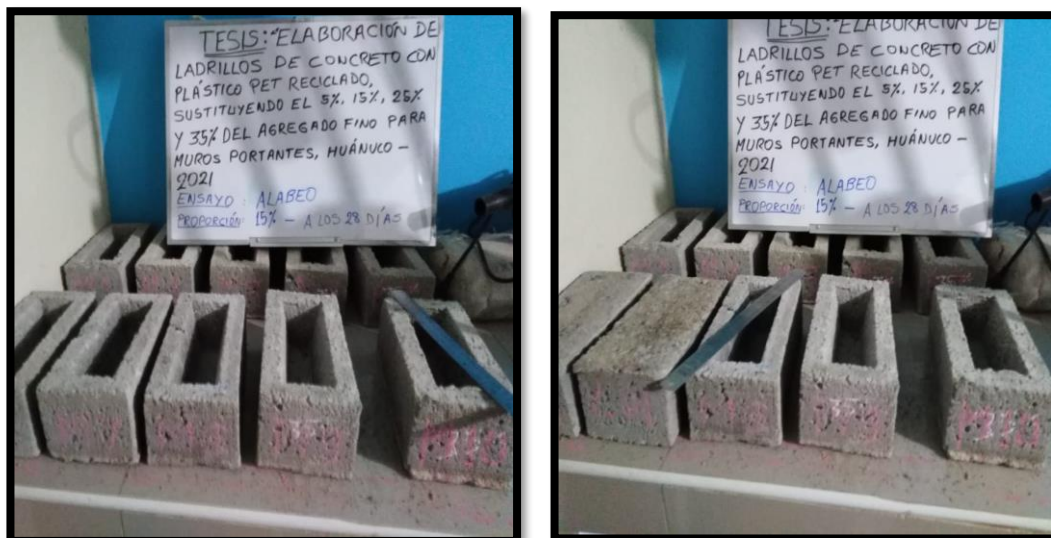
Fotografía 26. Ensayo de Alabeo de ladrillos con 15% de plástico PET
