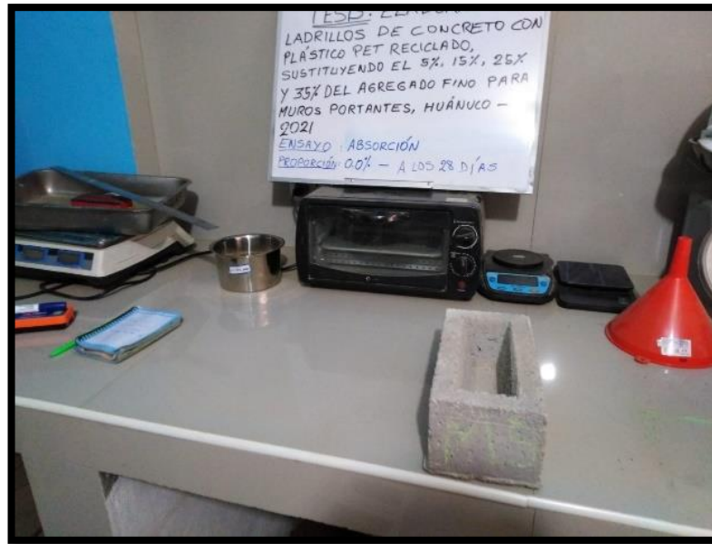
Fotografía 29. Ensayo de absorción de ladrillos con 0% de plástico PET
