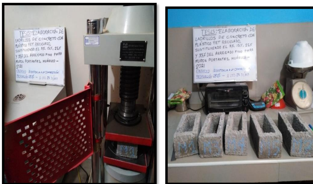
Fotografía 37. Resistencia a la compresión del 25% a los 28 días
