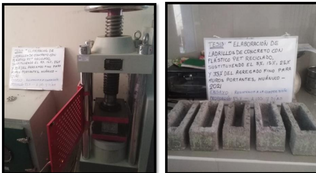
Fotografía 11. Resistencia a la compresión del 15% a los 7 días
