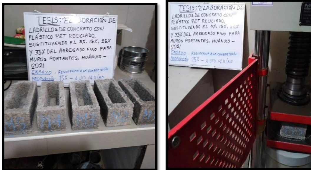
Fotografía 16. Resistencia a la compresión del 15% a los 14 días
