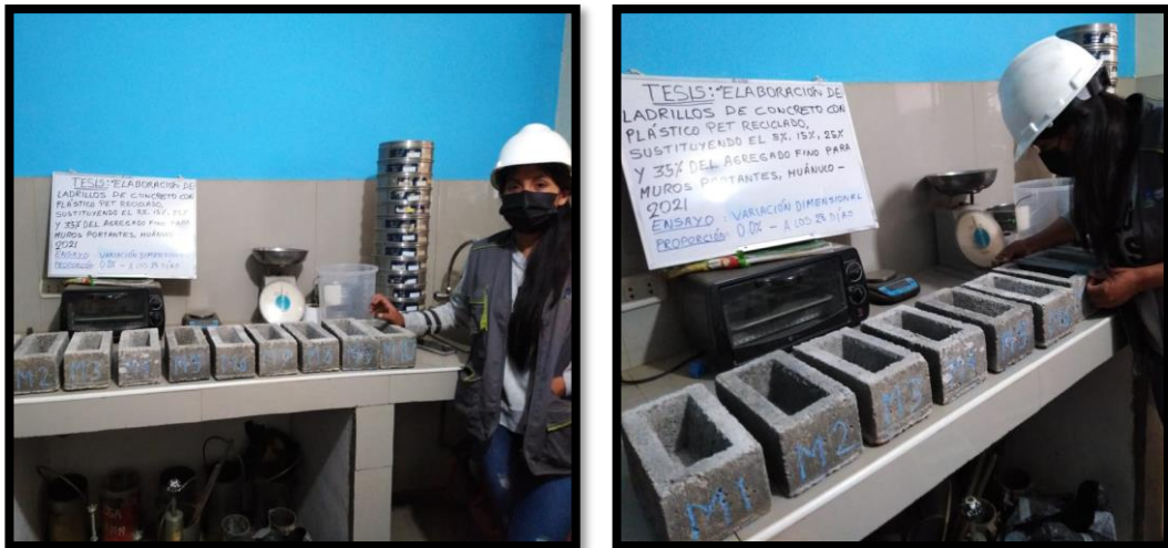
Fotografía 19. Variación Dimensional de ladrillos con 0% de plástico PET
