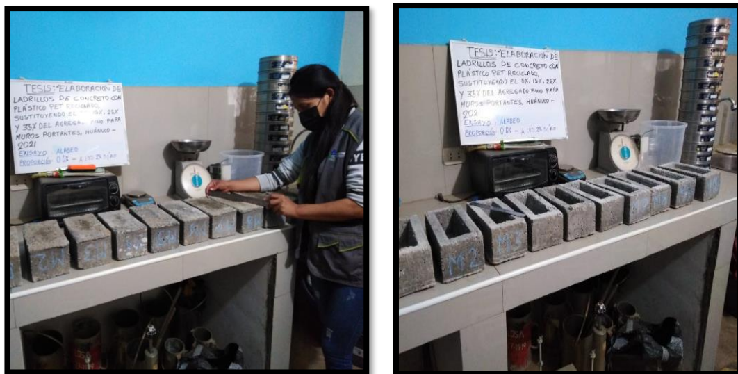
Fotografía 24. Ensayo de Alabeo de ladrillos con 0% de plástico PET
