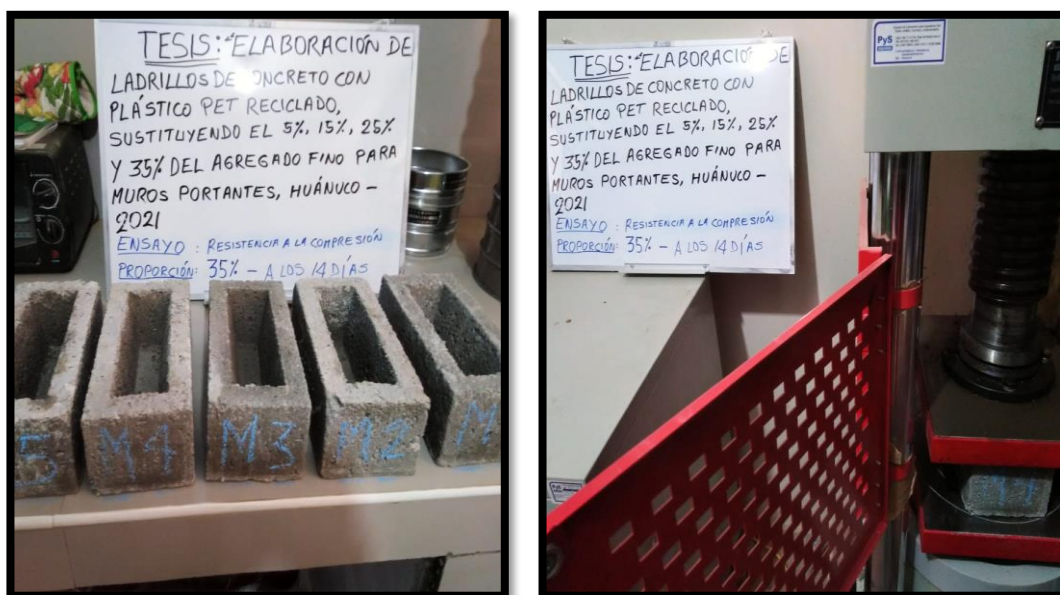
Fotografía 18. Resistencia a la compresión del 35% a los 14 días
