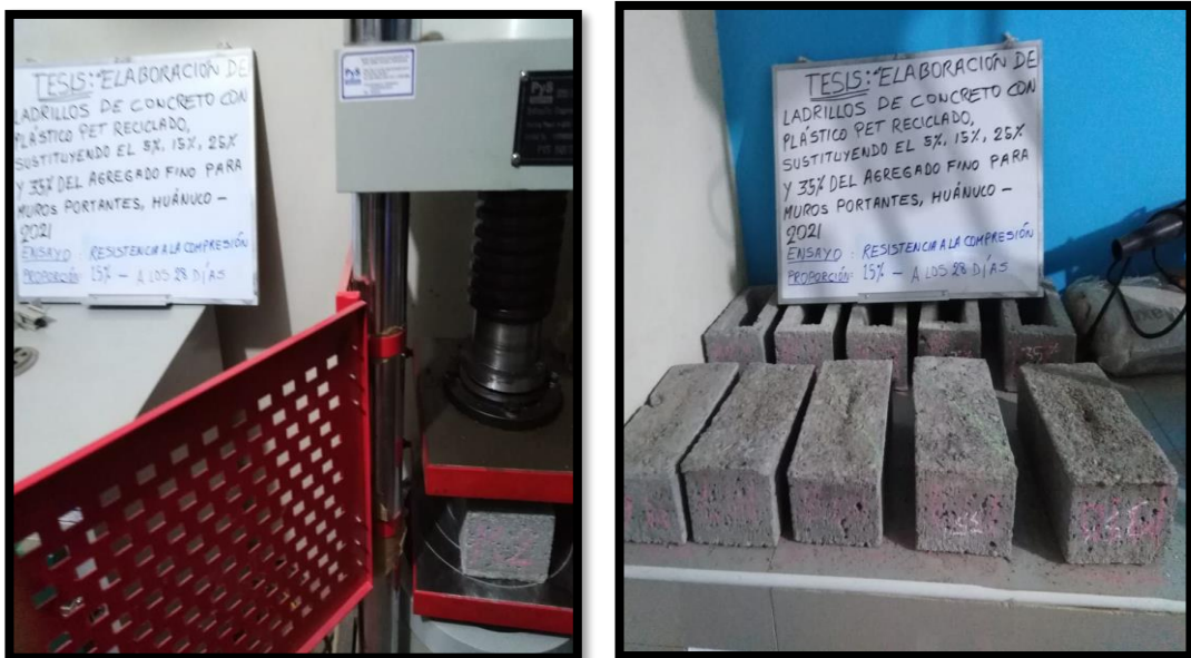
Fotografía 36. Resistencia a la compresión del 15% a los 28 días
