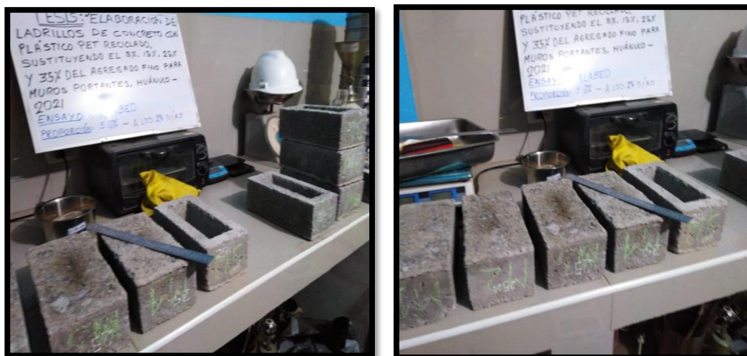
Fotografía 25. Ensayo de Alabeo de ladrillos con 5% de plástico PET
