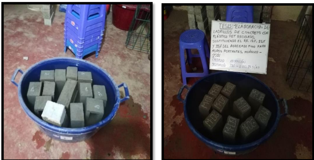
Fotografía 32. Absorción de los ladrillos
