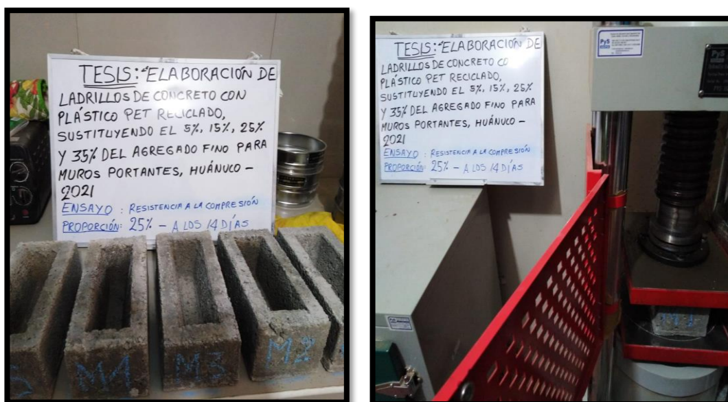
Fotografía 17. Resistencia a la compresión del 25% a los 14 días
