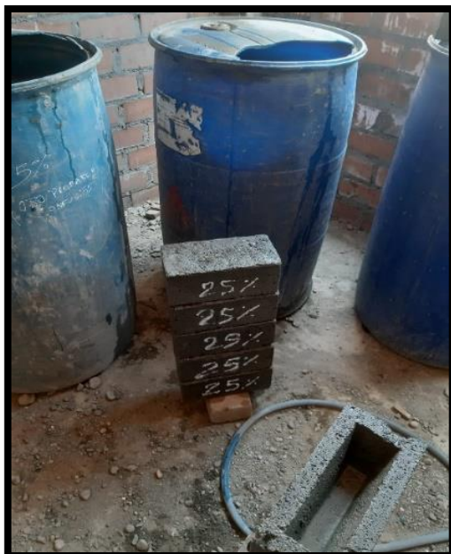
Fotografía 8. Curado de los ladrillos
