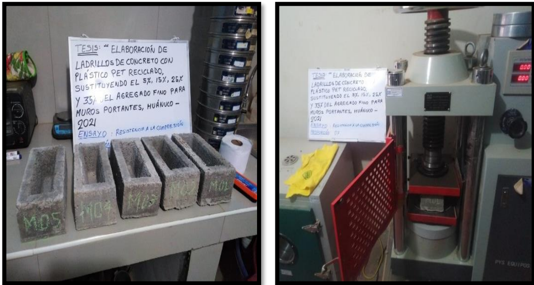
Fotografía 9. Resistencia a la compresión del 0% a los 7 días
