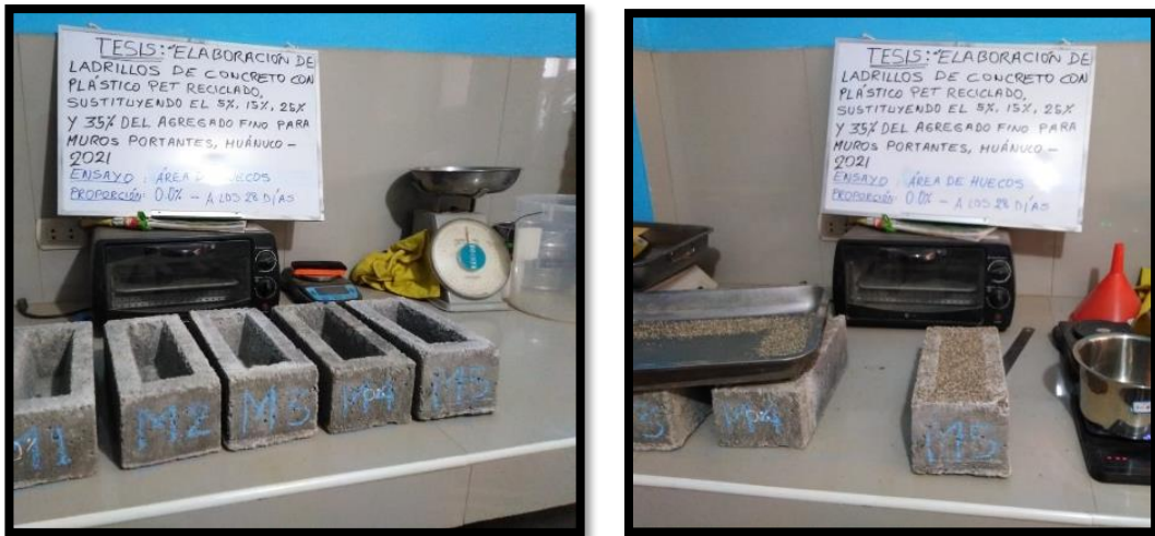
Fotografía 21. Porcentaje de Vacíos de ladrillos con 0% de plástico PET
