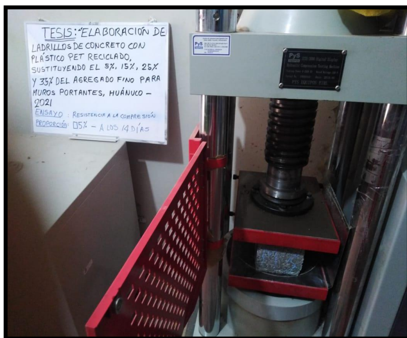
Fotografía 15. Resistencia a la compresión del 5% a los 14 días
