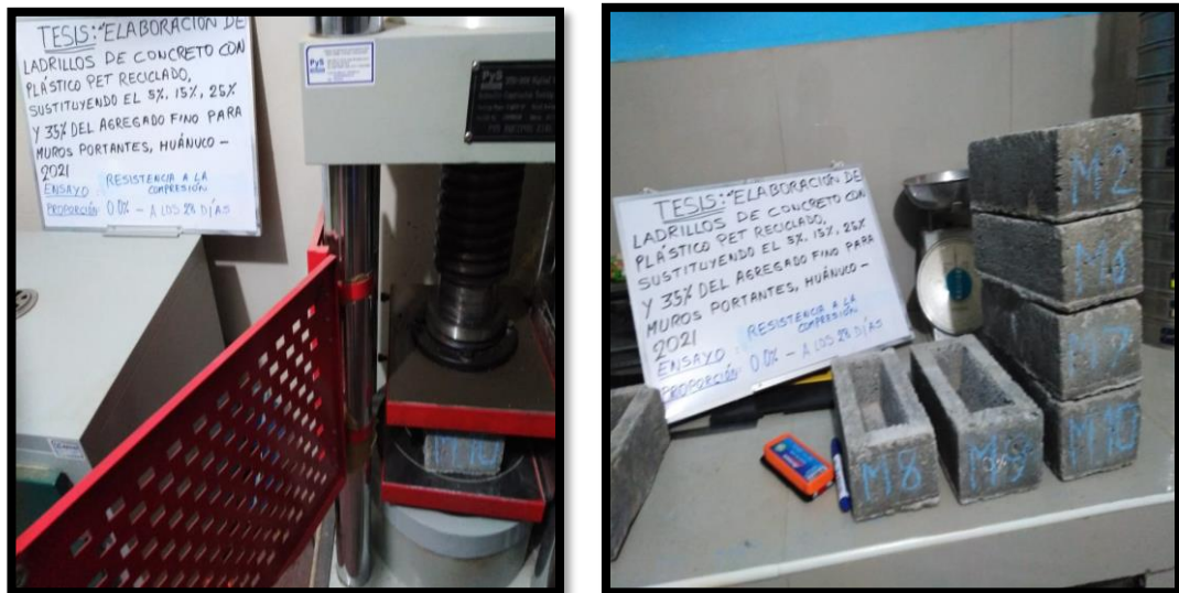
Fotografía 34. Resistencia a la compresión del 0% a los 28 días
