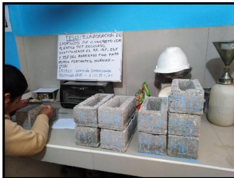
Fotografía 20. Variación Dimensional de ladrillos con 25% de plástico PET
