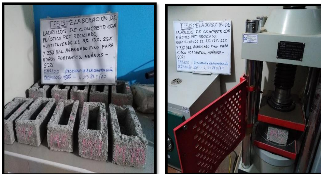
Fotografía 38. Resistencia a la compresión del 35% a los 28 días
