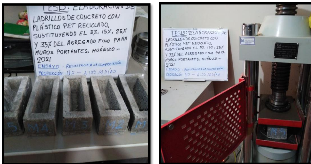
Fotografía 14. Resistencia a la compresión del 0% a los 14 días
