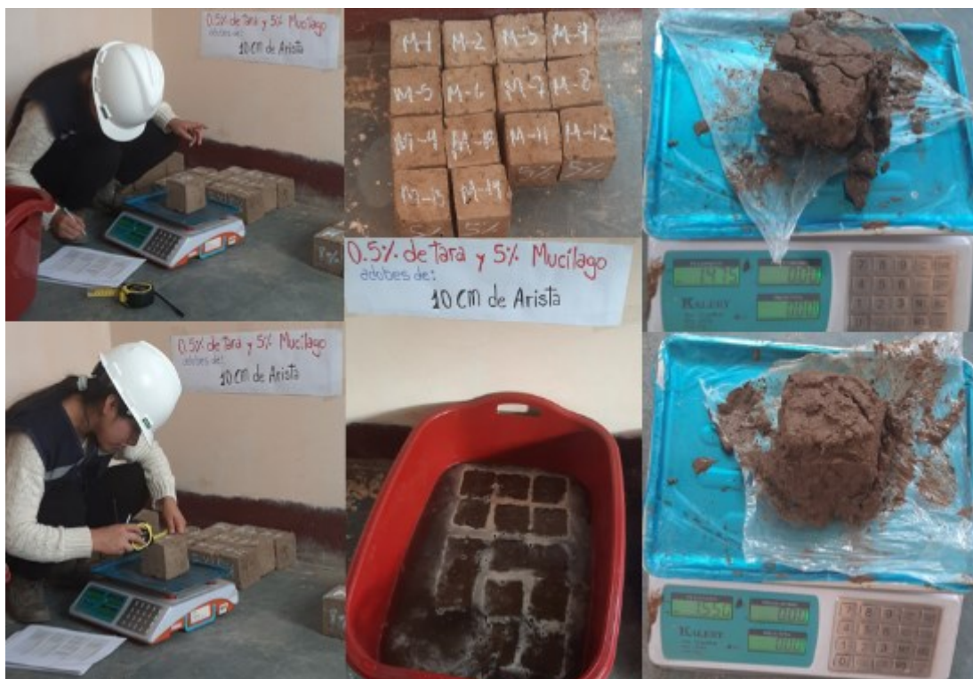
Prueba de absorción del adobe de 10 cm de arista con 5% de Mucílago y 0.5% de Tara.
