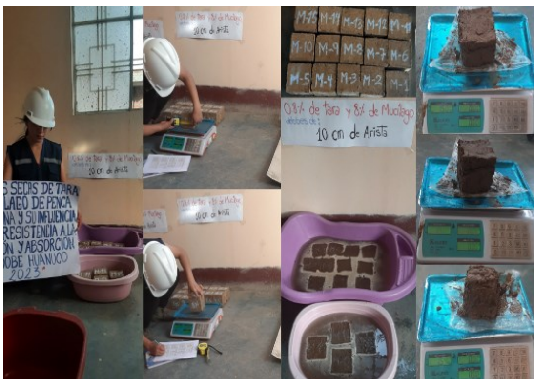
Prueba de absorción del adobe de 10 cm de arista con 8% de Mucílago y 0.8% de Tara.
