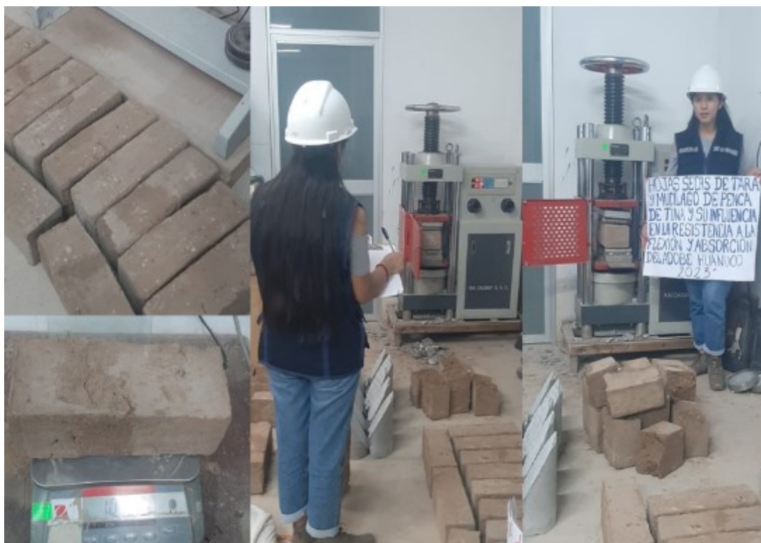
Ensayo a Flexión del adobe patrón de 6x6x18 pulgadas.
