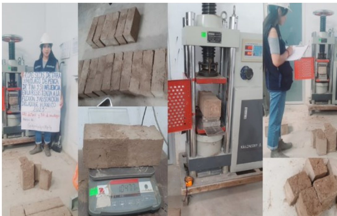
Ensayo a Flexión del adobe de 6x6x18 pulgadas con 8% de Mucílago y 0.8% de Tara.
