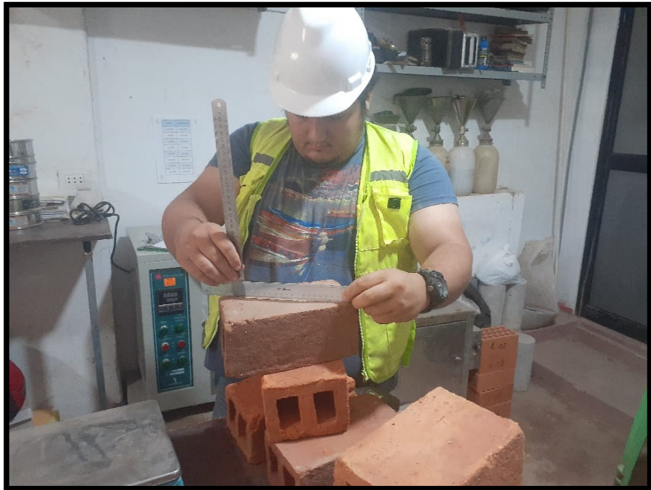
En la imagen se muestra en el laboratorio realizando la prueba de alabeo
