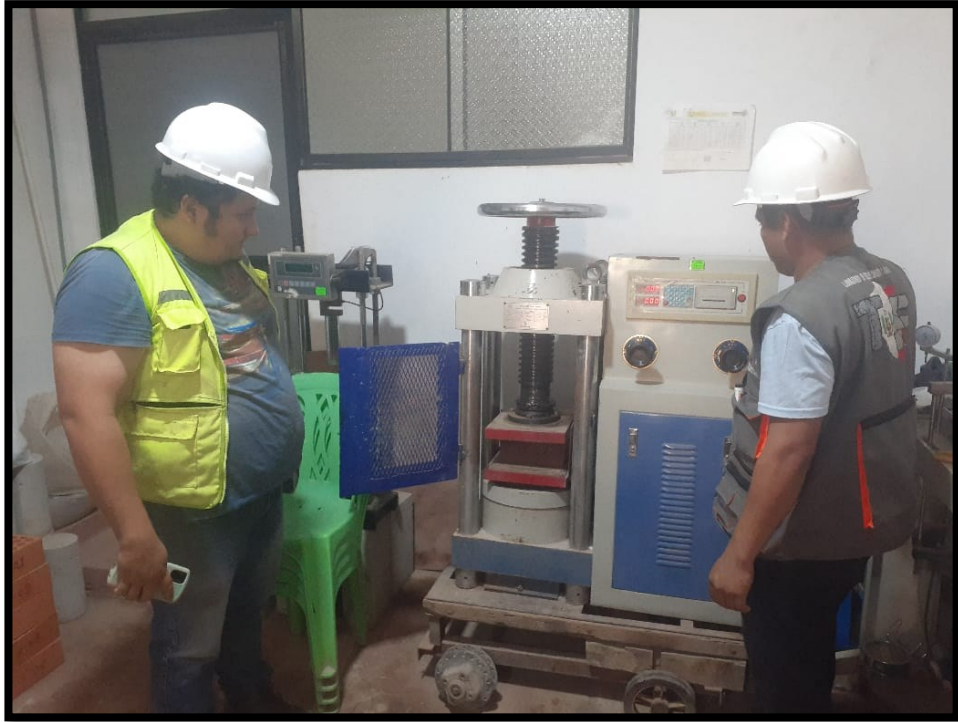
En la imagen se muestra en el laboratorio realizando la prueba de compresión.
