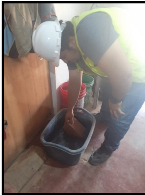
En la imagen se muestra en el laboratorio realizando la prueba de alabeo
