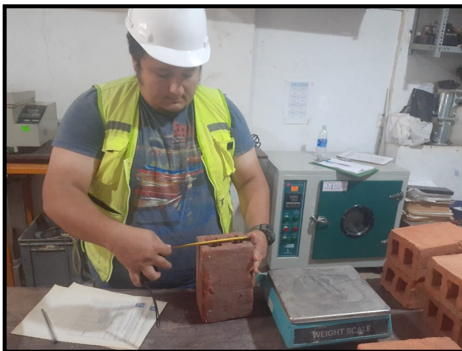
En la imagen se muestra en el laboratorio realizando la medición de las muestras.
