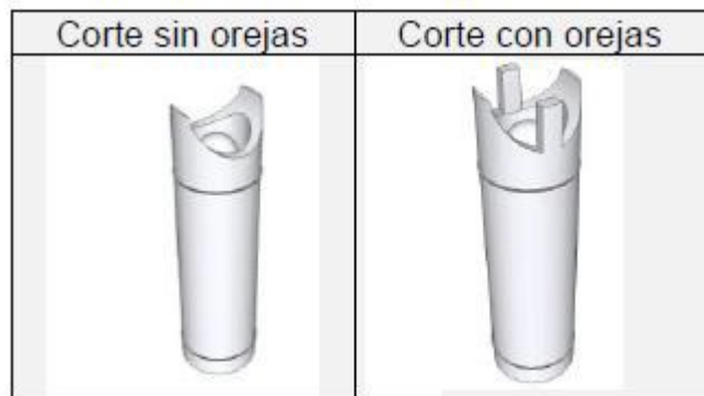
Figura 13 Corte boca de pescado
