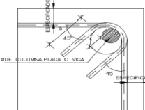
DETALLE DE DOBLADO DE ESTRIBOS EN COLUMNAS Y VIGAS
