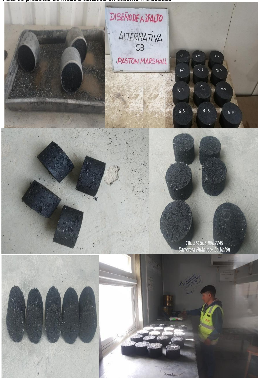
Fotografía 18 Vista de probetas de mezcla asfáltica en caliente moldeadas
