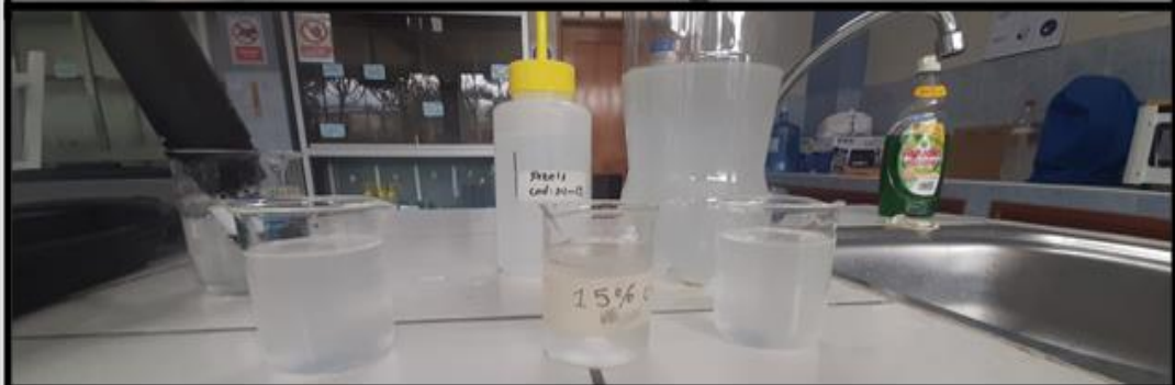
Biofiltro purificado con C.A. al 5%, 10% y al 15%
