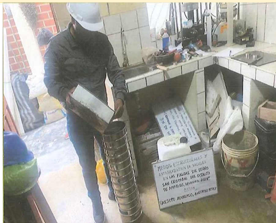
Vista fotográfica del ensayo de análisis granulométrico por tamizado – cerro San Cristóbal - San Luis -sector 04 - Amarilis
