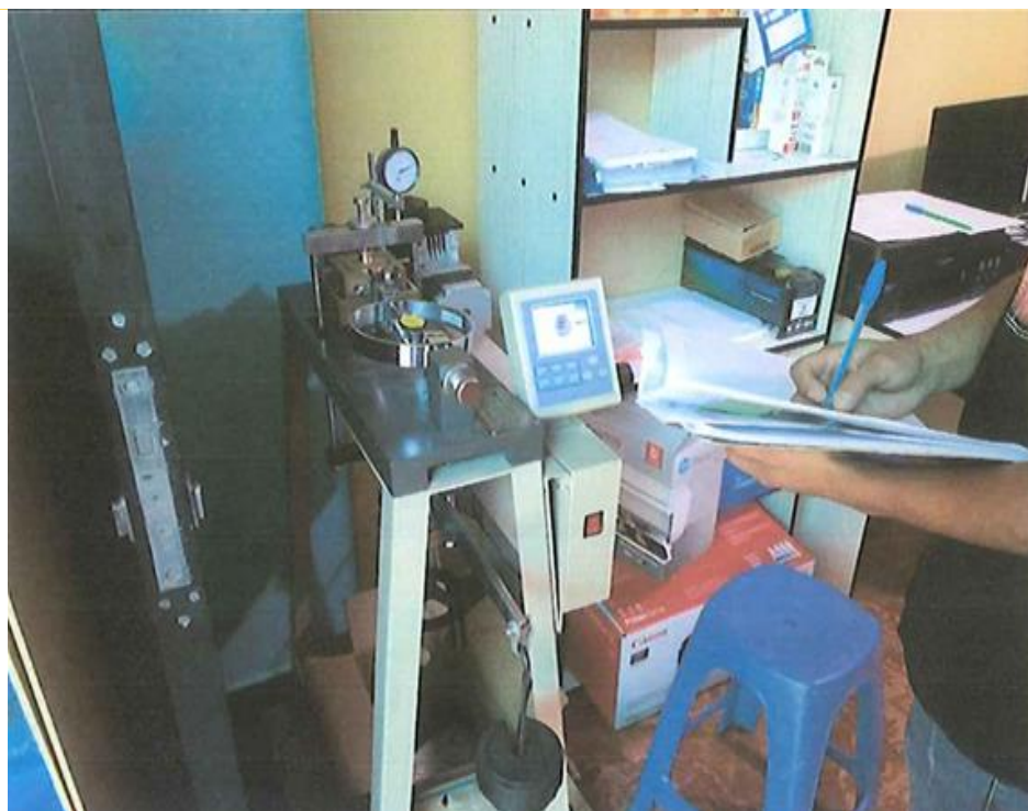
Vista fotográfica del ensayo de corte directo – cerro San Cristóbal - San Luis -sector 04 - Amarilis
