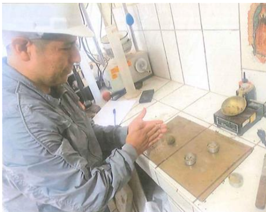
Vista fotográfica del ensayo de limite plástico, para determinar el % del índice de plasticidad ( I_p ) – cerro San Cristóbal - San Luis -sector 04 - Amarilis
