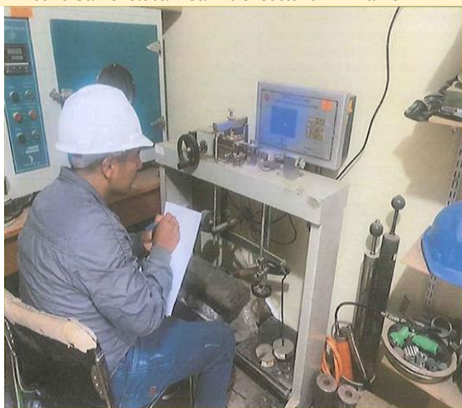
Vista fotográfica del ensayo de corte directo – cerro San Cristóbal - San Luis -sector 04 - Amarilis
