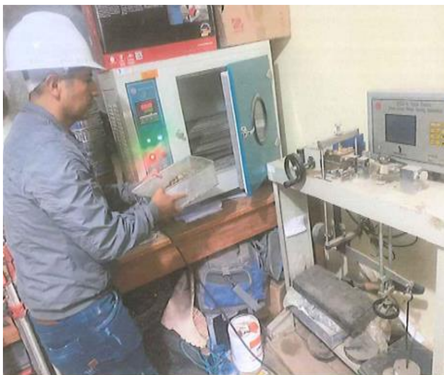
Vista fotográfica del ensayo para determinar el % del contenido de humedad - horno eléctrico – cerro San Cristóbal - San Luis -sector 04 - Amarilis
