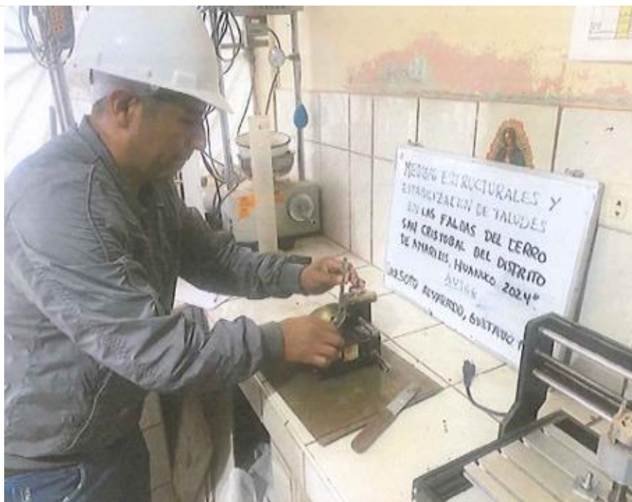
Vista fotográfica del ensayo de limite plástico, para determinar el % del índice de plasticidad ( I_p ) – cerro San Cristóbal - San Luis -sector 04 - Amarilis
