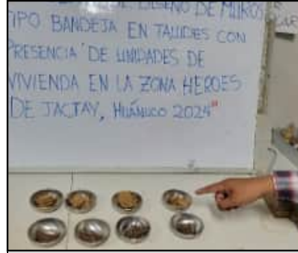
Muestras ensayadas de Limite plastico
