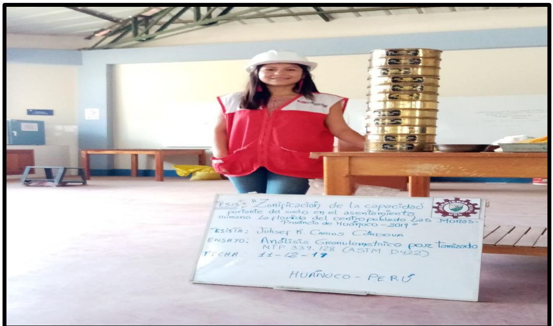
Ensayos de Granulometría en el Laboratorio de Suelos, se observa el juego de tamices para el estudio del Asentamiento Humano La Florida, en el centro poblado de Las Moras, Distrito y Provincia de Huánuco.
