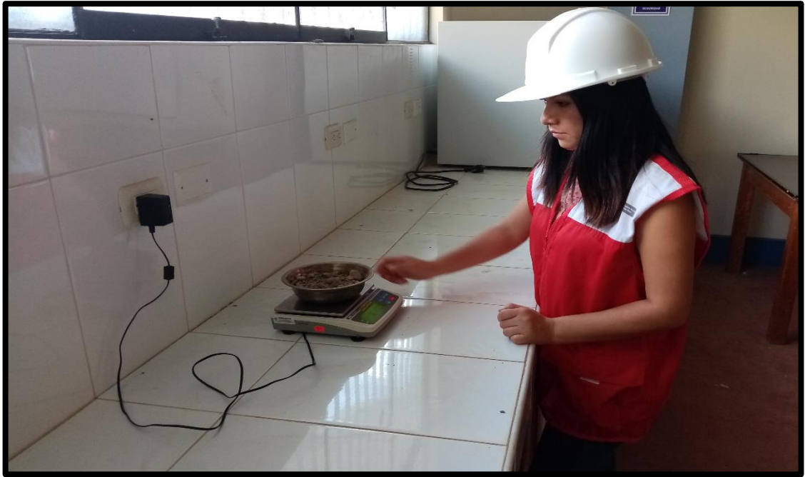
Ensayos de Granulometría en el Laboratorio de Suelos, se observa el pesado de las muestras de suelos en las taras en seco para el estudio del Asentamiento Humano La Florida, en el centro poblado de Las Moras, Distrito y Provincia de Huánuco.
