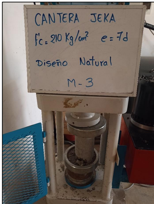
Rotura de probetas a los 7 días. Sin aditivo.
