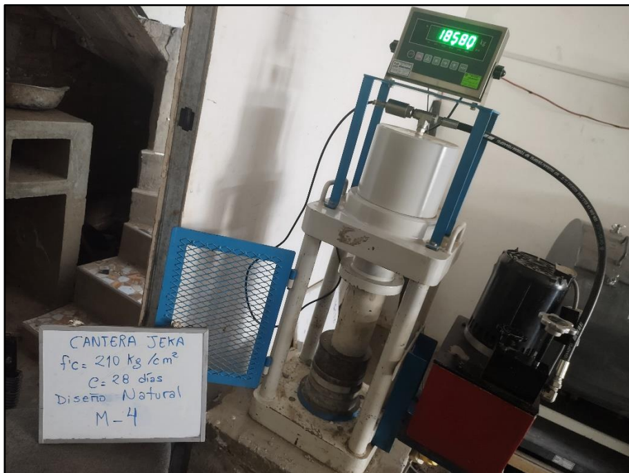
Rotura de probetas a los 28 días. Sin aditivo.
