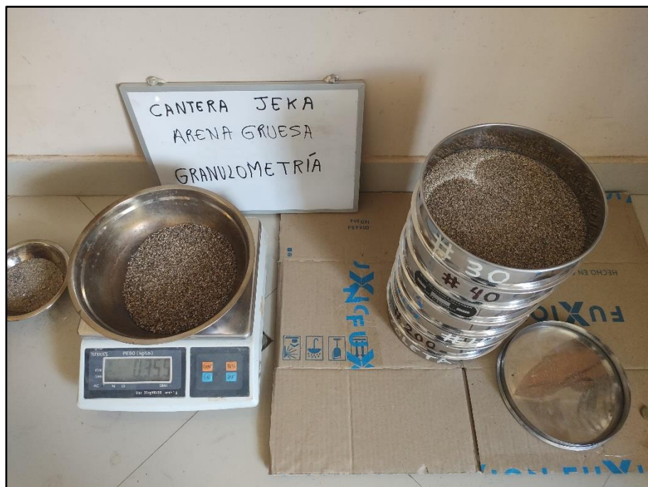
Ensayos de granulometría.
