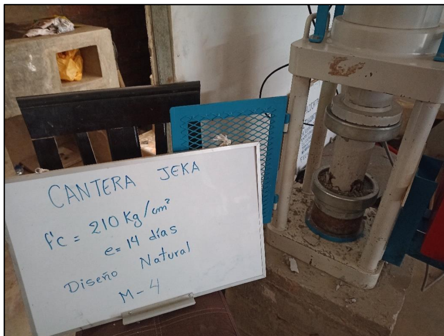
Rotura de probetas a los 14 días. Sin aditivo.
