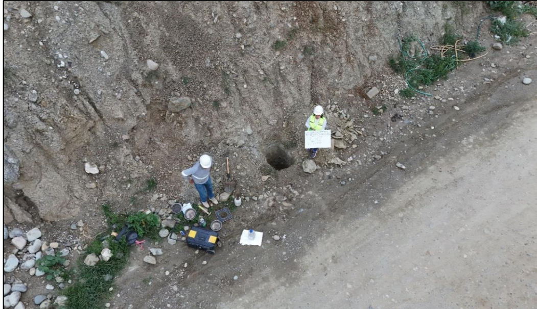
Imagen capturada mediante dron que proporciona una perspectiva vertical de la ubicación y dimensiones de la calicata, contextualizada dentro del perfil del talud evaluado.
