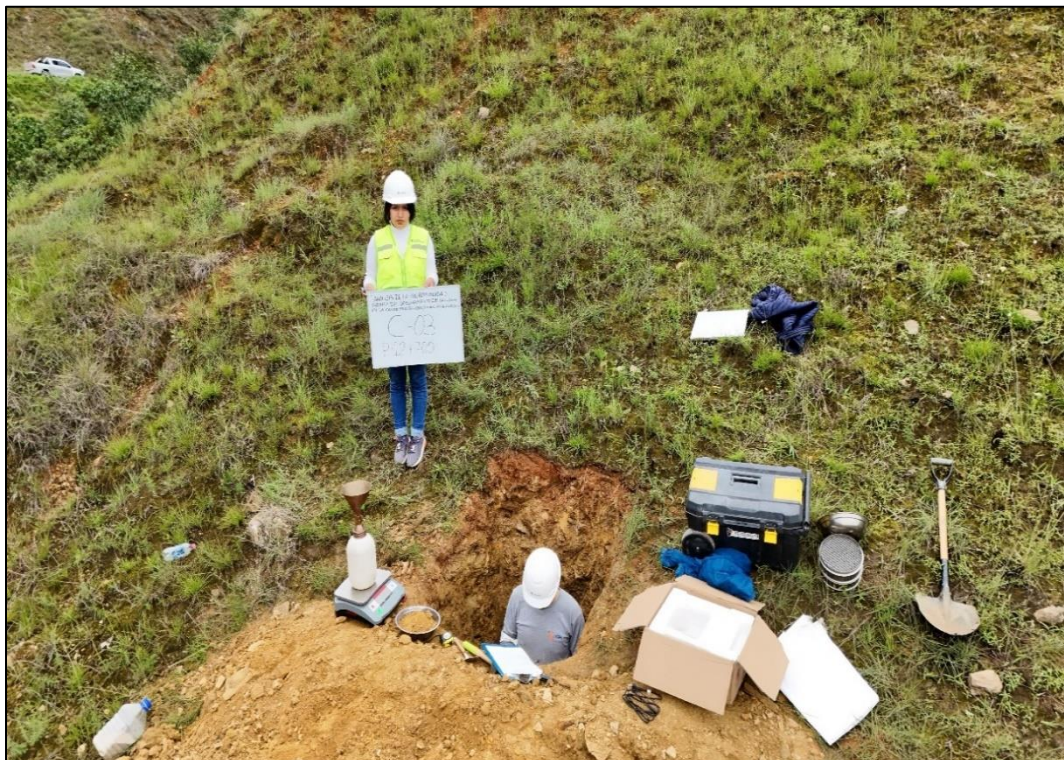
Documentación visual del procedimiento de determinación de densidad seca natural mediante el método del cono de arena. Se aprecia la precisión del equipo técnico en campo.
