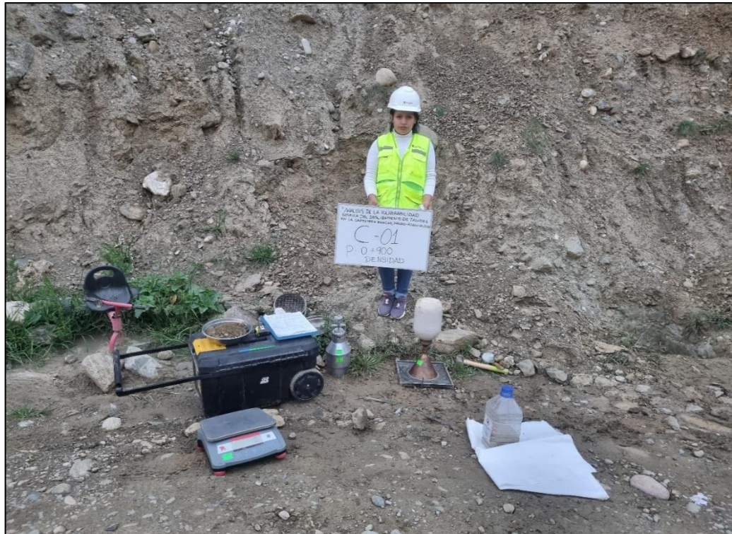
Registro fotográfico del ensayo de densidad in situ con el método del cono de arena en la base de la calicata, utilizado para determinar la densidad seca del suelo natural.
