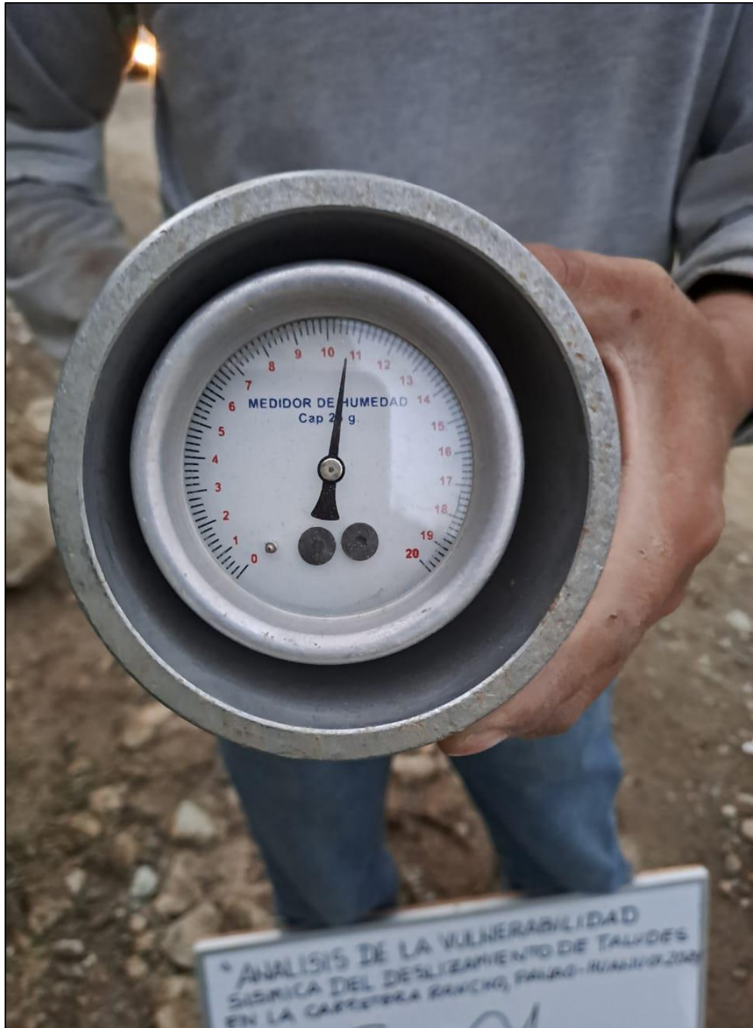
Medida de Humedad de la Calicata N°01 con el SPEEDY Ensayo de humedad natural realizado con el equipo Speedy Tester, que permite obtener rápidamente el porcentaje de humedad del suelo en campo.
