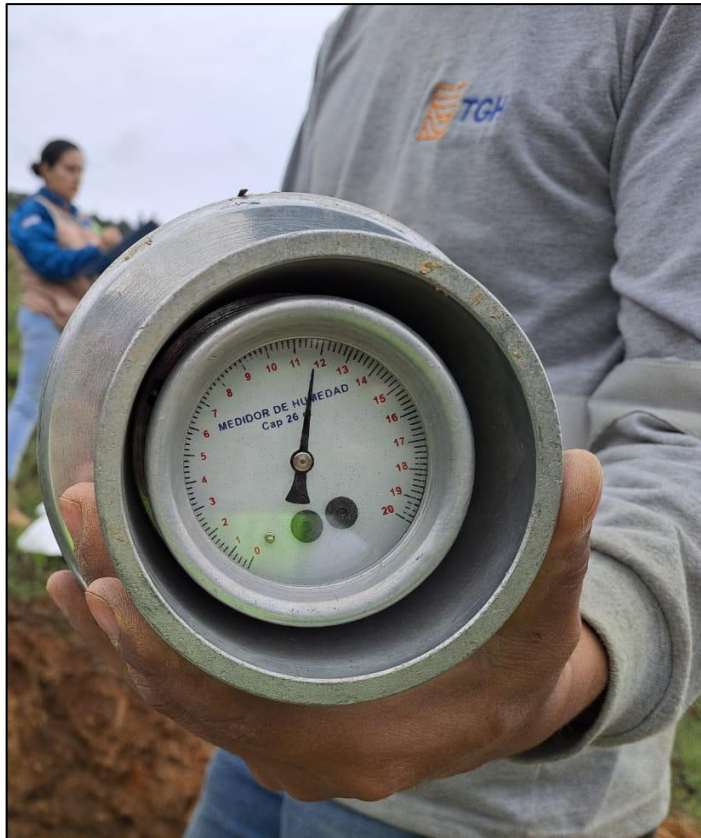
Medida de Humedad de la Calicata N°03 con el SPEEDY Ensayo de humedad natural realizado con el equipo Speedy Tester, que permite obtener rápidamente el porcentaje de humedad del suelo en campo
