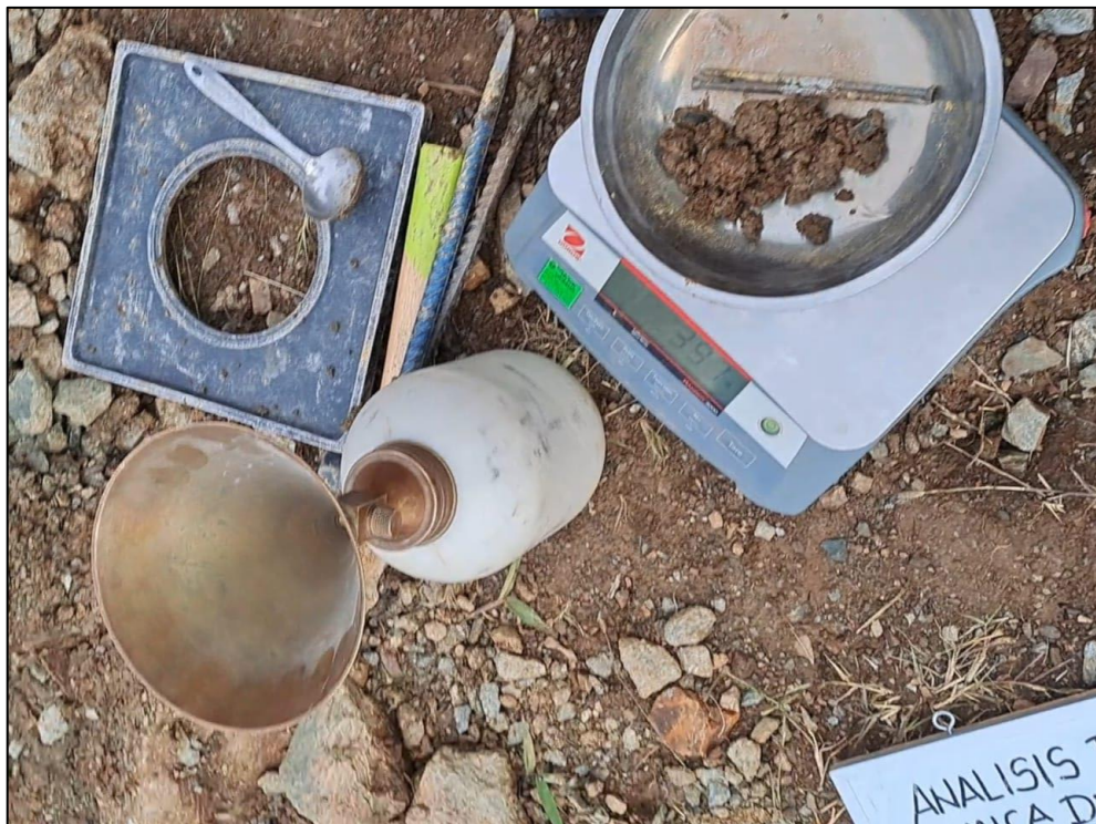
Captura del procedimiento de evaluación de densidad con el método del cono de arena con los instrumentos de laboratorio.
