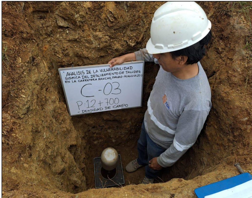
Documentación visual del procedimiento de determinación de densidad seca natural mediante el método del cono de arena. Se aprecia la precisión del equipo técnico en campo.
