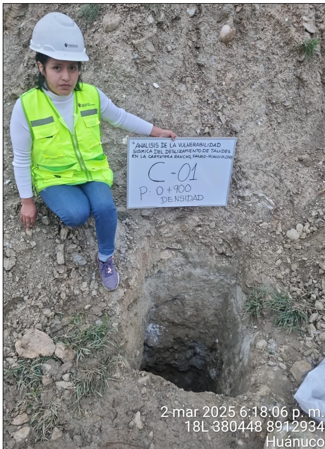
Registro fotográfico del ensayo de densidad in situ con el método del cono de arena en la base de la calicata, utilizado para determinar la densidad seca del suelo natural.
