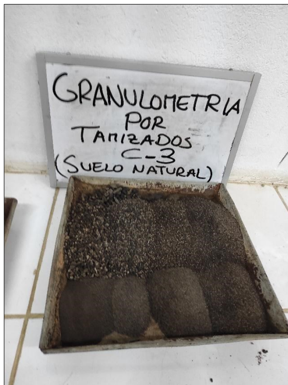
Fotografía 7 Se evidencia la categorización de la muestra a través de la evaluación granulométrica realizada en la calicata número 3
