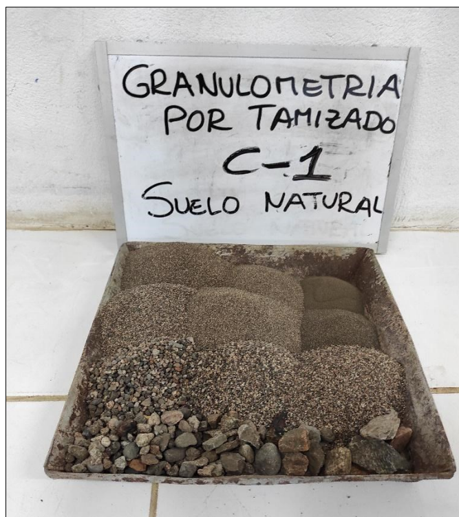
Fotografía 5 Se observa la clasificación de la muestra por el análisis granulométrico calicata N°1
