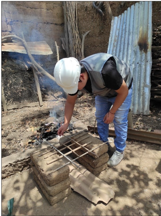
Fotografía 16 Fabricando el horno de calcinación
