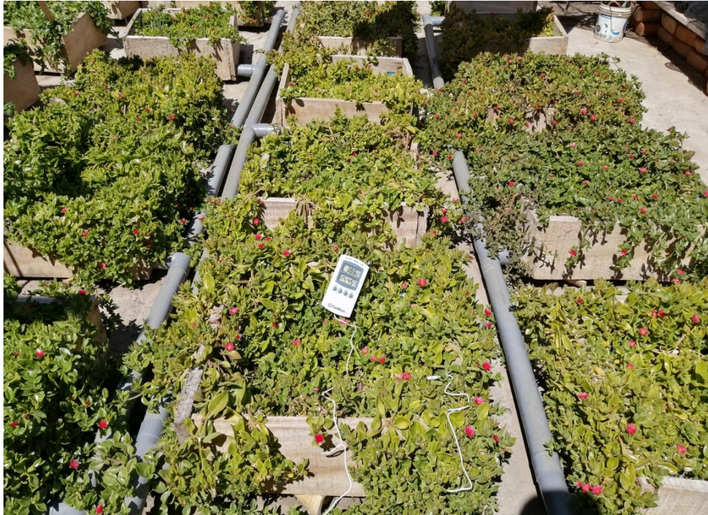
Midiendo la temperatura de la azotea del predio con techo verde
