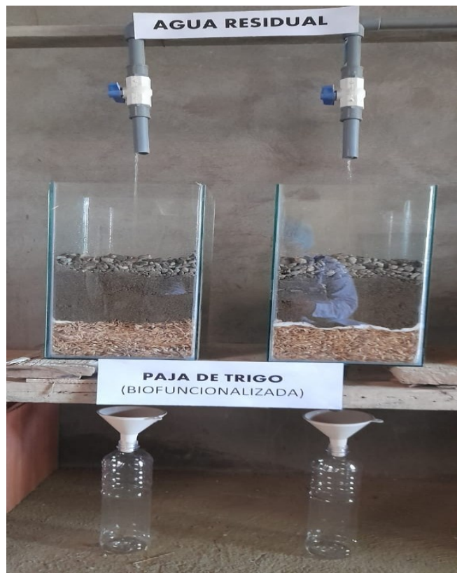
Filtración de agua residual con biomasa biofuncionalizada (paja de trigo)
