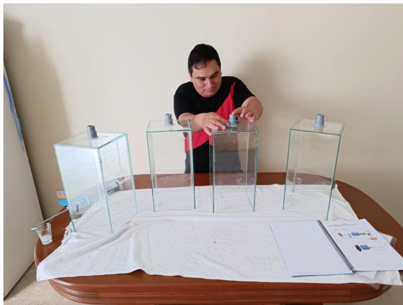
Puesta de orificio para la salida de agua tratada (material pvc)
