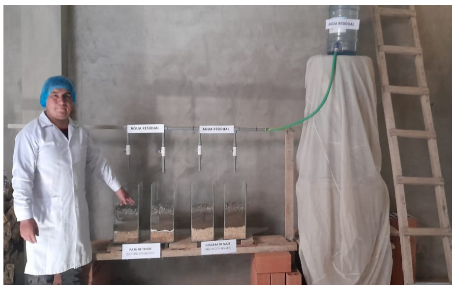
Prototipo de filtración con biomasa biofuncionalizada (cáscara de maíz y paja de trigo)
