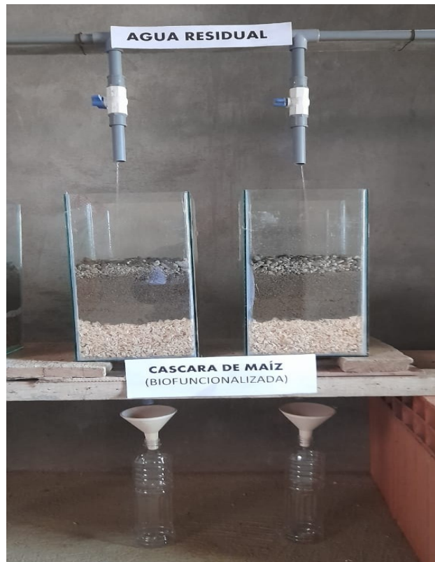
Filtración de agua residual con biomasa biofuncionalizada (cáscara de maíz)
