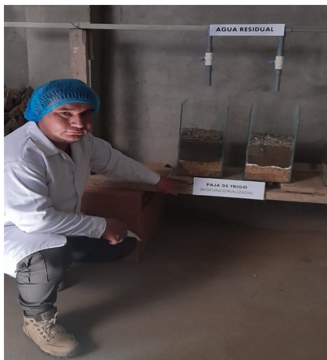
Prototipo de biomasa de paja de trigo biofuncionalizada (pre al tratamiento)
