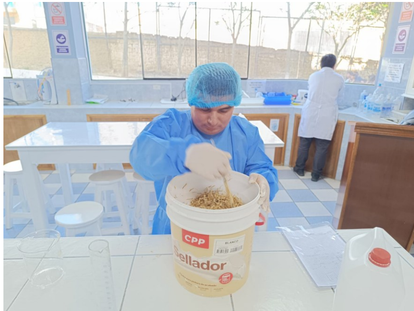
Homogenización del ácido fosfórico con la biomasa para la activación del absorbente
