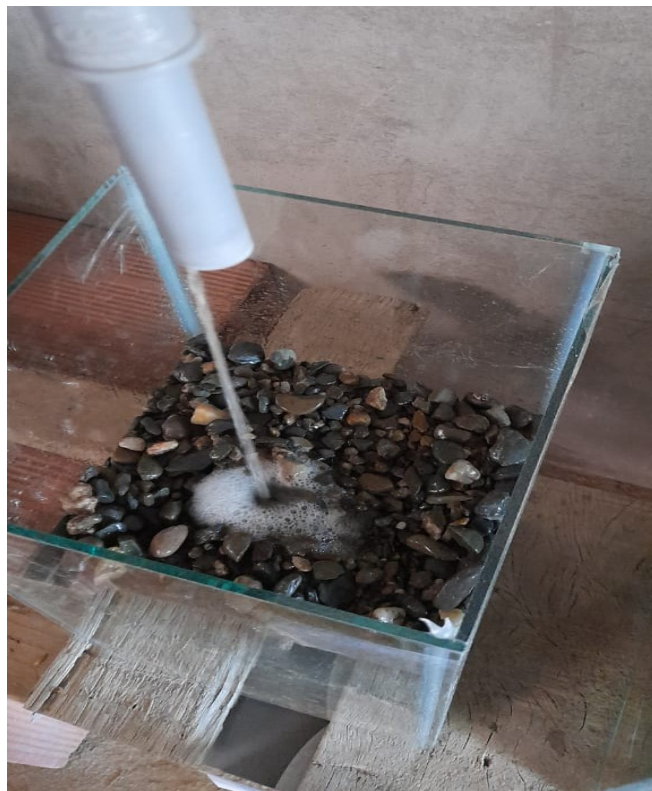
Vista del ingreso de agua residual por los conductos
