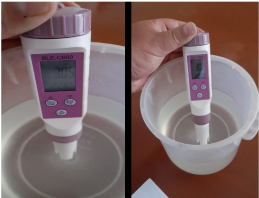
Vistas de las mediciones de parámetros de aguas residuales pre al tratamiento
