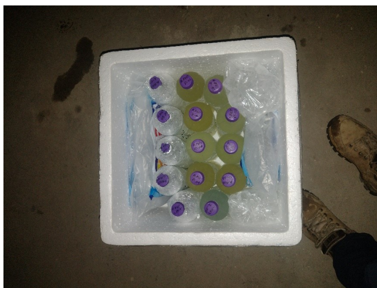
Muestras de aguas con sus respectivos envases con hielo para la conservación de sus parámetros a medir
