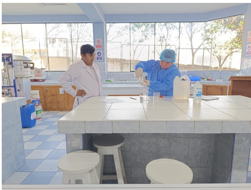
Disolución del ácido fosfórico en agua destilada
