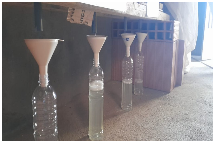
Salida de agua filtrada de prototipo de filtración con biomasa biofuncionalizada (paja de trigo y cáscara de maíz)
