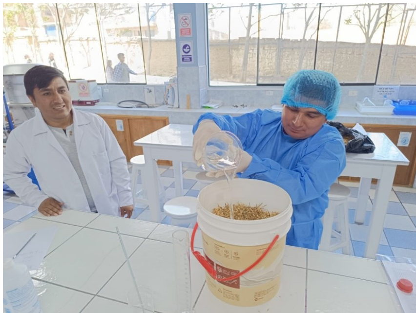
Combinación de ácido fosfórico disuelto con la biomasa triturada
