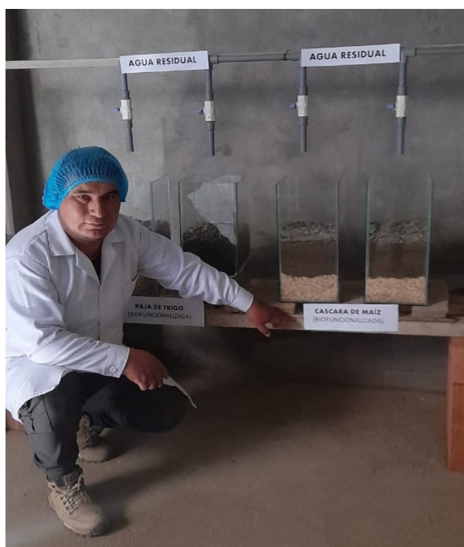
Prototipo de biomasa de cáscara de maíz biofuncionalizada (pre al tratamiento)
