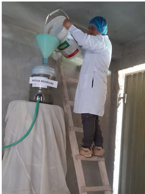
Colocación de muestras de muestra de agua residual en el contenedor de conductos para la filtración con biomasa biofuncionalizada
