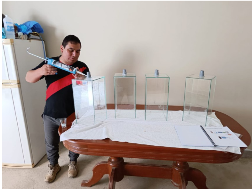
Pegado de láminas de vidrio para la puesta de la biomasa biofuncionanlizada
