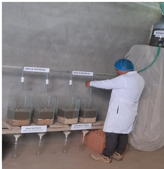
Abriendo las llaves de pase del conducto de agua residual
