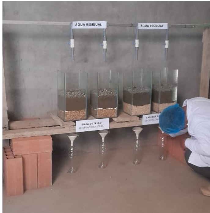
Puesta de envases recolectores para recepción de aguas tratadas con biomasa biofuncionalizada (paja de trigo y cáscara de maíz)
