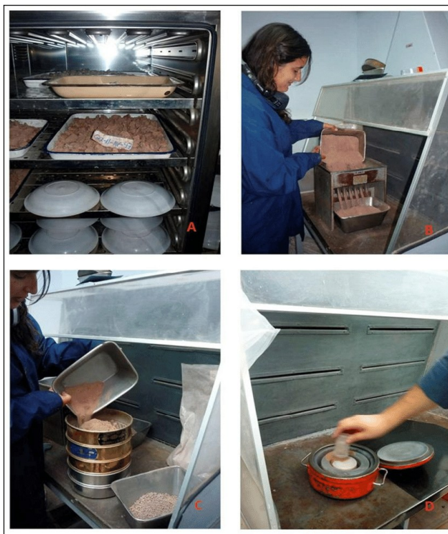
Figura 4 Proceso de secado y tritución
