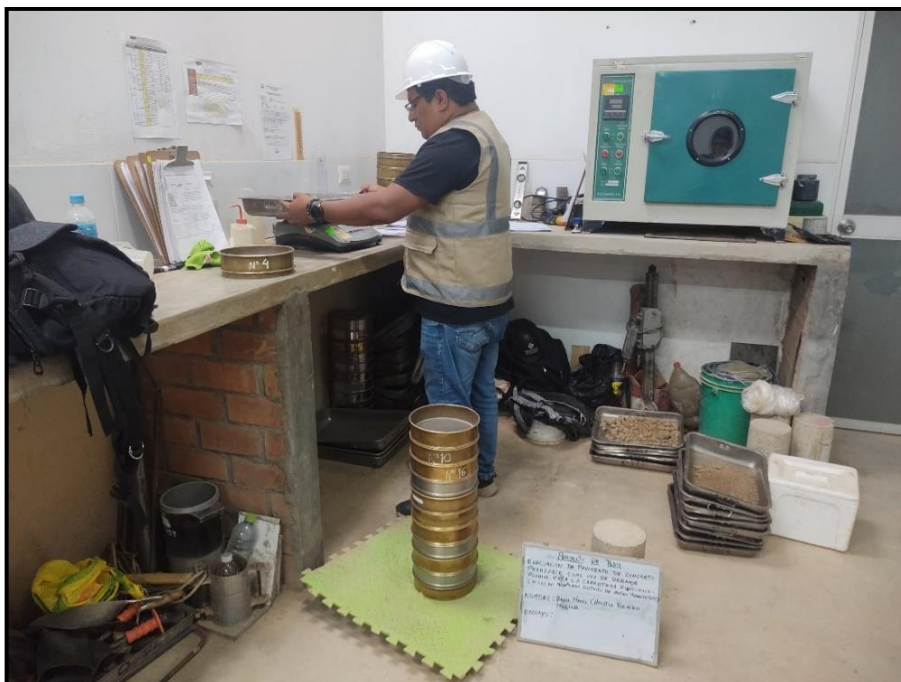
LA BALANZA, TAMICES Y LOS MATERIALES PARA LOS ENSAYOS
