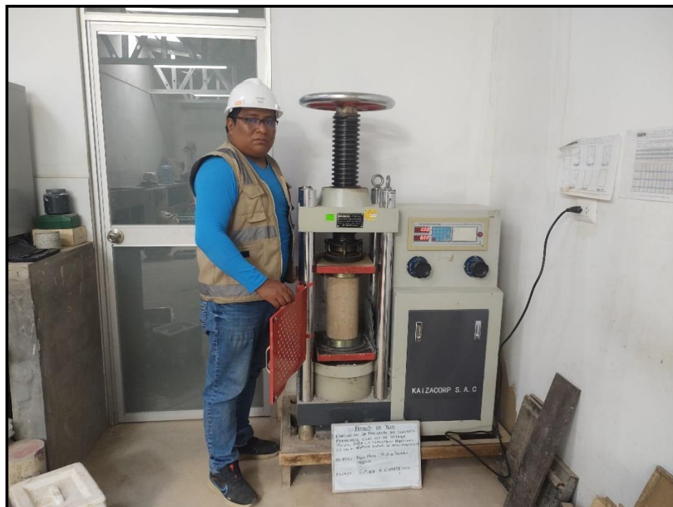
ENSAYO A COMPRESIÓN
