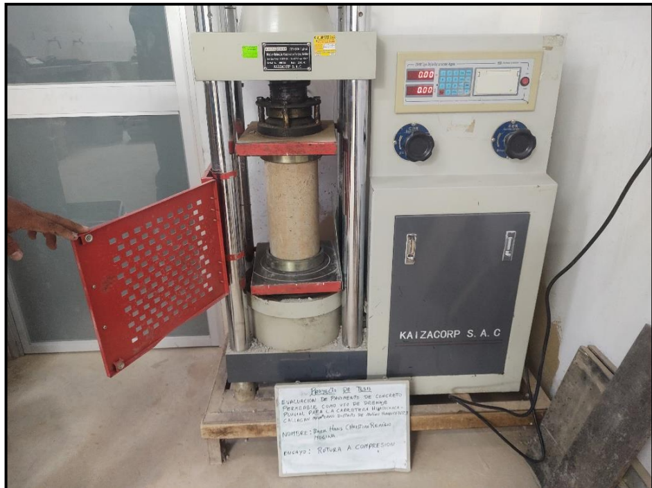
ROTURA A COMPRESIÓN
