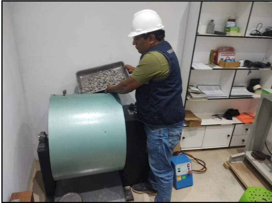
ECHANDO EL MATERIAL EN LA MÁQUINA DE LOS ÁNGELES
