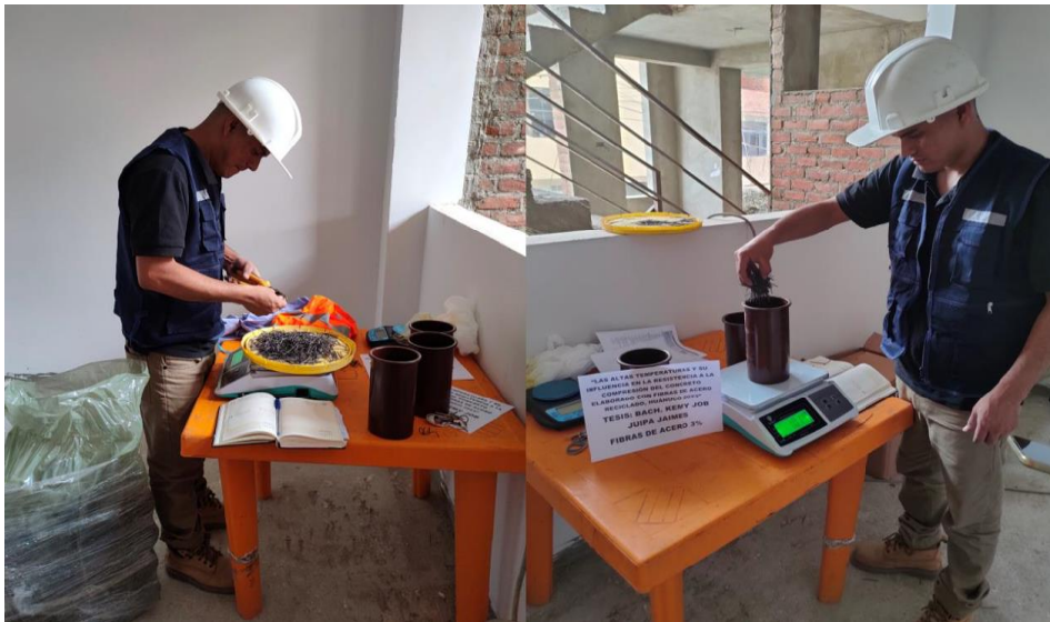
Pesaje de las fibras de acero reciclado para la elaboración de los testigos de concreto sometidos a temperaturas elevadas
