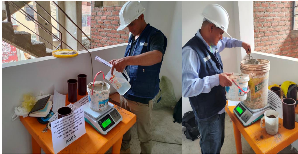
Pesaje del agua y del cemento para el diseño de mezcla del concreto f'c=210 kg/cm 2
