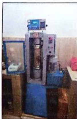
Fotografías 05 y 06: Resistencia a la Compresión del concreto en muestras cilíndricas – Vista de resultados y especímenes de concreto ensayados a Compresión.
