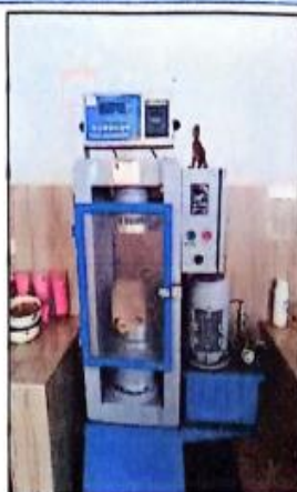
Fotografías 01 y 02: Resistencia a la Compresión del concreto en muestras cilíndricas – Vista de la Prensa de ensayo de Compresión.
