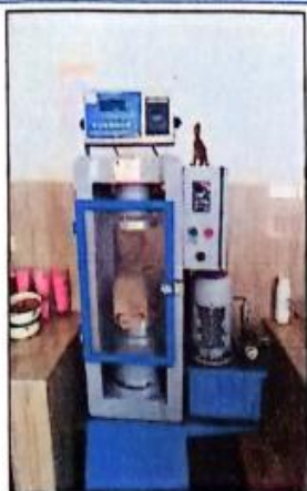
Fotografías 01 y 02: Resistencia a la Compresión del concreto en muestras cilíndricas – Vista de la Prensa de ensayo de Compresión.
