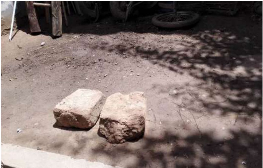
Nota. Muestra de adobe recuperado de los escombros.
